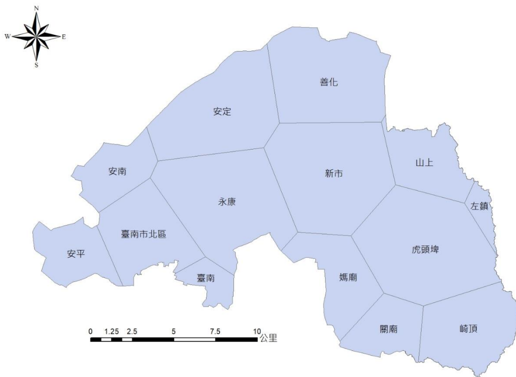
圖 4-4 鹽水河流域雨量站徐昇多邊形網
