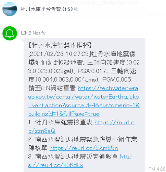
圖 2-40 東源地震儀告警測試
