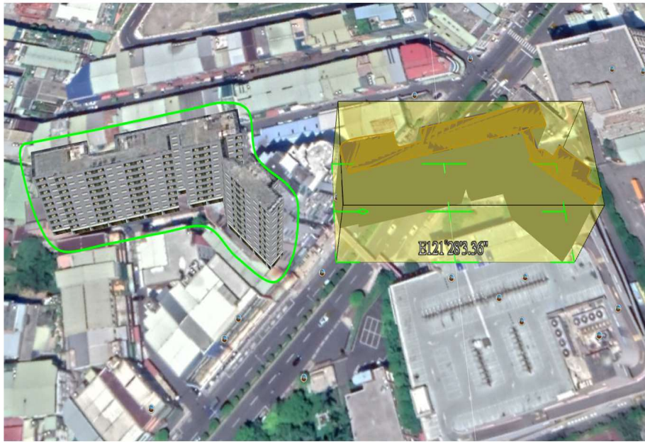
圖 29 三維近似建物模型示意圖，建物模型檔以 Google Earth 軟體開啟展示。
