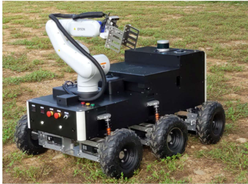
圖 71 遠端遙控行動式輻射偵測平台實體展示
