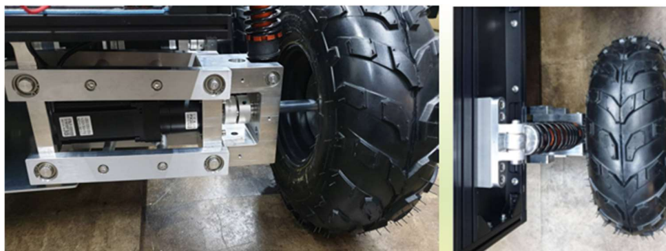
圖 67 車體懸吊與避震結構強化實體圖
