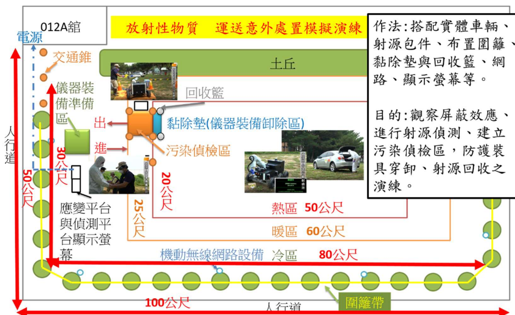
圖 6 輻射災害應變訓練研發中心戶外場地建置平面圖一
