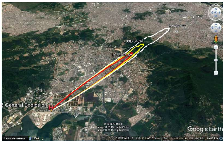
圖 19 模擬情境 I 下銫-137 有效劑量(Sv)分布圖，並疊加在 Google Earth 地圖上。
