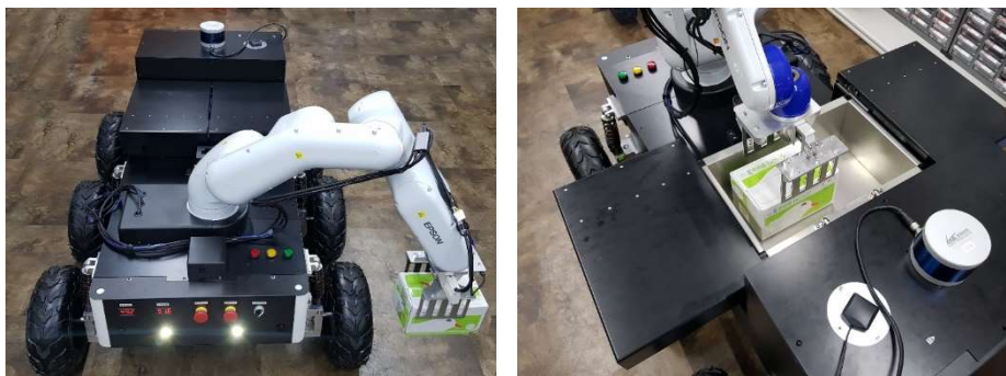
圖 65 物件夾取與收納艙放置測試展示
