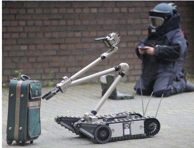
圖 57 多功能防爆機器人(I-Robot Packbot 510)
