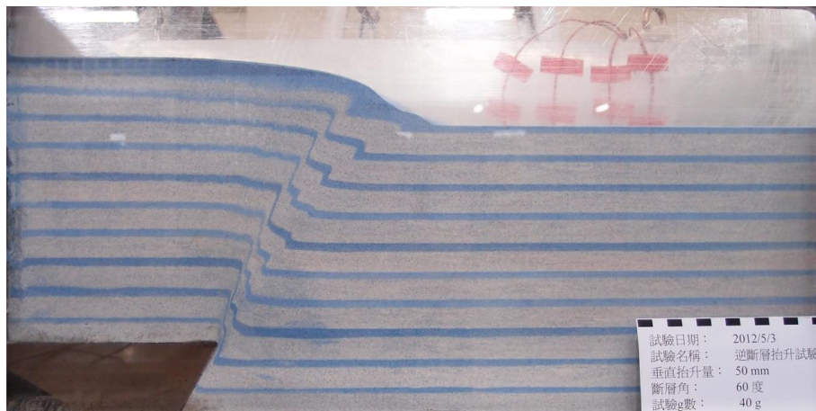
圖 3.2.10 逆斷層錯動試驗在 80g 下斷層跡發展的側視剖面
