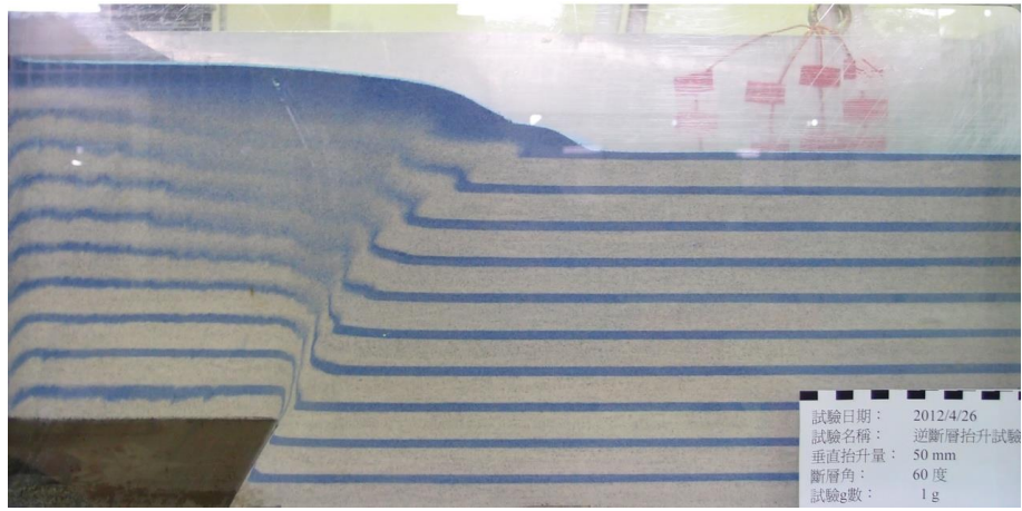
圖 3.2.11 逆斷層錯動試驗在 1g 下斷層跡發展的側視剖面
