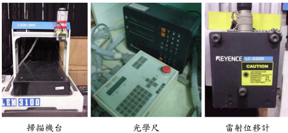
圖 3.4.4 雷射掃描測距系統
