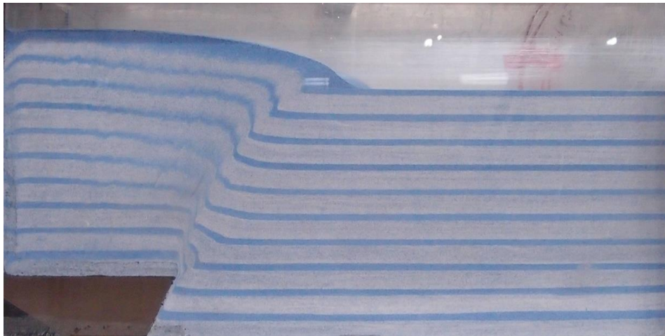
圖 3.2.9 逆斷層錯動試驗在 80g 下斷層跡發展的側視剖面
