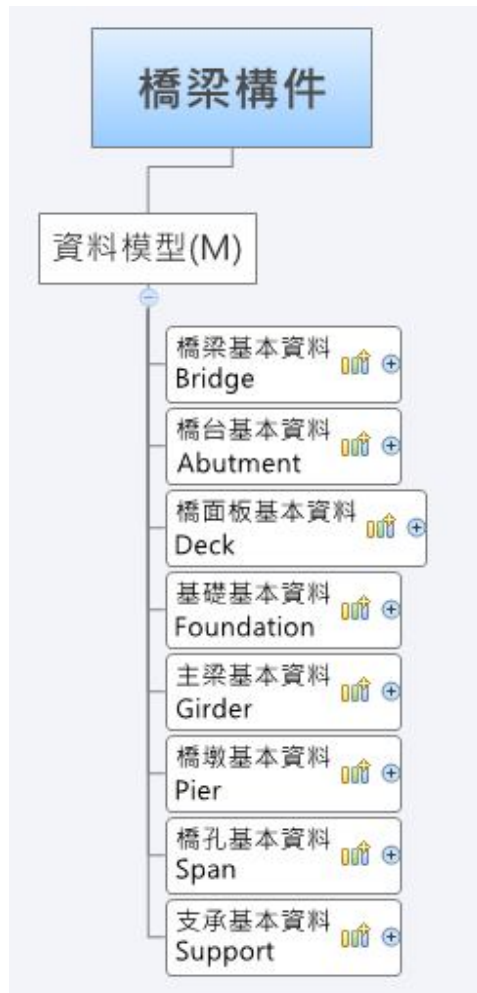
圖 4.2-12 一般 RC 橋梁構件樹資料模型架構
