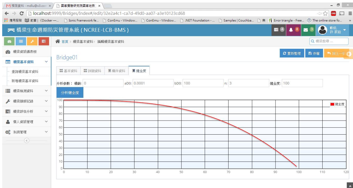
圖 5.3-1 橋梁健全度期望曲線與實際檢測評估後之對應健全度比較
