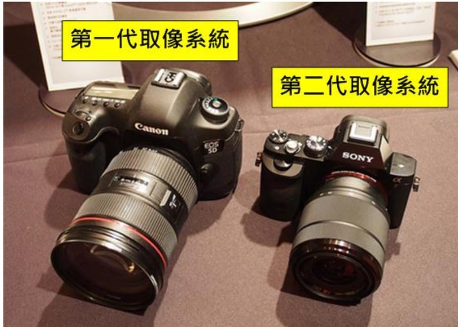
圖 2.11 第一代與第二代取像系統大小比較
