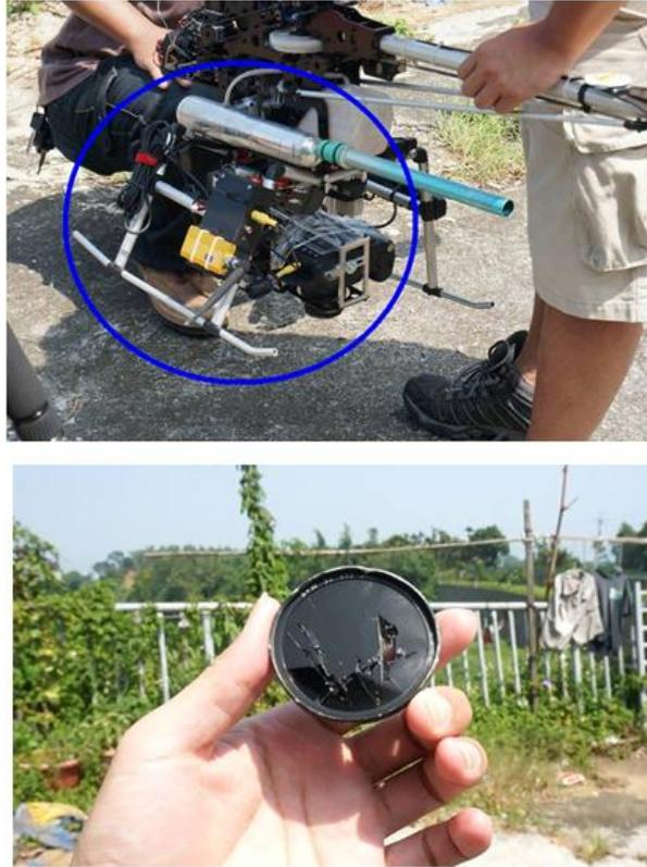
圖 2.10 第一代快速取像系統重落地損毀
