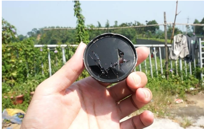
圖 10、第一代快速取像系統重落地損毀
