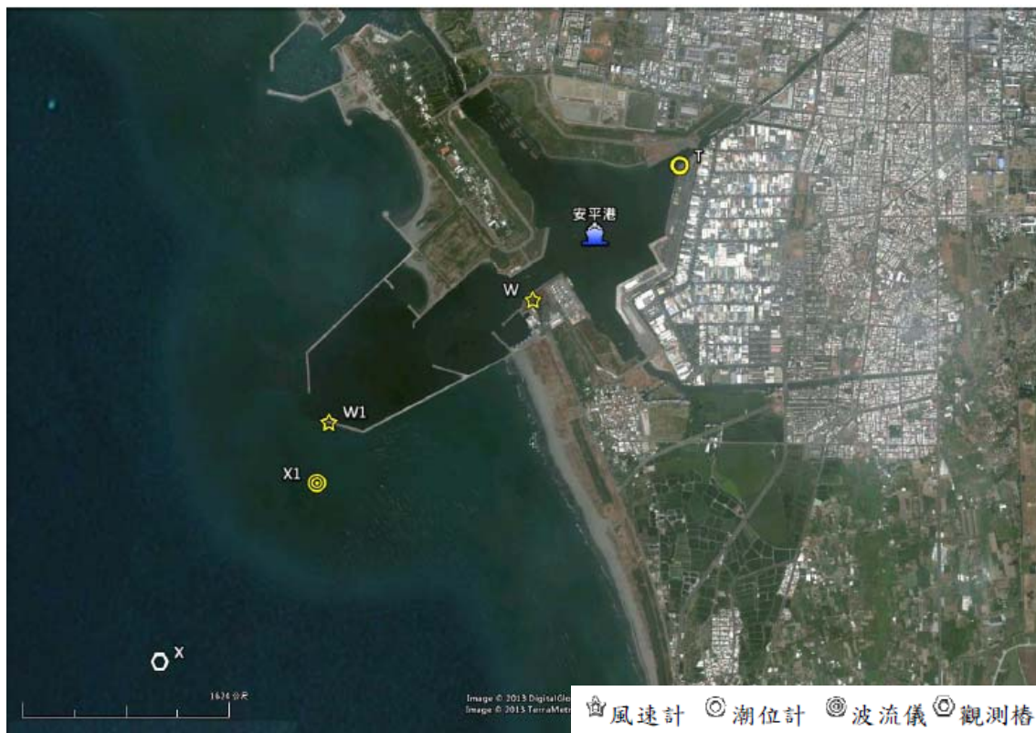
圖 2.8 安平港海氣象觀測位置示意圖
