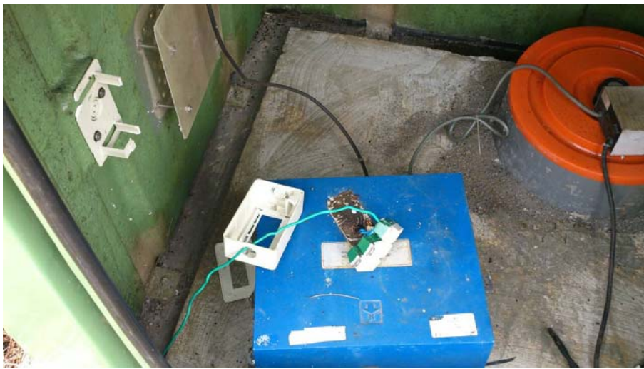
圖4、福壽山農場華岡測站(MTN173)遭外力破壞狀況。
