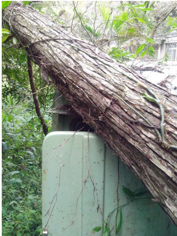
圖3、烏來桶後測站(MTN125)在天兔颱風過後受損情形。
