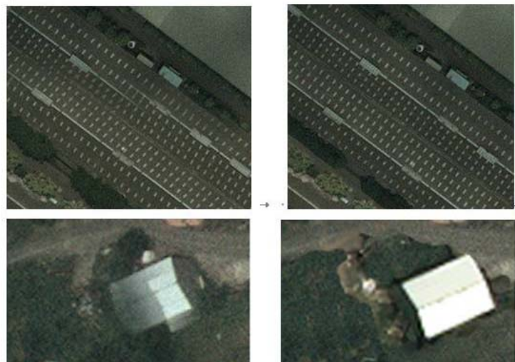
圖 2-29 正射影像編修前後比較（左邊為編修前、右邊為編修後）
