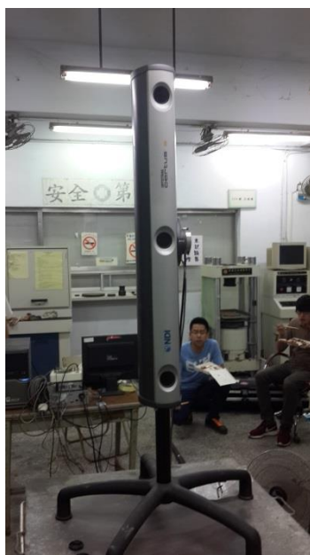
圖 3-19 架設 NDI 量測受拉鋼筋之伸長率
