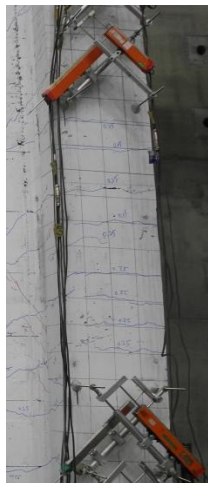
圖 4- 37 柱部分裂縫延伸至另一面
