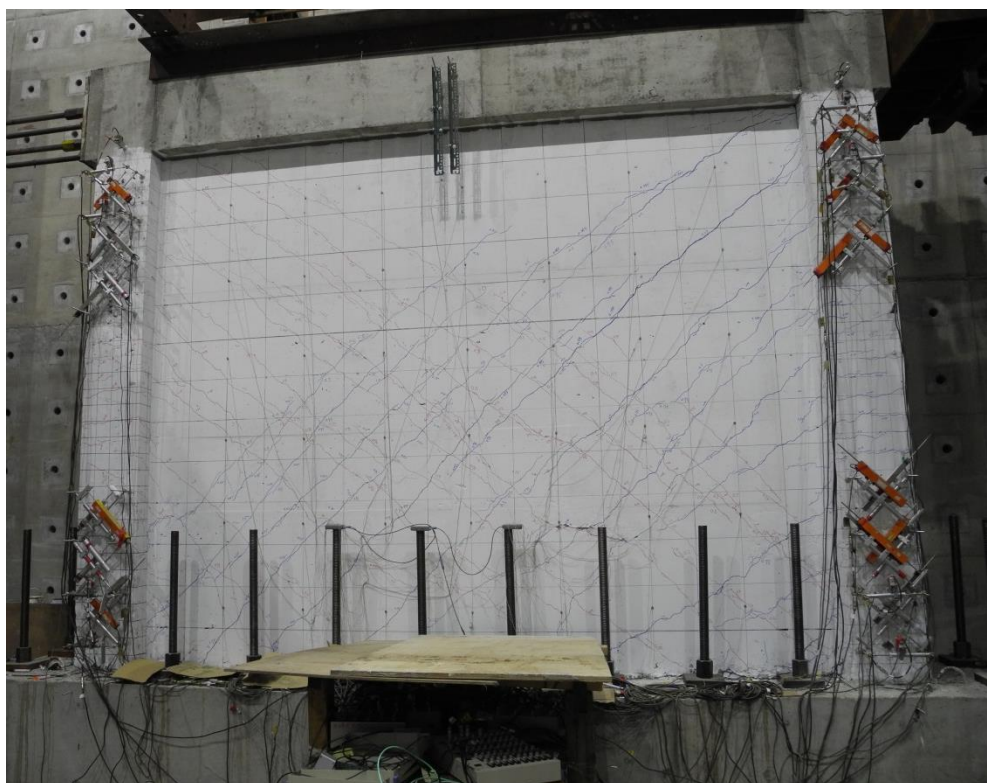
圖 4- 21 試體二在+1.0% drift 下裂縫情況
