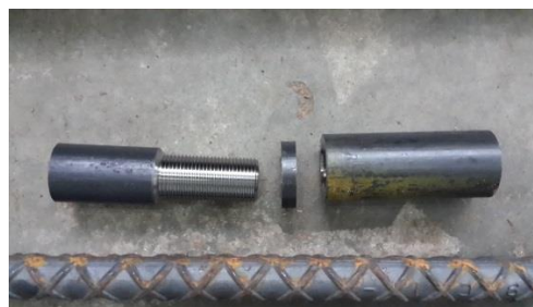
圖 3-22 (a)續接器拉力試驗；(b)破壞在母材
