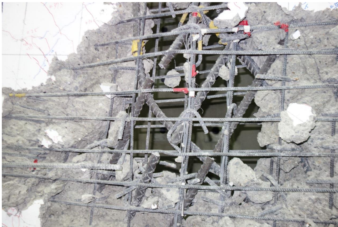
圖 4- 123 對角向鋼筋全斷
