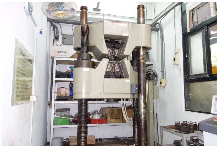
圖 3-18 鋼筋拉力試驗-台灣科技大學材料實驗室
