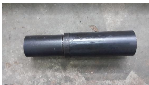
圖 3-22 (a)續接器拉力試驗；(b)破壞在母材
