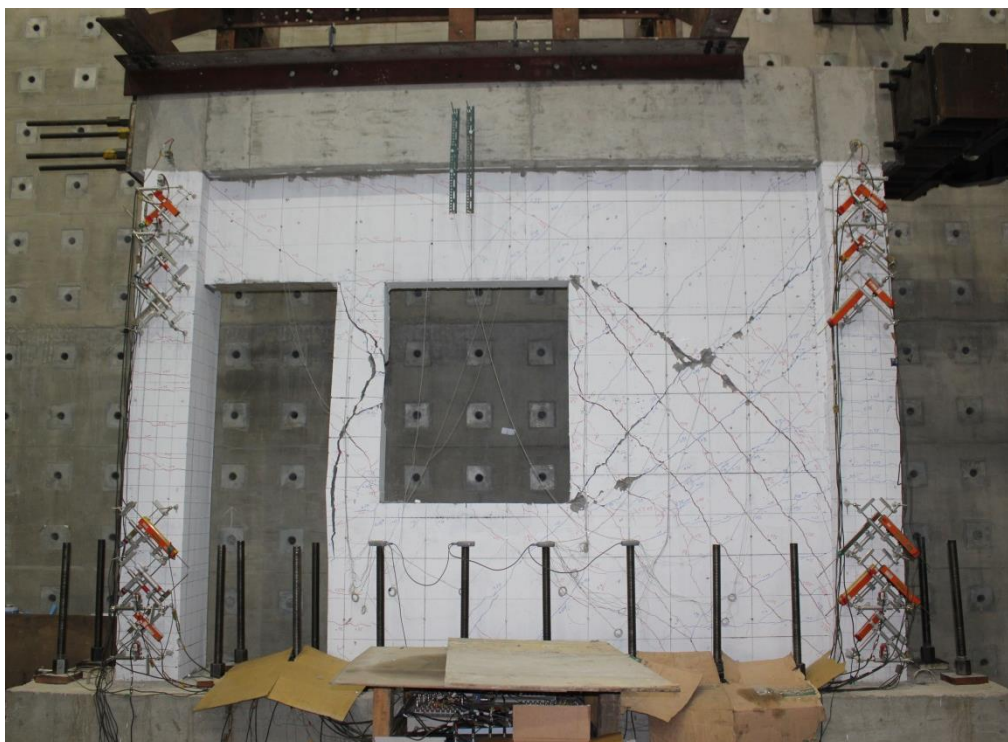
圖 4-46 試體三在-0.75% drift 下裂縫情況
