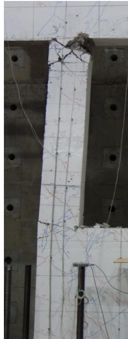
圖 4- 103 開口間小柱由剪力破壞轉為撓曲破壞，上緣產生塑鉸 (資料來源：本研究拍攝)
