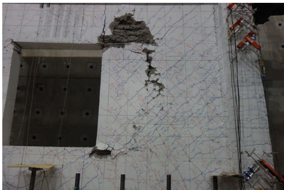
圖 4- 99 正向壓桿承壓區剝落，負向承壓區水平向鋼筋拉緊 (資料來源：本研究拍攝)
