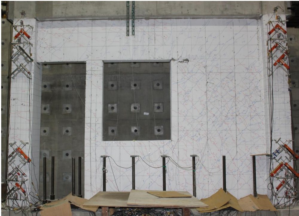
圖 4- 85 試體六在-0.75% drift 下裂縫情況 (資料來源：本研究拍攝)
