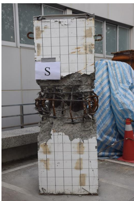
照片 4.43 T4-1 試體破壞後-S 面
