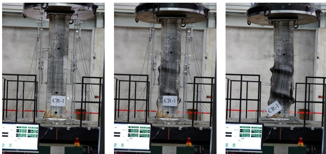
(a)在最大載重時之情況 (b)強度降至 80%之情況 (c)強度降至 50%之情況
