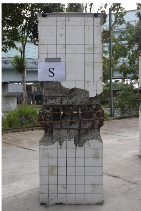
照片 4.47 T4-2 試體破壞後-S 面
