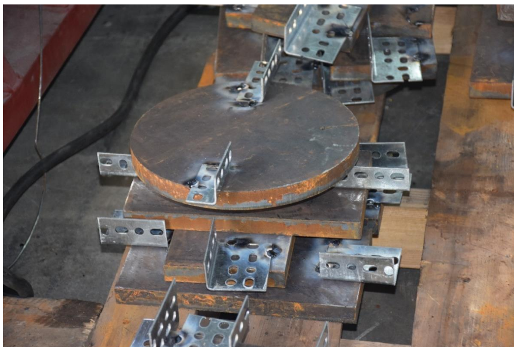
照片 C.11 試體上端板之切割鋼板
