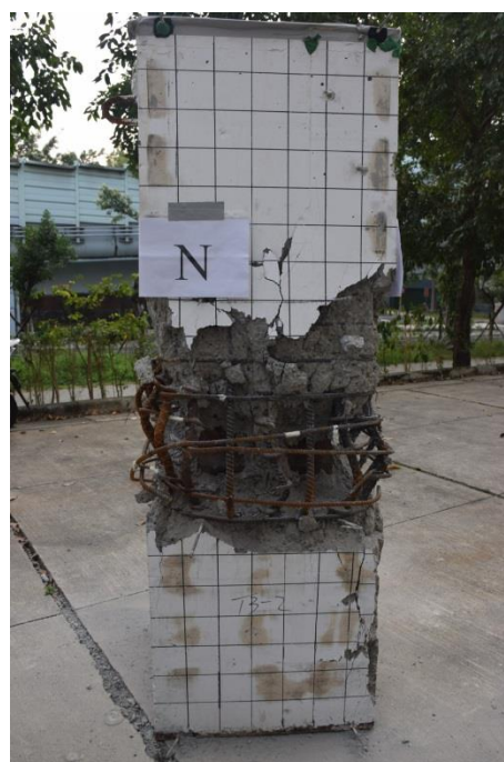
照片 4. 40 T3-2 試體破壞後-N 面
