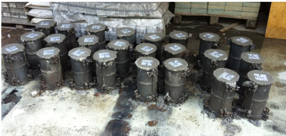
照片 C. 13 混凝土圓柱抗壓試體完成照
