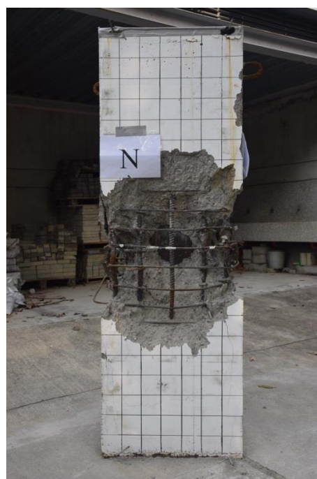
照片 4. 24 T1-2 試體破壞後-N 面
