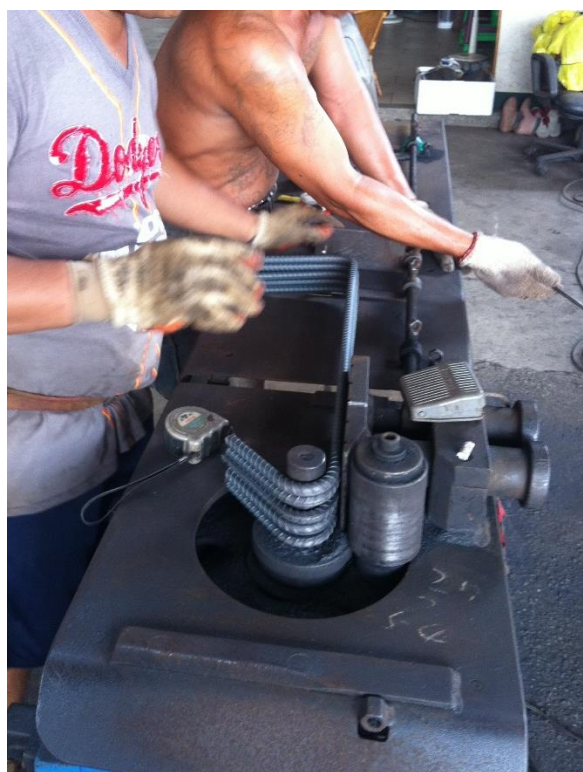
照片 C. 2 L 型箍筋 135 度彎鉤加工照
