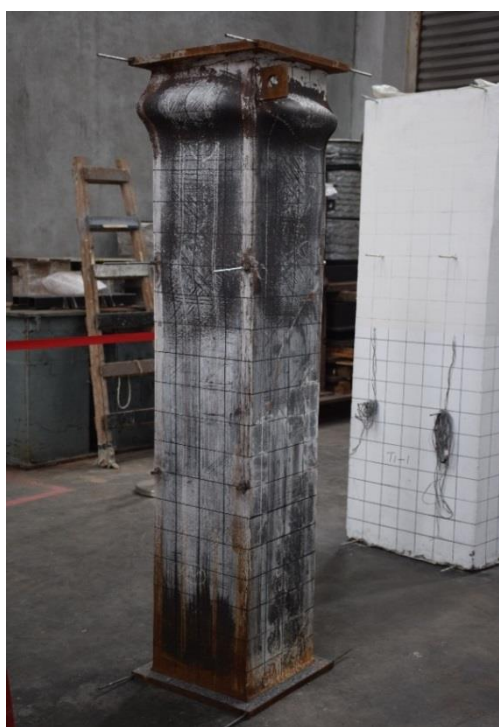
照片 4.5 CR-2 破壞後外觀之 1
