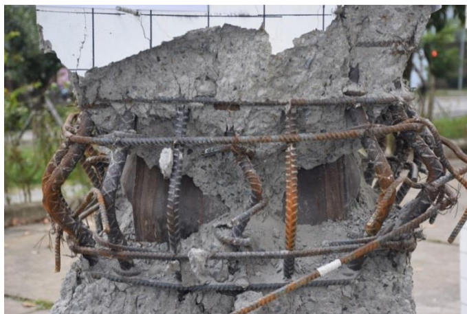
照片 4. 62 T4-1 試體破壞
