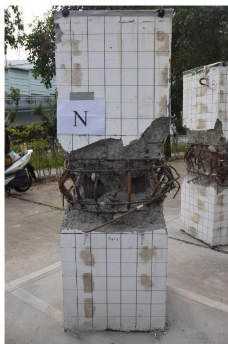
照片 4.44 T4-1 試體破壞後-N 面
