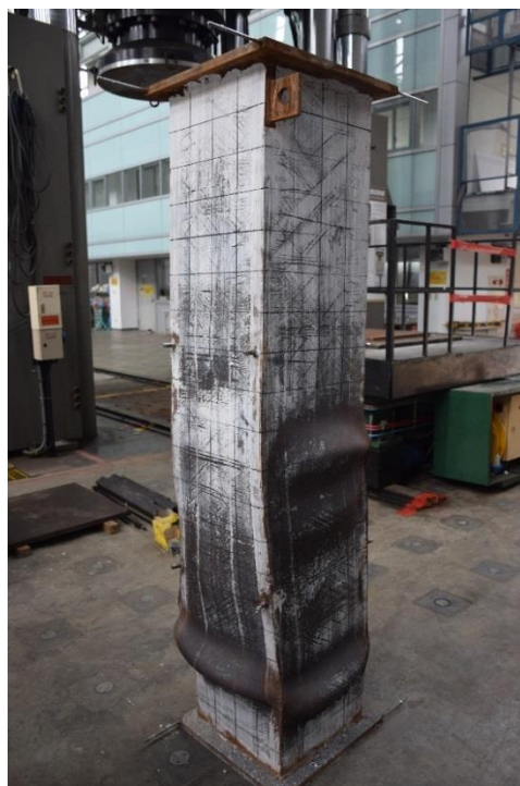
照片 4.4 CR-1 破壞後外觀之 2
