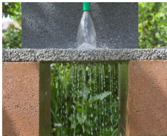
圖 4-11 透水鋪面與底層結構體入滲率之關係圖
