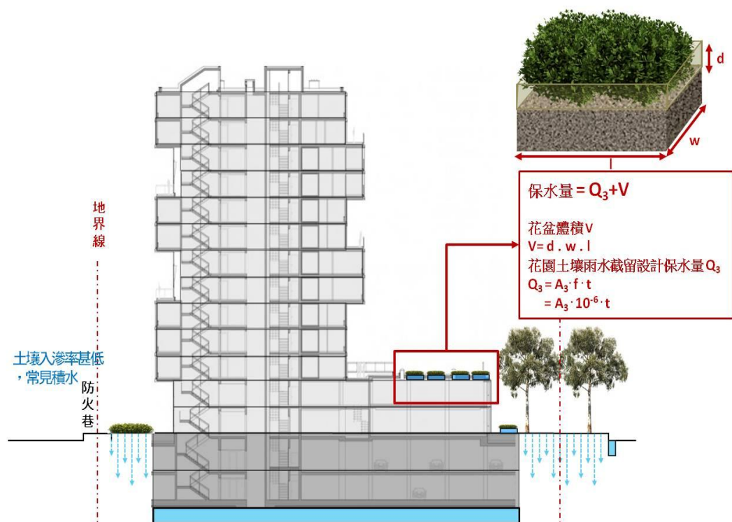
圖 2-27 建築技術規則 305 條基地保水指標規定示意圖
