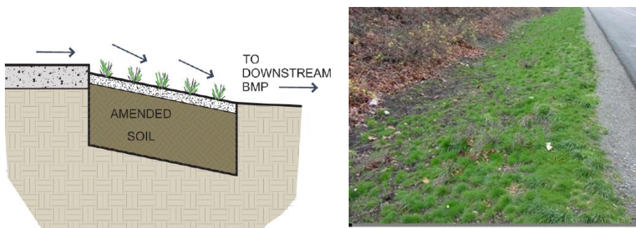
圖 4-26 過濾廊道示意圖及實施案例
