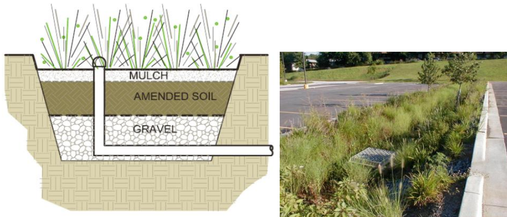
圖 4-22 生物過濾與暗渠組合示意圖及實施案例
