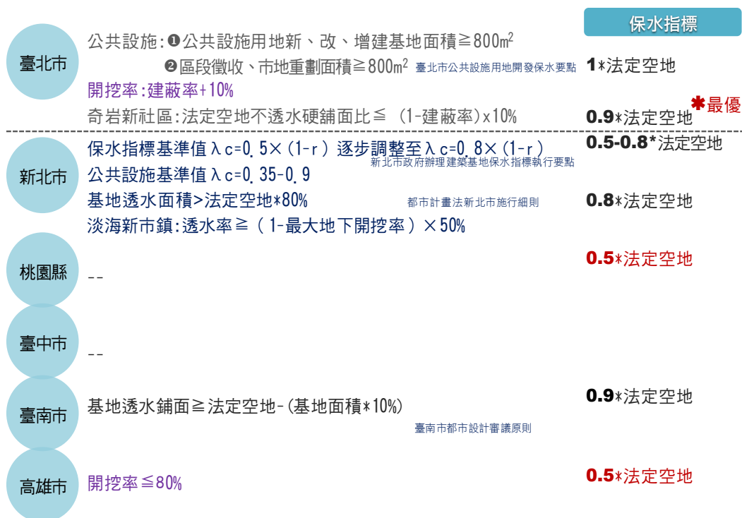
圖 3-19 6 都透水、開挖管理規定示意圖
