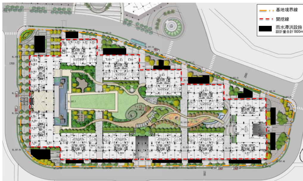
圖 3-15 建築技術規則 4-3 條雨水滯洪設施配置示意圖
