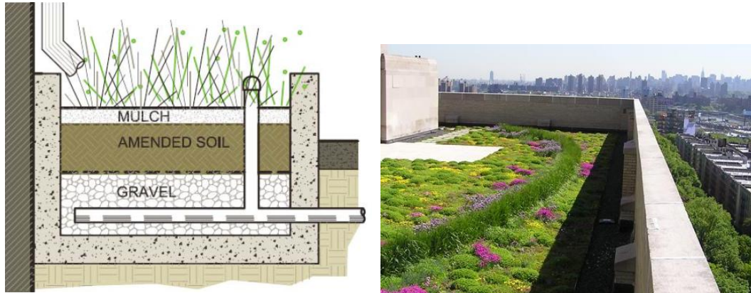
圖 4-23 植栽箱示意圖及實施案例
