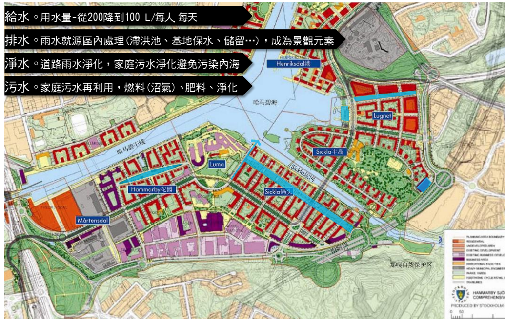
圖 3-5 瑞典斯德哥爾摩哈瑪比社區以水資源管理角度發展水綠網絡基盤
