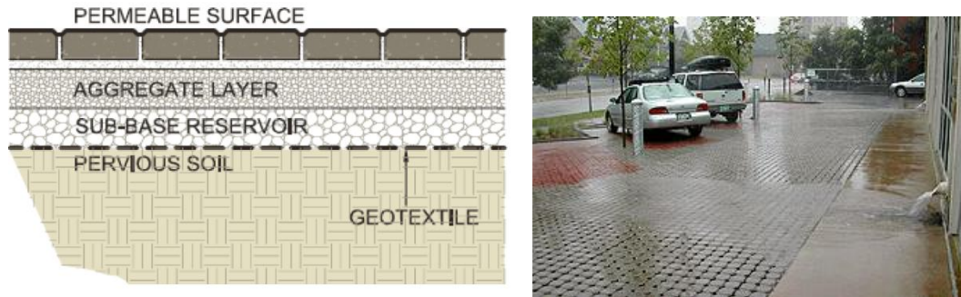
圖 4-20 透水鋪面示意圖及實施案例
