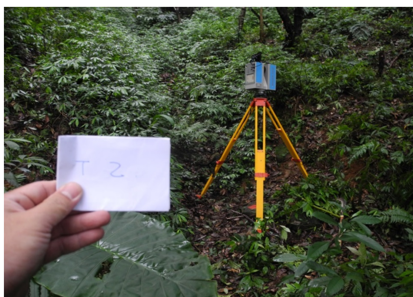
圖 4.3 外業掃瞄情形控制點觀測
