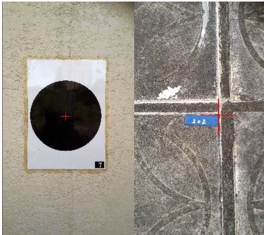
圖 2.22 牆面控制點(左圖)及地面控制(右圖)量測準則 (十字紅標表示觀測者應瞄準之瞄準線)
