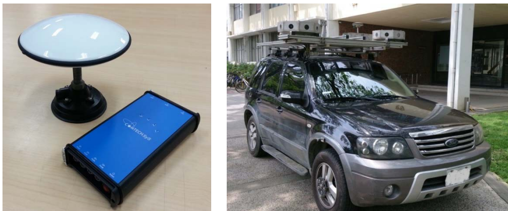
圖 4.3 GNSS 接收機與天線外觀(左)與車載製圖平台(右)
