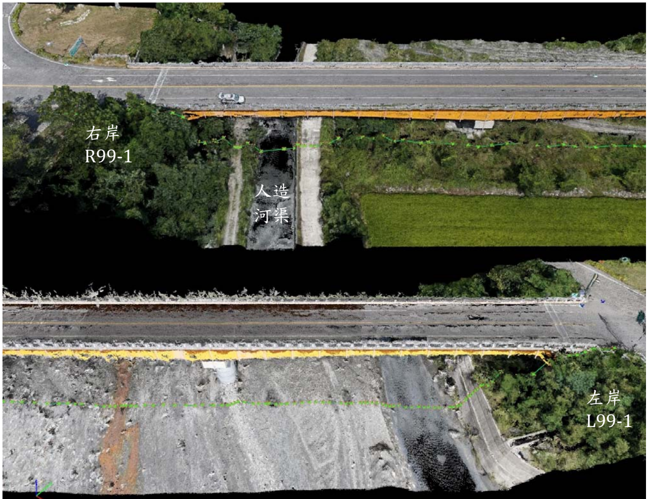
圖 5.17 斷面 99-1 三維點雲:(上圖)右岸與(下圖)左岸斷面測量範例
