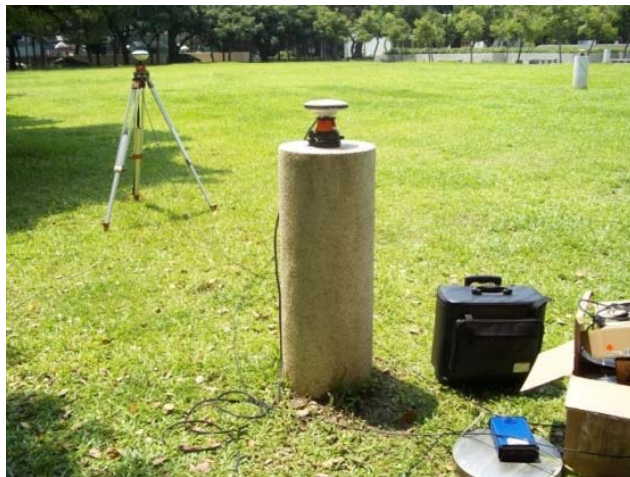
圖 3.12 高精度位置與航向基樁之室外靜態率定場之實測
