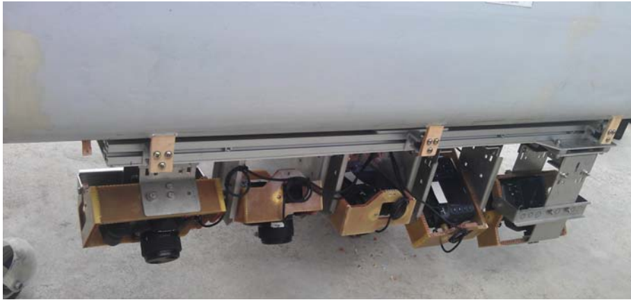
圖 5.24 五相機攝影系統(©成大饒見有/日成航太)
