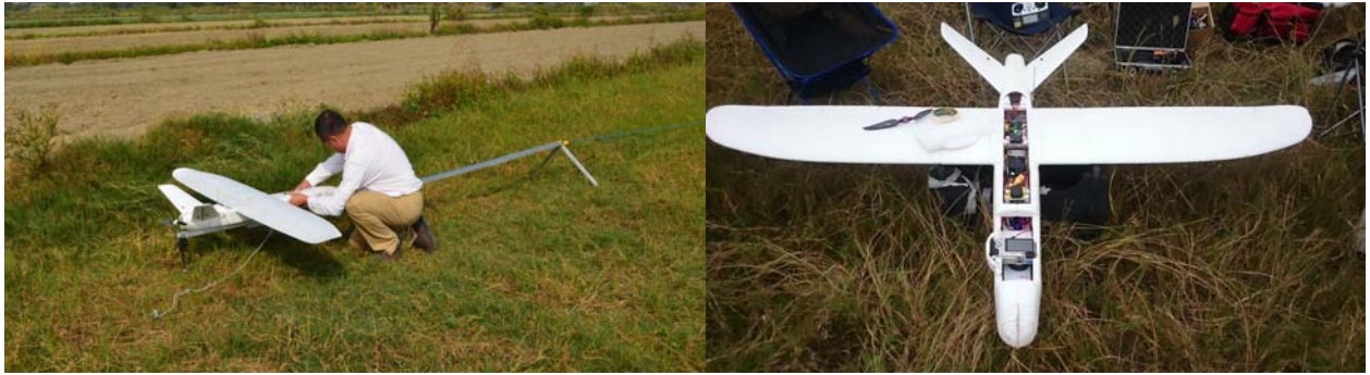
圖 5.7 本計畫採用的定翼 UAV(MX-1)
