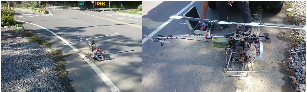
圖 5.9 本計畫採用的直升機旋翼 UAV
