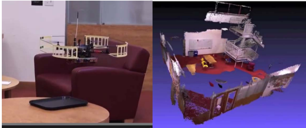
圖 3.8 無人小型飛機搭載 Kinect 進行室內製圖(WASHINGTON, 2013)
