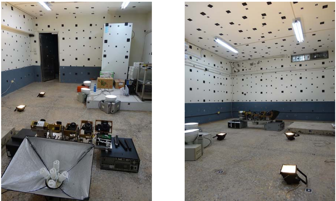
圖 5.31 五相機相對方位率定的現場情況
