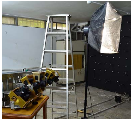
圖 5.30 相機內方位率定的現場情況
