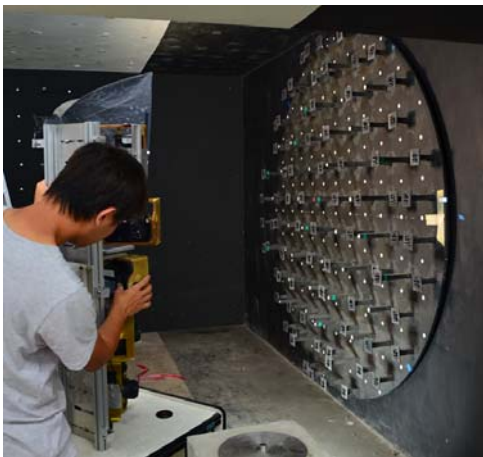
圖 5.30 相機內方位率定的現場情況
