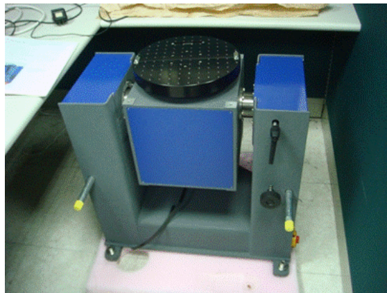
圖 3.17 高精度雙軸轉台 MOTION DYNAMIC TES-3T
