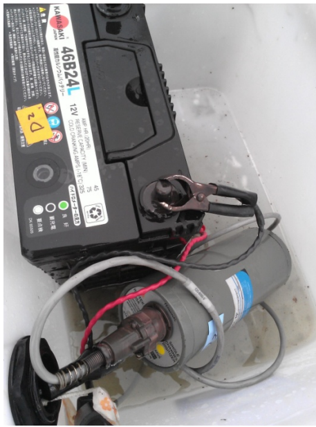
圖 85 桃源谷 TYD2 測點儀器因蘇力颱風翻覆進水。
