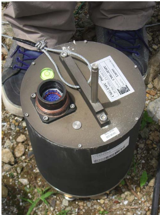
圖 23 井下地震儀之外觀。(a) 記錄器；(b) 感應器。
