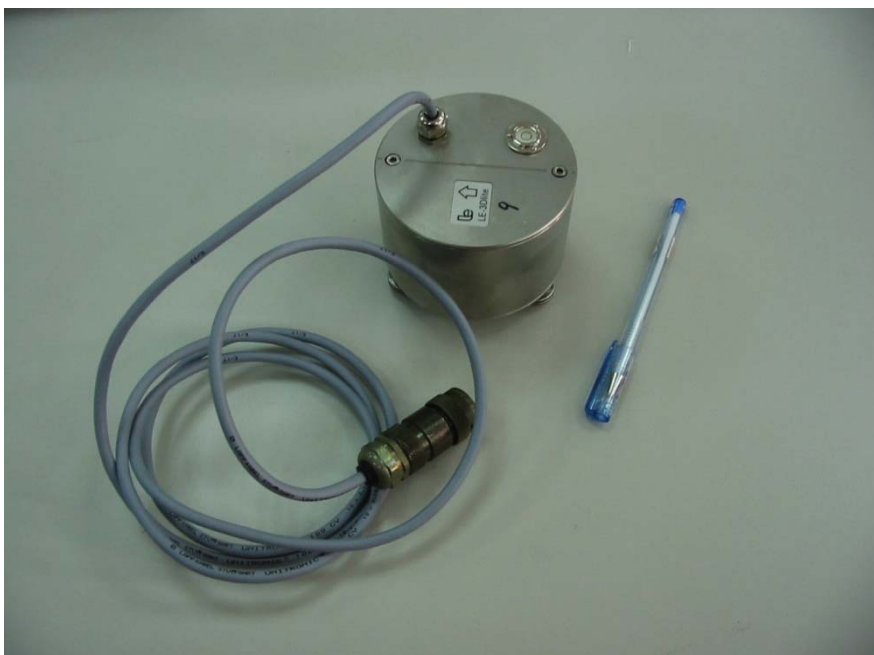
圖 7 德國 Mark Products 公司所製 LE-3Dlite 短週期速度型感應器。
