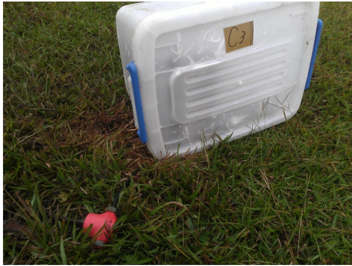
圖 84 桃源谷 TYC3 測點儀器因蘇力颱風翻覆。
