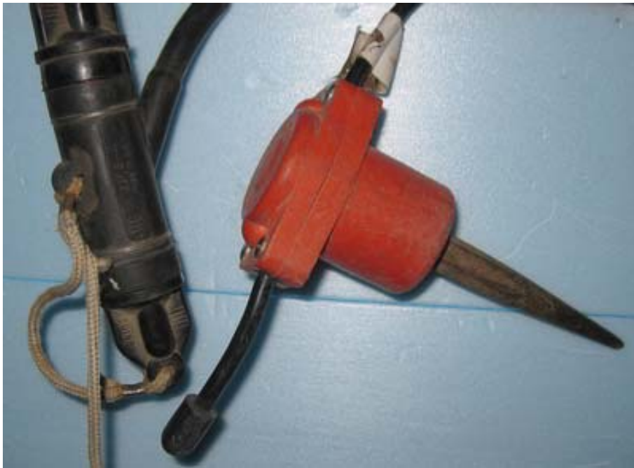
圖 4 4.5Hz 垂直向感應器 (GS-11D)。
