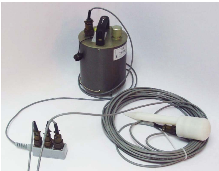
圖 6 英國 Guralp 公司所製 CMG-6TD 中長週期速度型地震儀(感應器與記錄器)。
