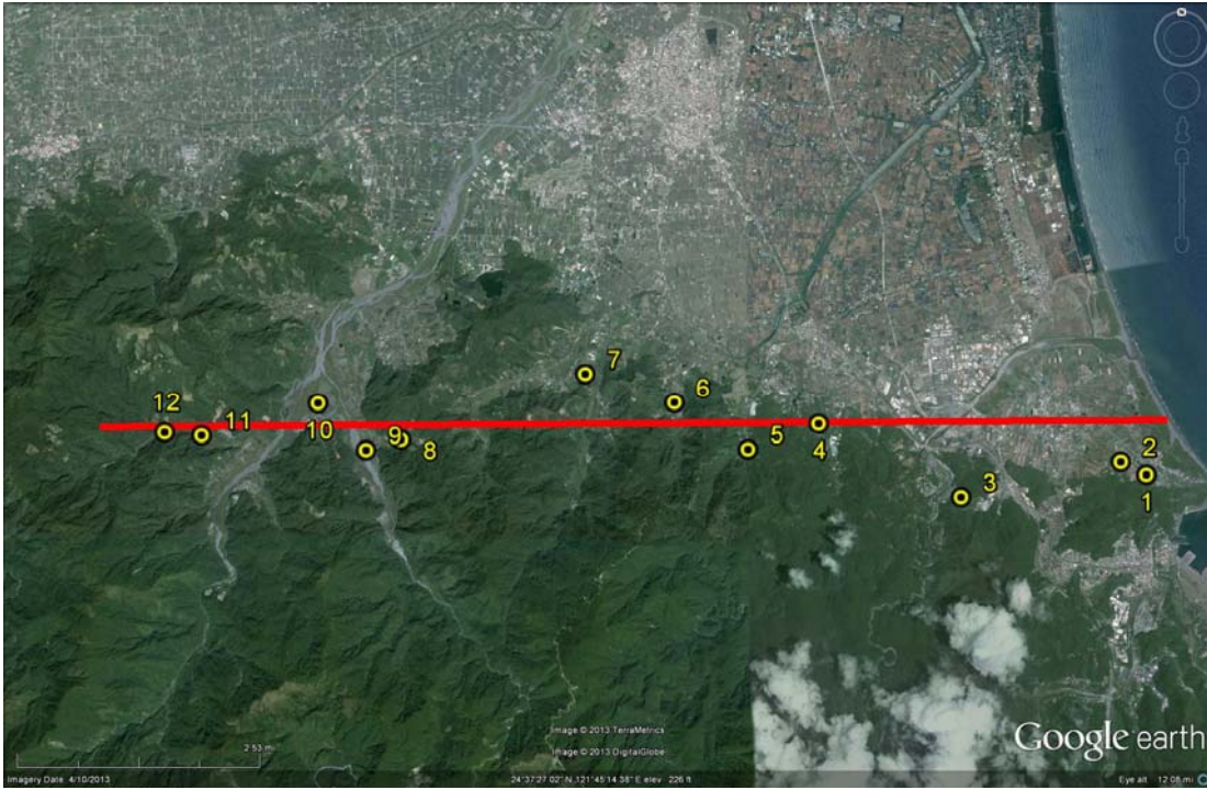
圖 76 宜蘭平原南側大地電磁 12 個測站衛星影像位置圖。黃色圈點是 MT 測站，編號順序由東向西排列，紅色線為二維逆推剖面。資料來源：Google earth。
