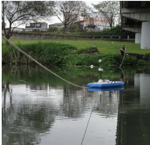
圖 12、聲波都卜勒流速剖面儀(RiverSurveyor M9)於宜蘭河中山橋操作情況。
