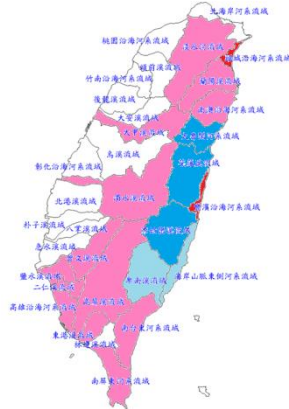
圖 54 以 9 月 21 日 06Z 為預報初始時間，針對 (a) 0-12 小時、(b) 0-24 小時、(c) 0-48 小時、(d) 12-24 小時及 (e) 24-48 小時，流域平均之觀測與系集平均之誤差百分比分布圖。其中粉紅色代表模式高估超過 20%，紅色代表預報高估但誤差率小於 20%，淺藍色表示預報低估超過 20%，而深藍色則代表預報低估在 20% 以內。
