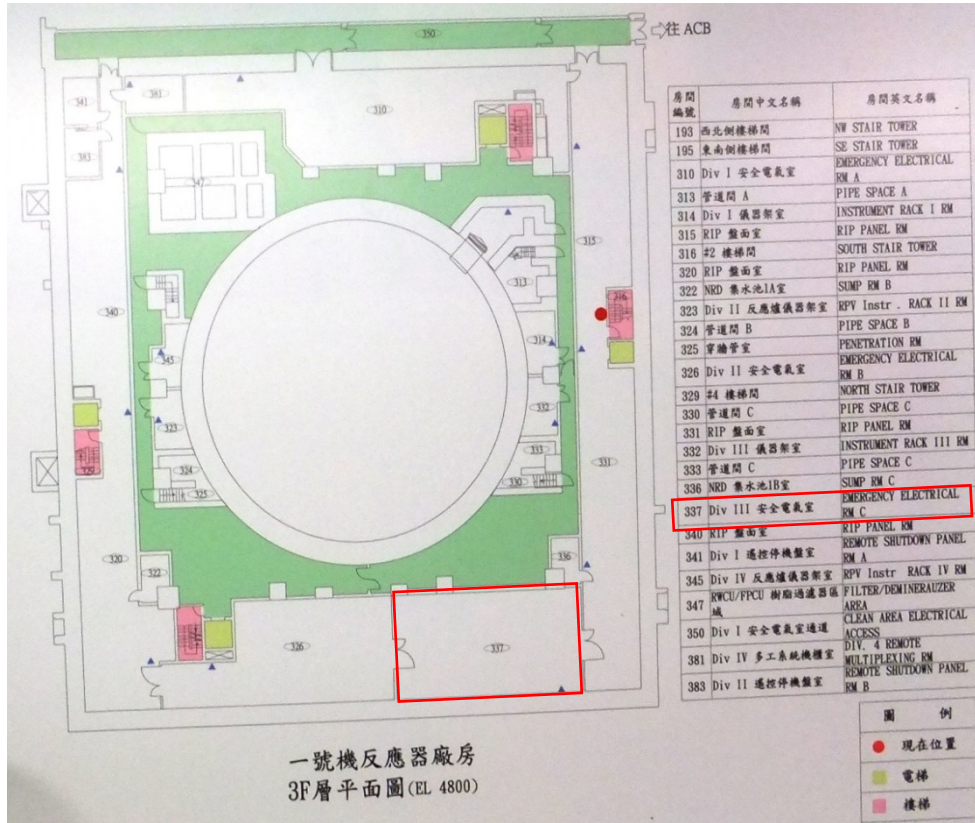
圖 2.1 龍門電廠 MCC 電氣盤體位置 (Room 337)
