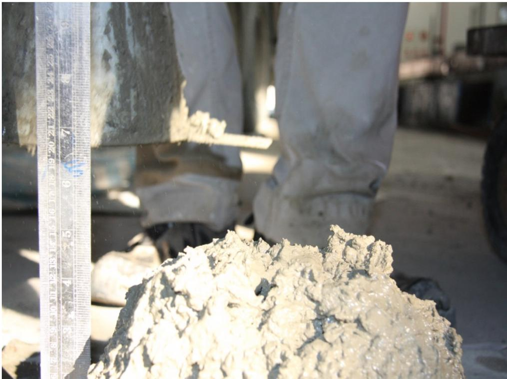
圖 3-22 HT1b 試體坍度照片
