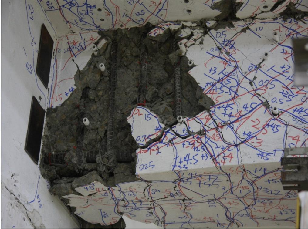
圖 4-21 HT1b 試體梁腹最終破壞情形(DR=5.5%)
