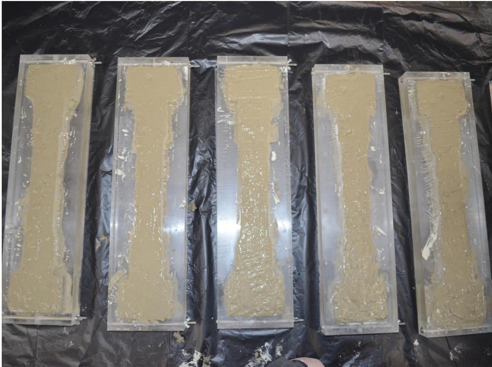
圖 3-6 混凝土抗拉試體澆鑄
