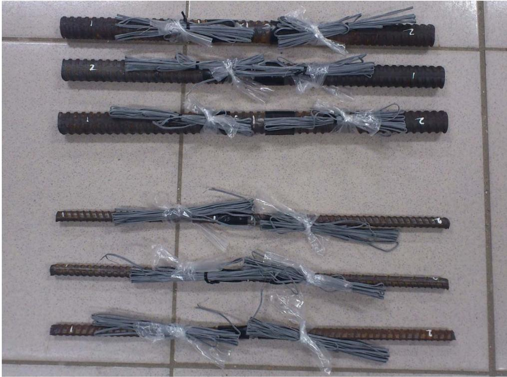
圖 3-3 鋼筋拉伸試驗鋼筋
