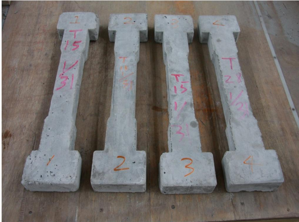
圖 3-7 混凝土抗拉實驗前置處理-試體磨平
