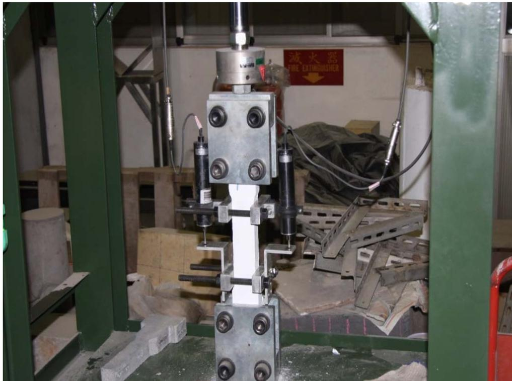
圖 3-8 混凝土抗拉實驗
