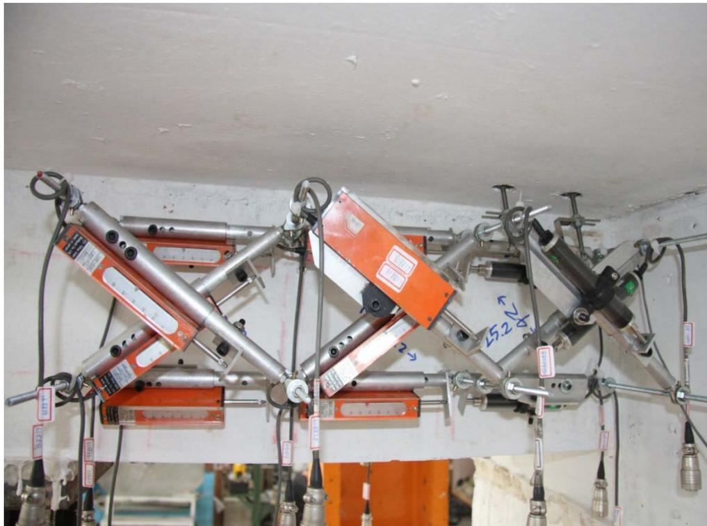
圖 3-32 混凝土矩形應力塊測計架設圖
