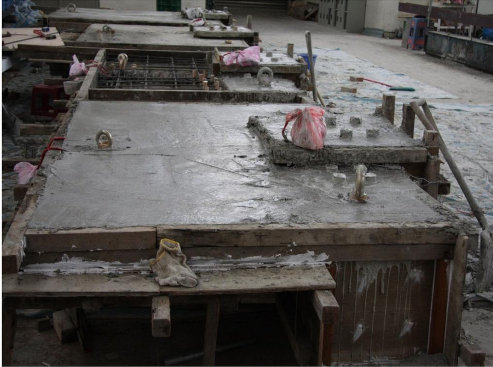
圖 3-23 HT1b 試體澆鑄結束
