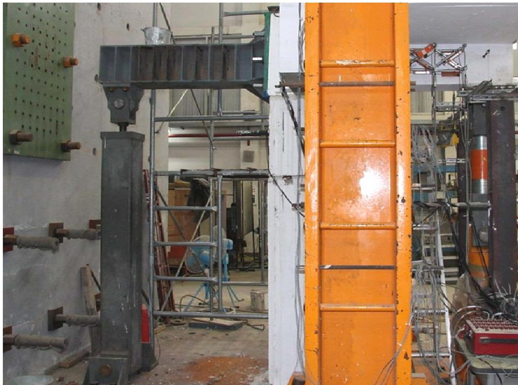
圖 3-28 反力鋼梁架設圖
