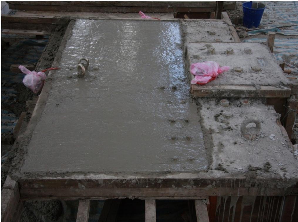
圖 3-26HT1bj 試體第二次澆鑄結束
