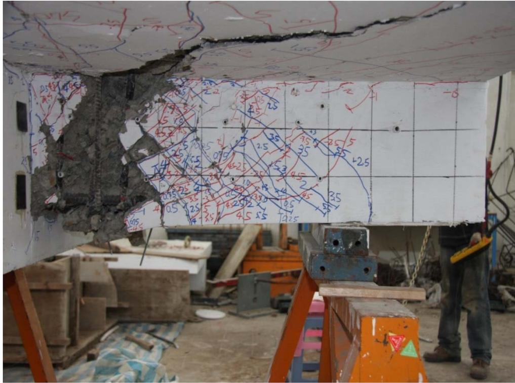
圖 4-45 HT1bj 試體破壞時梁腹裂縫發展情形(DR=5.5%)
