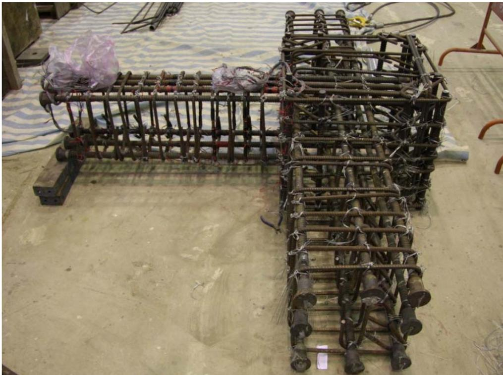
圖 3-14 試體鋼筋籠組裝
