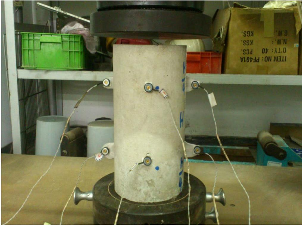
圖 3-5 光學測量儀-圓柱試體三分點
