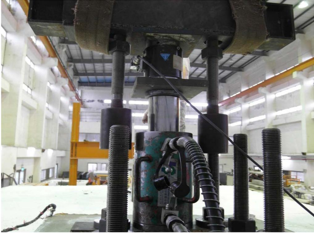
圖 3-39 施加預力系統設置
