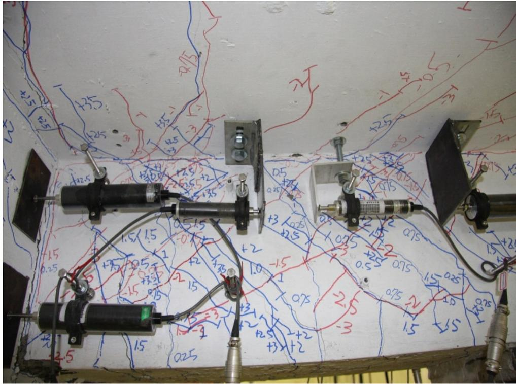
圖 4-19 HT1b 試體在  $DR=+3.5\%$  時剪力裂縫與交接面裂縫發展情形
