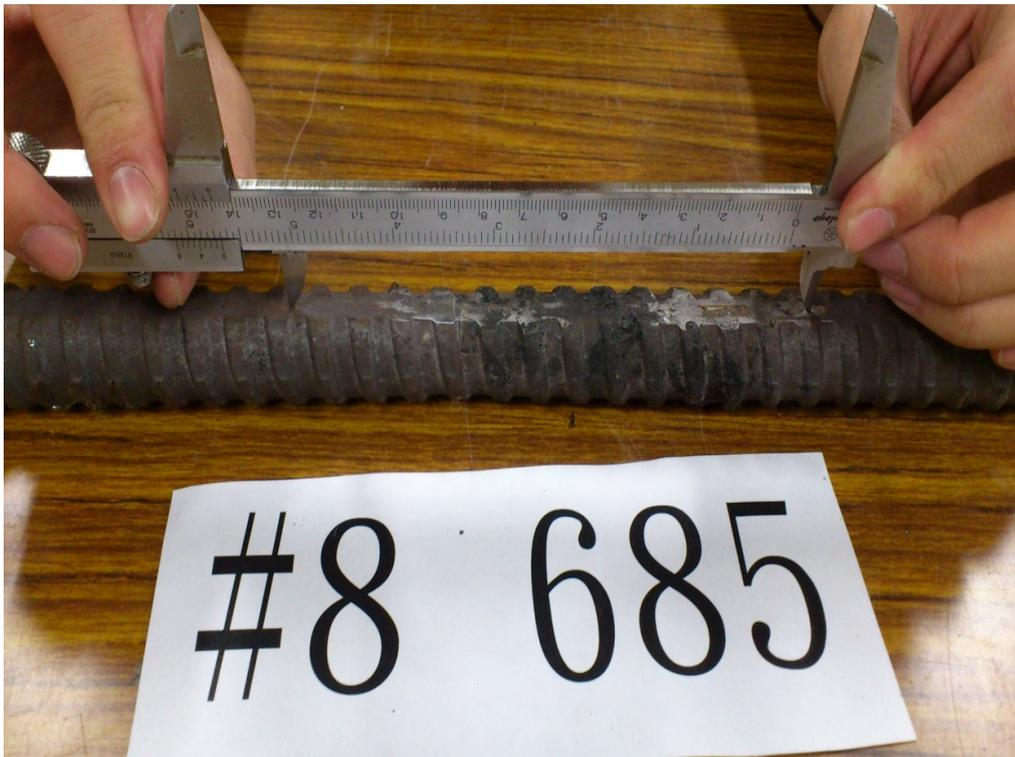
圖 3-4 鋼筋伸長率量測
