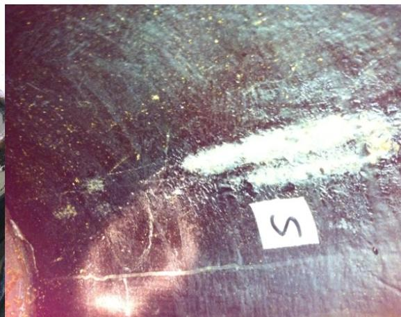
(b) A 型接頭管內裂縫形成
