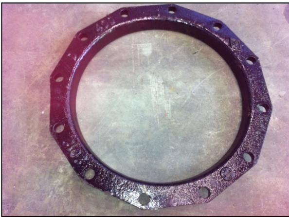
圖 2.9 A 型接頭壓圈
