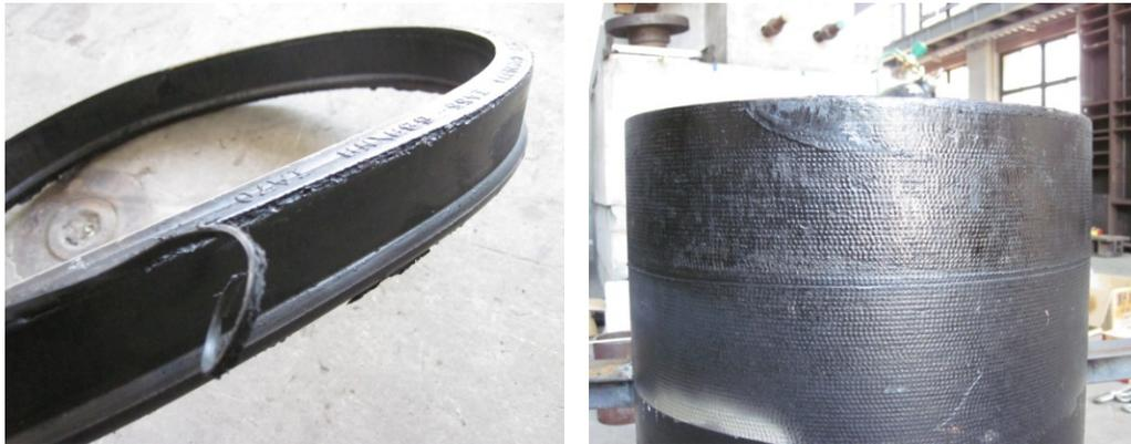
(a)膠圈破壞情形
