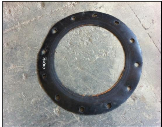
圖 2.14 橡膠墊圈
