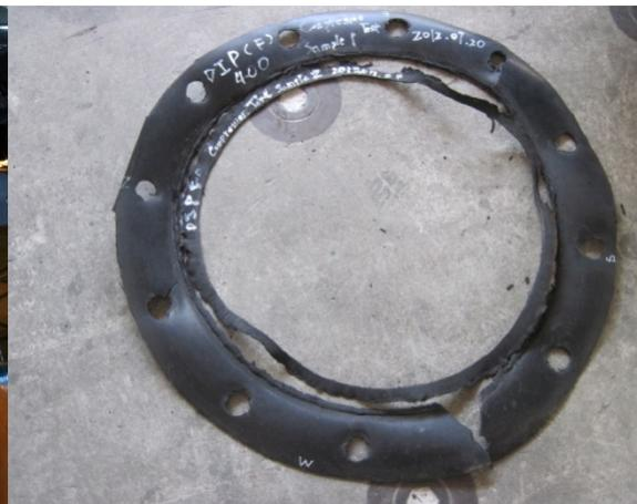
圖 3.56 DIP(F)400-C1 試驗膠圈檢視[34]
