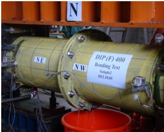
圖 3.66 DIP(F)400-B1 試驗終止情形[34]
