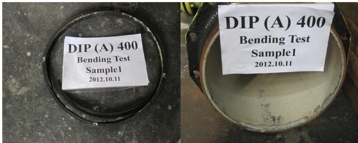
(a) 承口試驗下緣膠圈破壞情形
