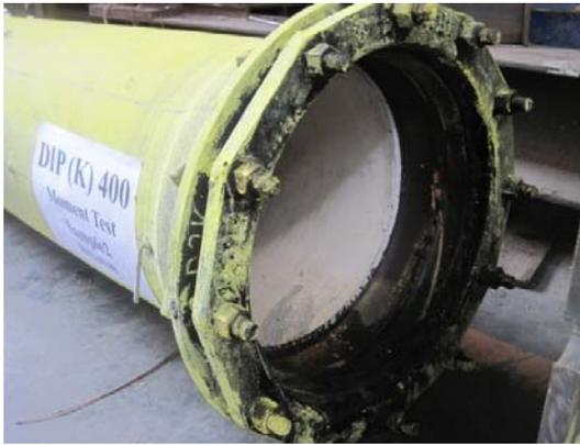
(a) 承口試驗下緣膠圈破壞情形
