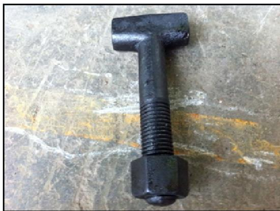
圖 2.6 K 型接頭壓圈之 T 型螺栓
