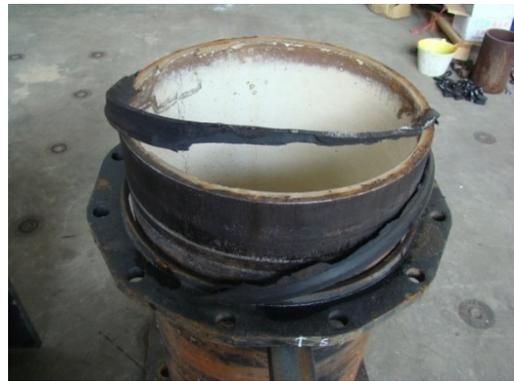
(b) 試驗結束直管接頭無損壞
