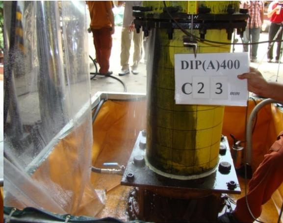
圖 3.34 DIP(A)400-C1 試驗終止情形
