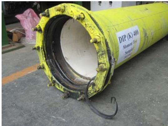
(a) 承口試驗下緣膠圈破壞情形
