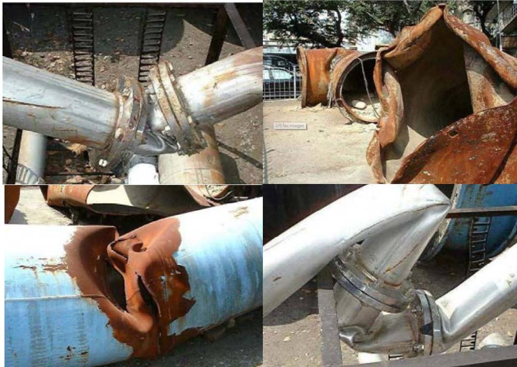
圖 1.1 自來水管線局部挫屈[6]
