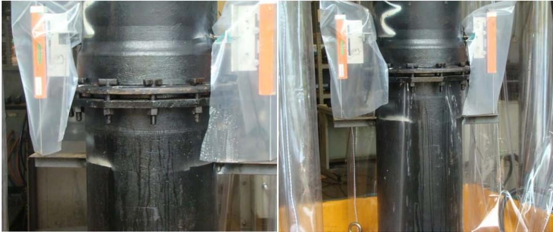
(a)試驗終止時承口拔離插口
