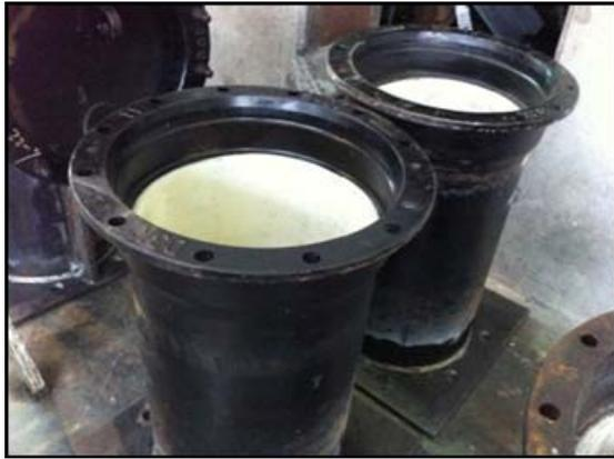
圖 2.2 K 型接頭承口端
