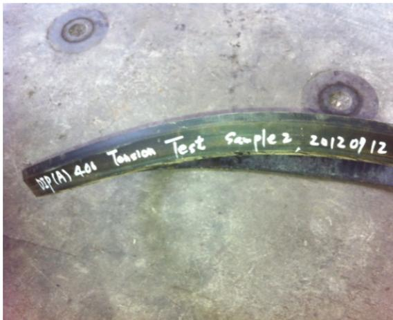
(a) 試驗結束膠圈無破壞
