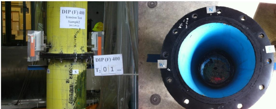
圖 3.52 DIP(F)400-T2 試驗終止情形[34]
