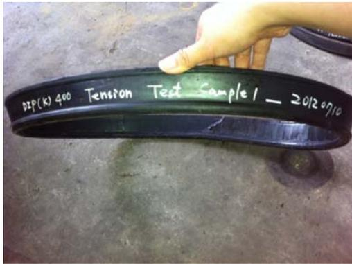
(a) 膠圈破壞情形
