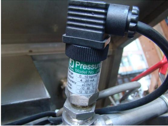
圖 2.31 壓力傳感器
