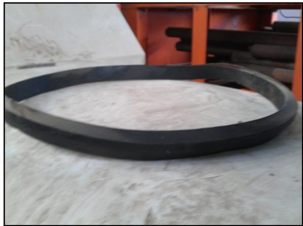
圖 2.10 A 型接頭膠圈
