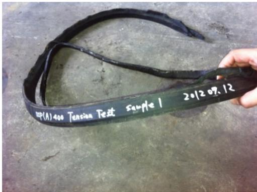
(a) 試驗結束膠圈破壞情形
