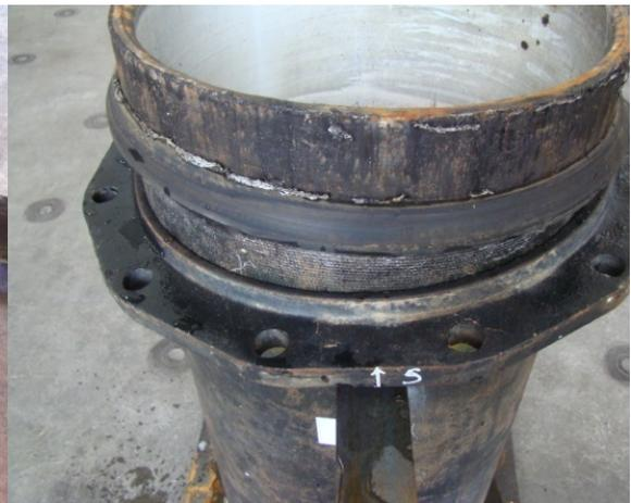
(b) 試驗結束直管接頭無損壞
