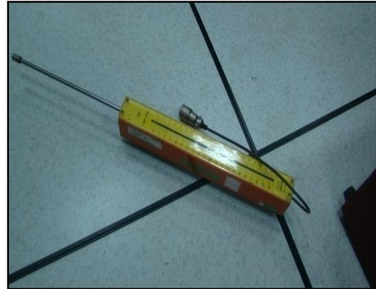
圖 2.34 LVDT 位移轉換器
