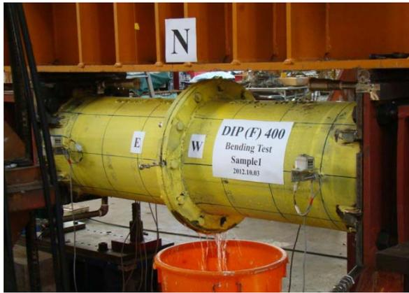
圖 3.62 DIP(F)400-B1 試驗終止情形[34]
