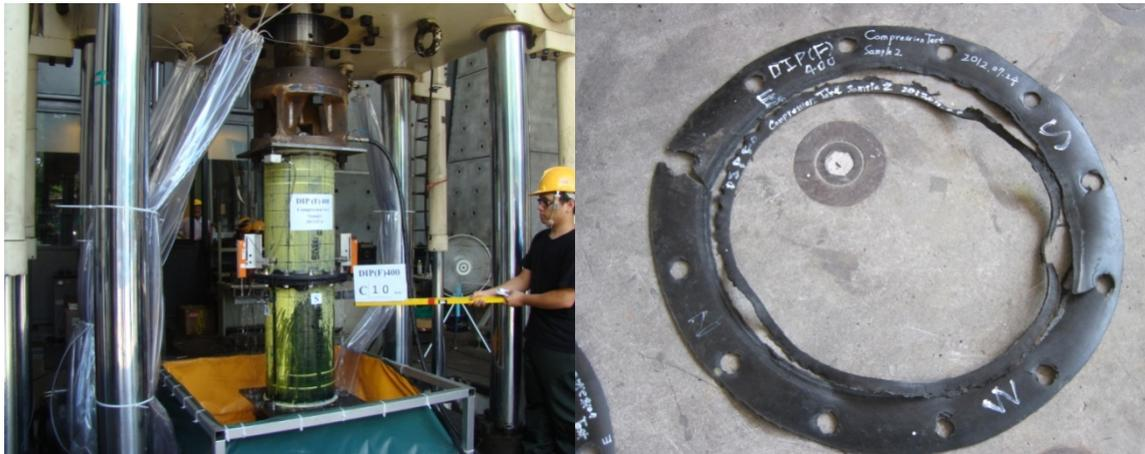
圖 3.58 DIP(F)400-C2 試驗終止情形[34]
