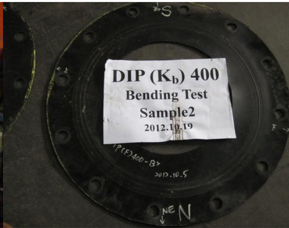
圖 3.67 DIP(F)400-B2 試驗膠圈 [34]
