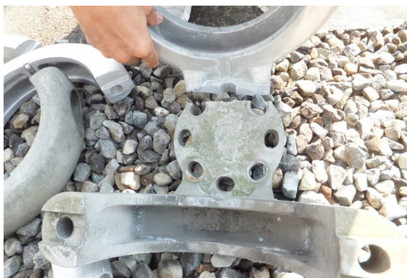
圖7.16 高空匯流排鋁管夾具破壞
