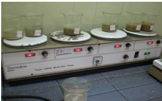
圖 4.9 混凝土粉末浸泡於蒸餾水煮沸
