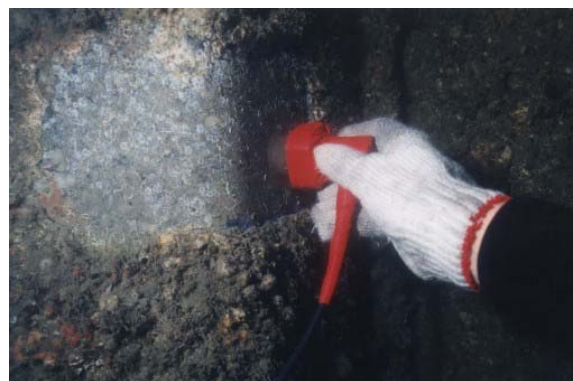
圖 3.9 鋼版樁厚度檢測情形
