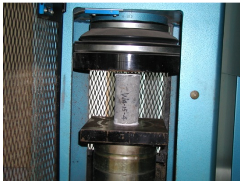
圖 4.7 試體之抗壓試驗
