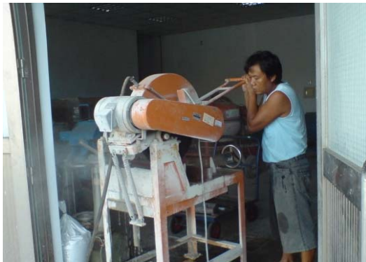
圖 4.5 鑽心試體切割
