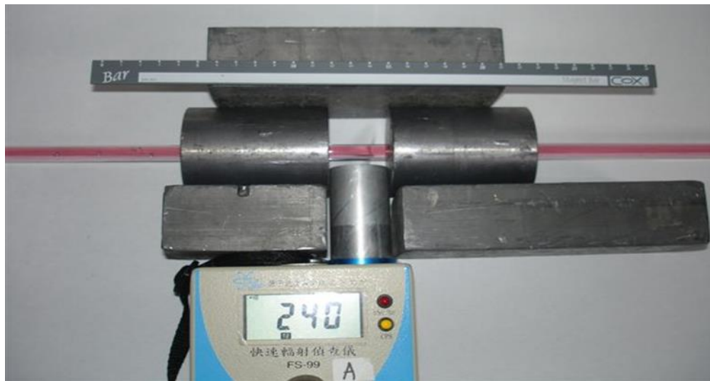
圖 5：閃爍體偵檢器測試個別棒狀射源活度
