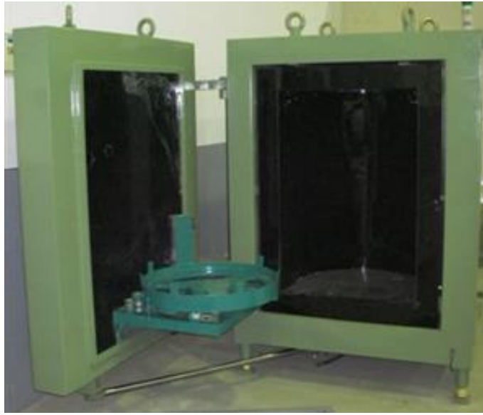
圖 2-5：核研所自製塑膠閃爍體桶形偵檢器
