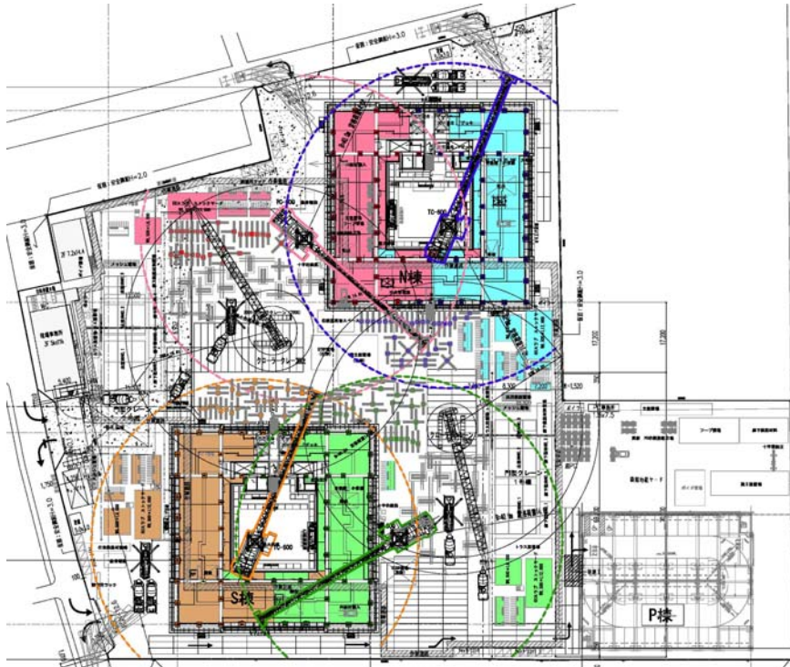
圖 6.4.5 預鑄構材現場製作場例
