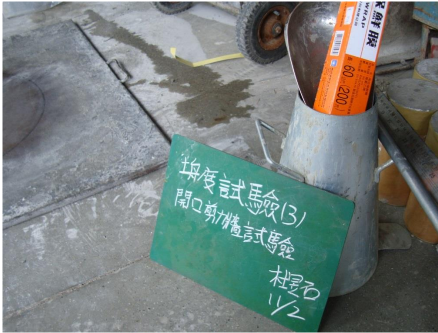
圖 B.49 第三部分灌漿(後二座試體)坍度試驗
