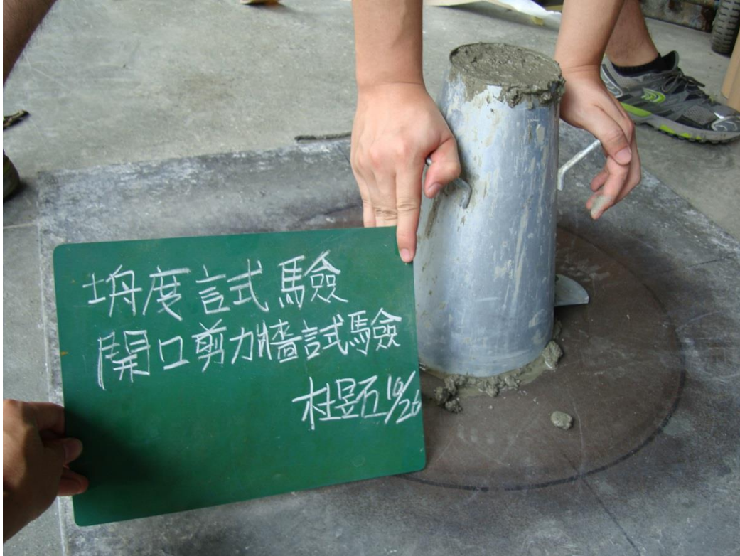
圖 B. 47 第二部分灌漿(前三座試體)坍度試驗
