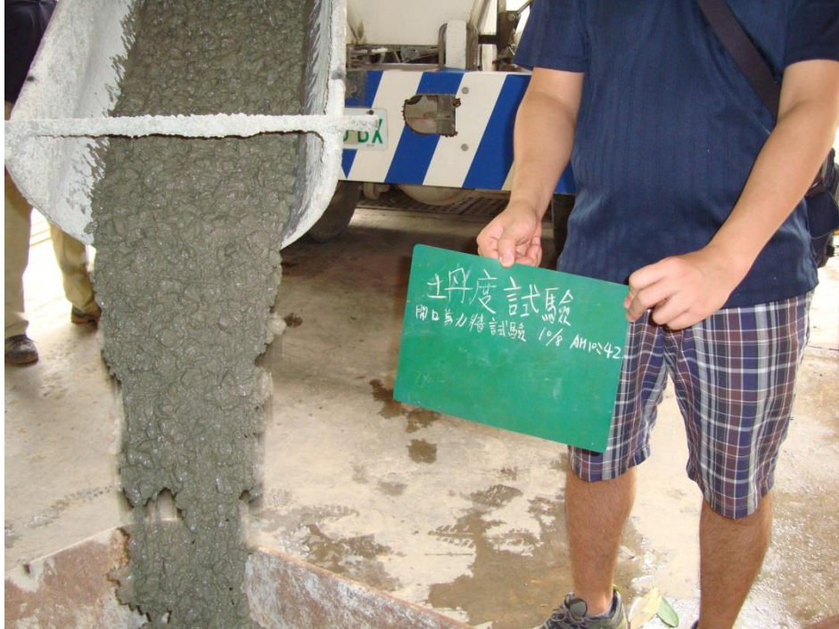
圖 B.21 坍度及抗壓圓柱試驗試體取樣
