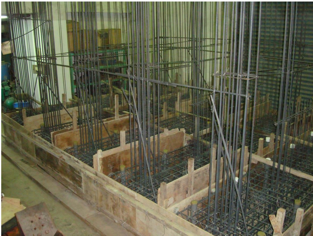
圖 B.16 灌漿前試體整治後全貌
