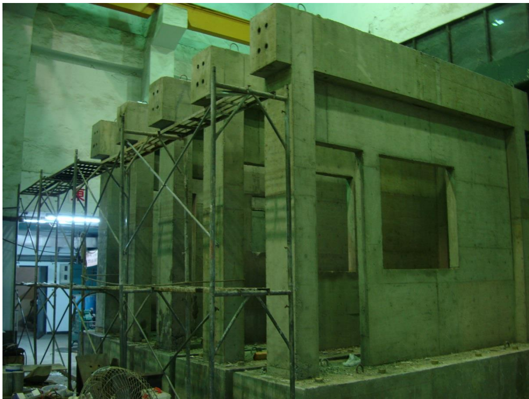
圖 B.52 拆模完成後試體全觀
