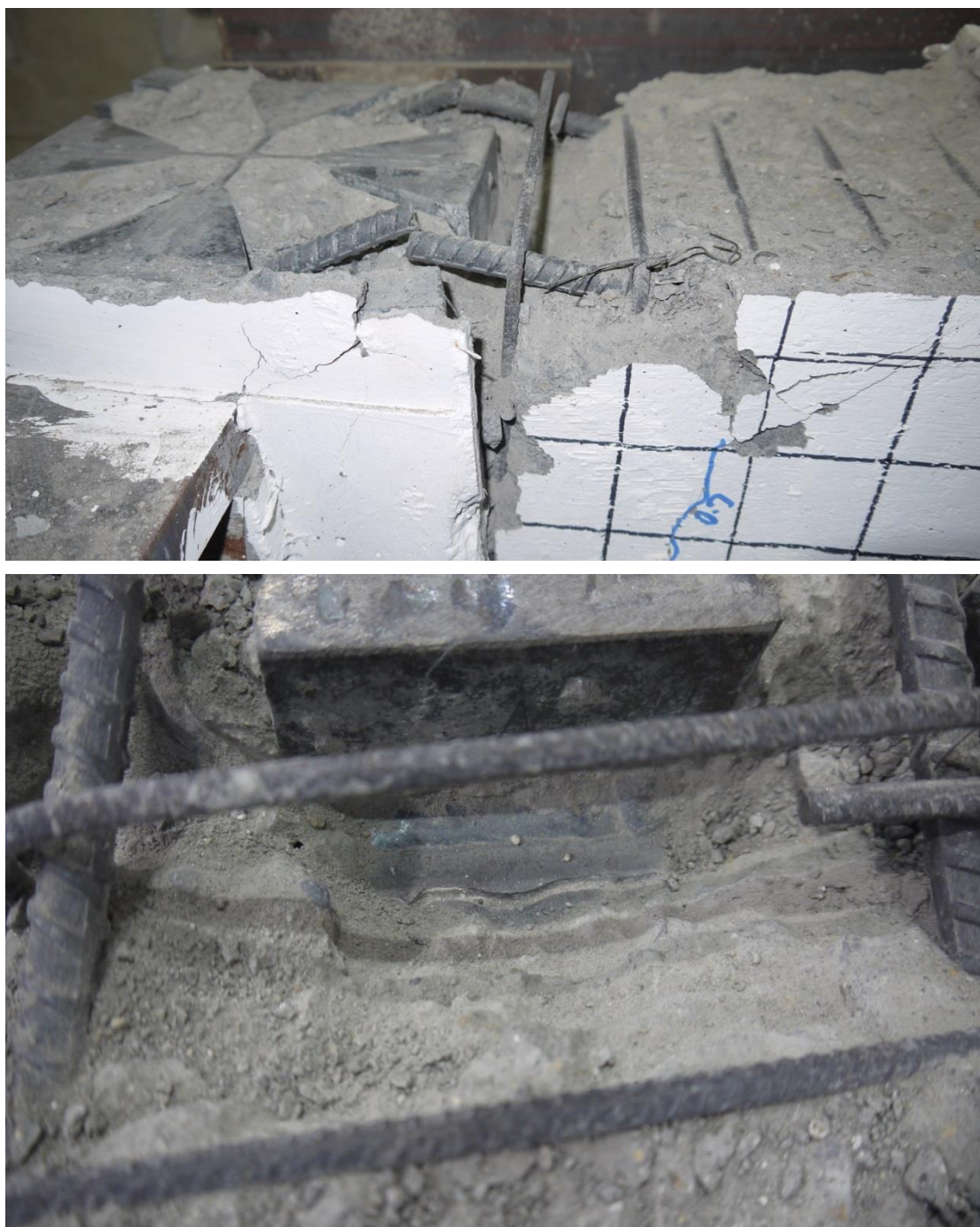
圖 F-21 構架試體頂層梁編號RB3之梁頂於實驗結束後之破壞情形 (資料來源：本研究拍攝)
