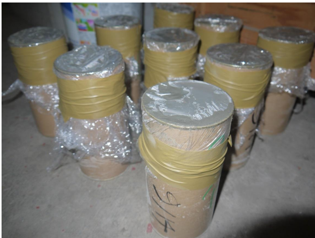
圖 C- 53 圓柱試體製作完成照
