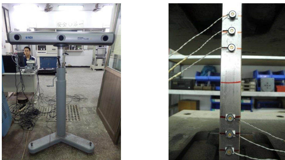
圖 4-2 鋼材拉力試片量測系統與量測方式
