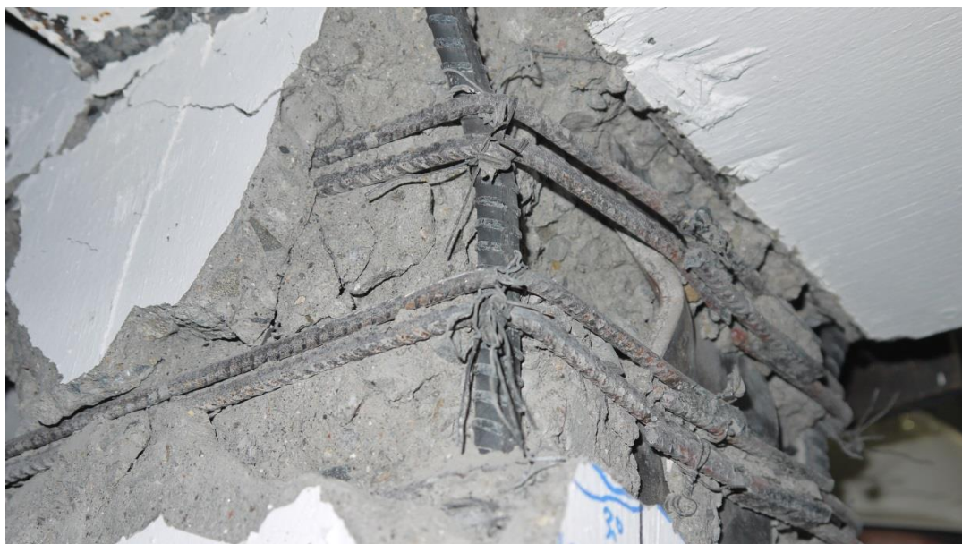
圖 4-63 2C_{d1} 塑鉸區鋼骨翼板挫屈嚴重
