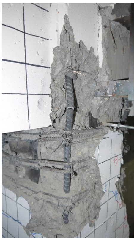
圖 F-23 構架試體第二層柱編號 2Cd_1 柱於實驗結束後鋼骨翼板挫屈之情形 (資料來源：本研究拍攝)
