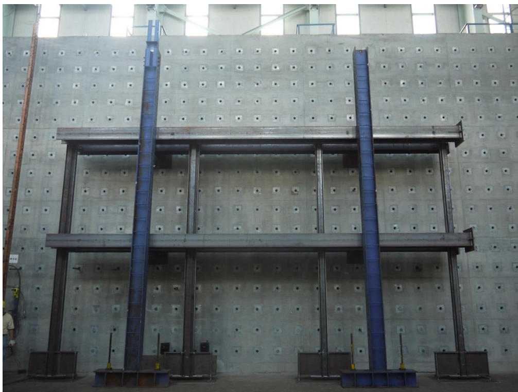
圖 C-48 構架側向支撐組立完成照
