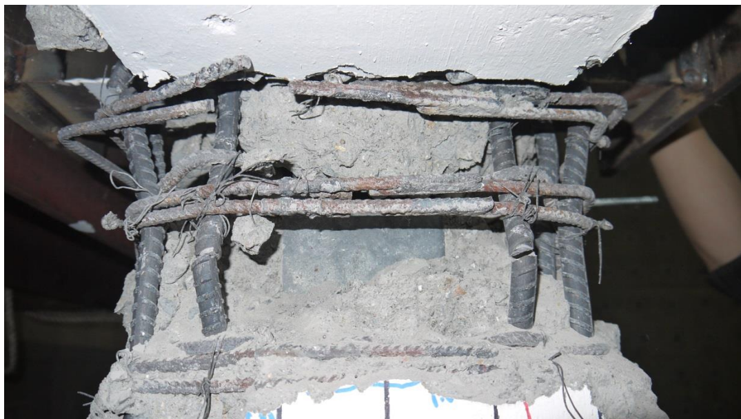
圖 4- 65 柱編號 2Cd_1 於整體反覆載重試驗結束時柱頂破壞情形 (資料來源：本研究拍攝)
