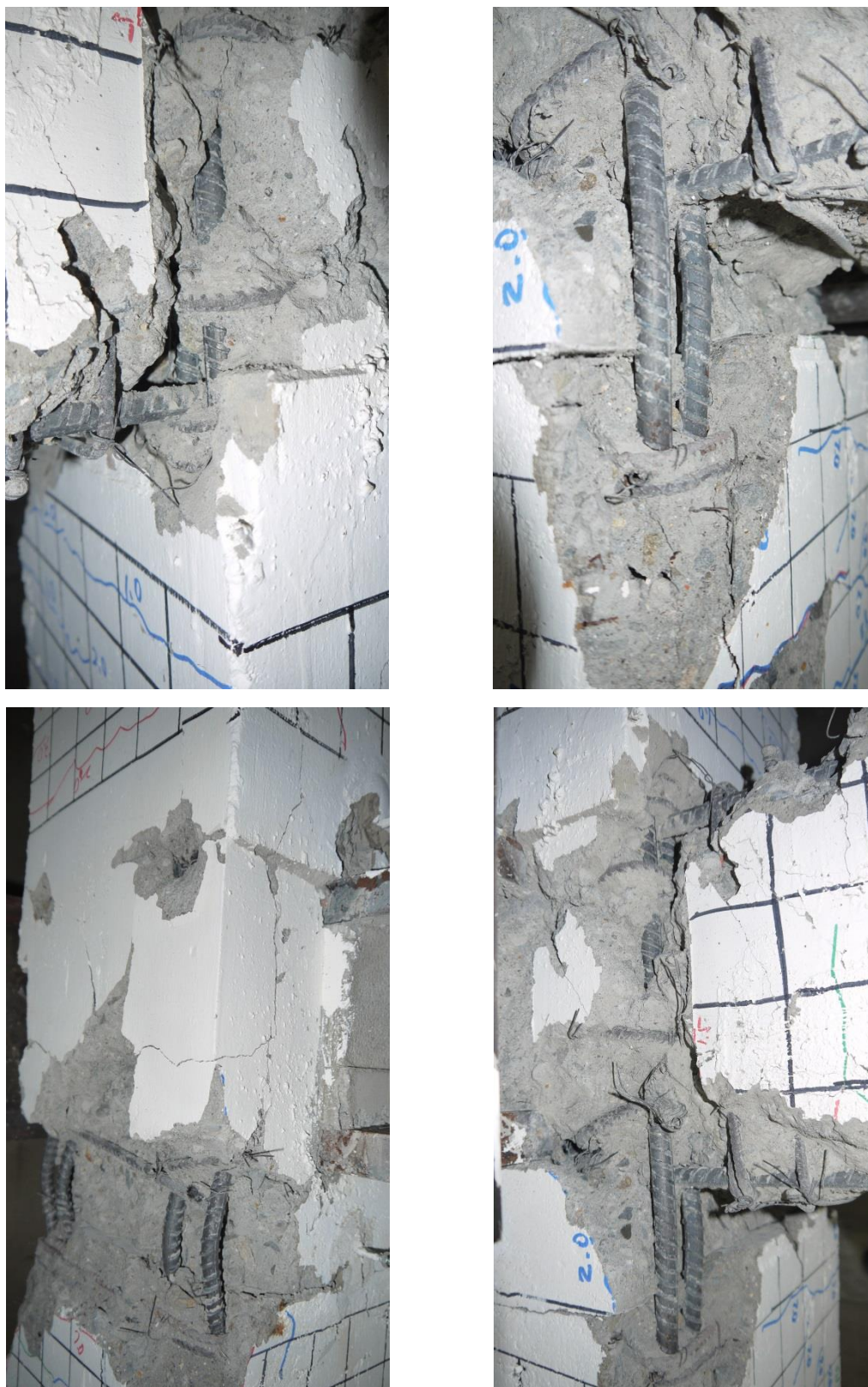
圖 F-26 構架試體第二層柱編號 2C_{s2} 於實驗結束後之破壞情形
