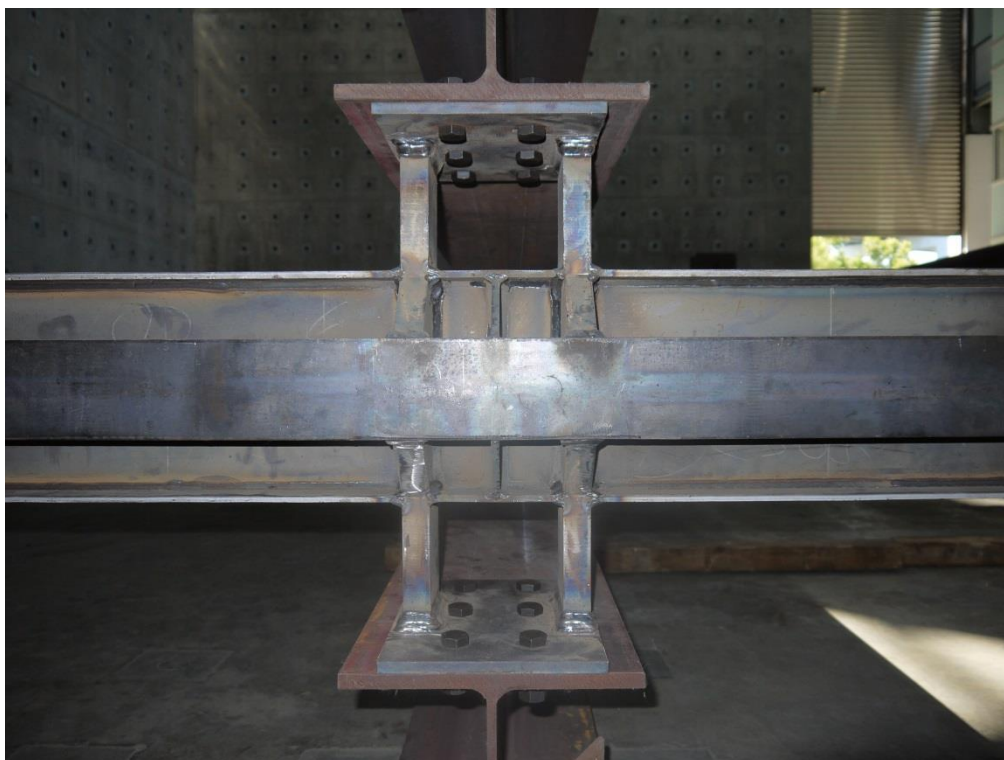
圖 C-35 鋼柱與夾具梁螺栓接合細部
