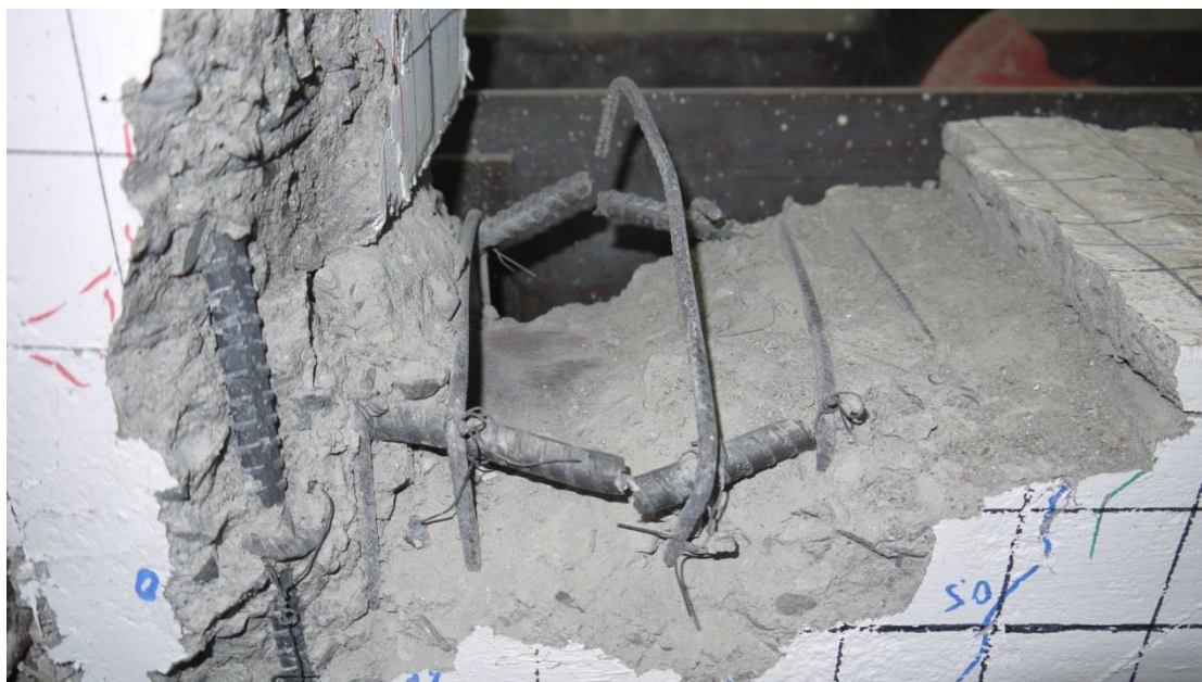
圖 F-20 構架試體第二層梁編號2B3之梁頂於實驗結束後之破壞情形 (資料來源：本研究拍攝)
