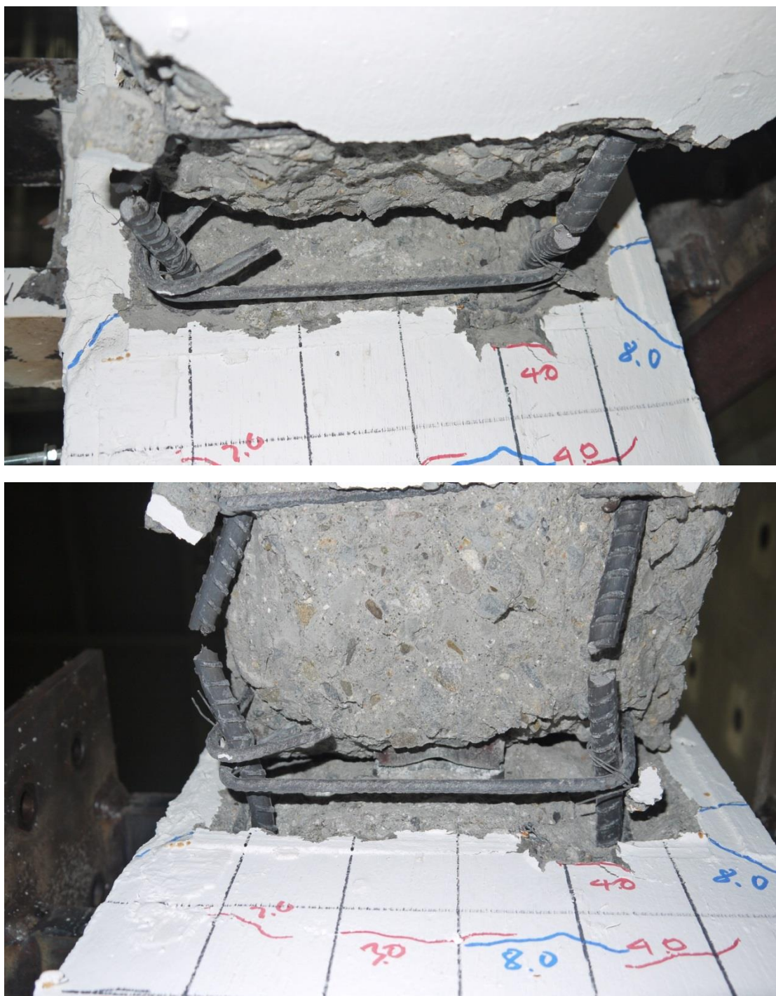
圖 F- 22 構架試體頂層梁編號RB3之梁底於實驗結束後之破壞情形 (資料來源：本研究拍攝)
