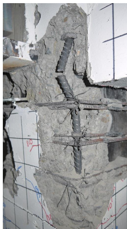
圖 F-23 構架試體第二層柱編號 2Cd_1 柱於實驗結束後鋼骨翼板挫屈之情形 (資料來源：本研究拍攝)
