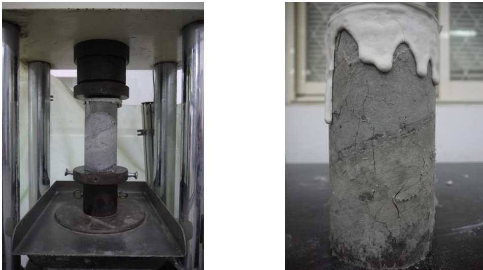
圖 4-1 混凝土圓柱試體加載與破壞情形
