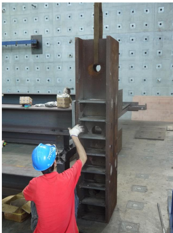
圖 C-37 試體與 200 噸 Actuator 轉接小梁之定位照
