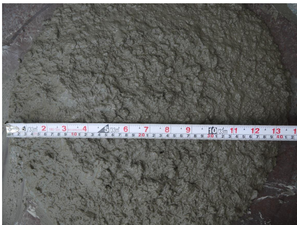
圖 C-91 自充填混凝土坍流度試驗結果(坍流度 40 公分，現場澆鑄採取震動搗實)
