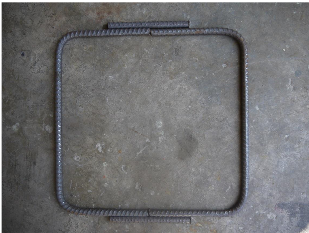
圖 C-57 柱箍筋鐸接示意圖
