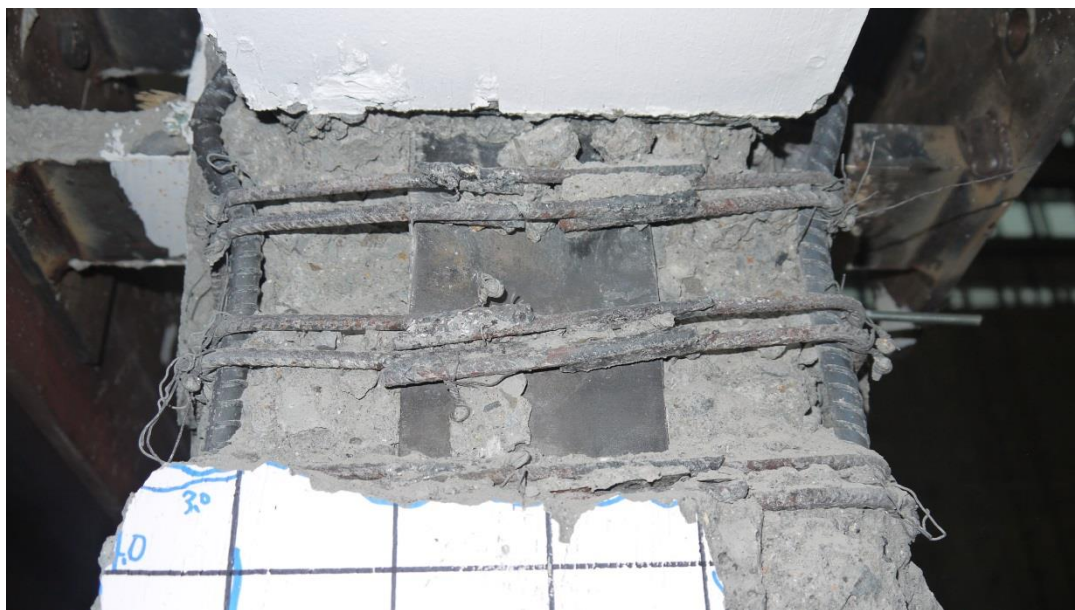
圖 4- 66 柱編號 2Cd_1 於整體反覆載重試驗結束時柱頂破壞情形 (資料來源：本研究拍攝)
