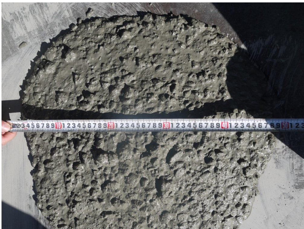
圖 C- 52 自充填混凝土坍流度試驗結果(坍流度 50 公分)
