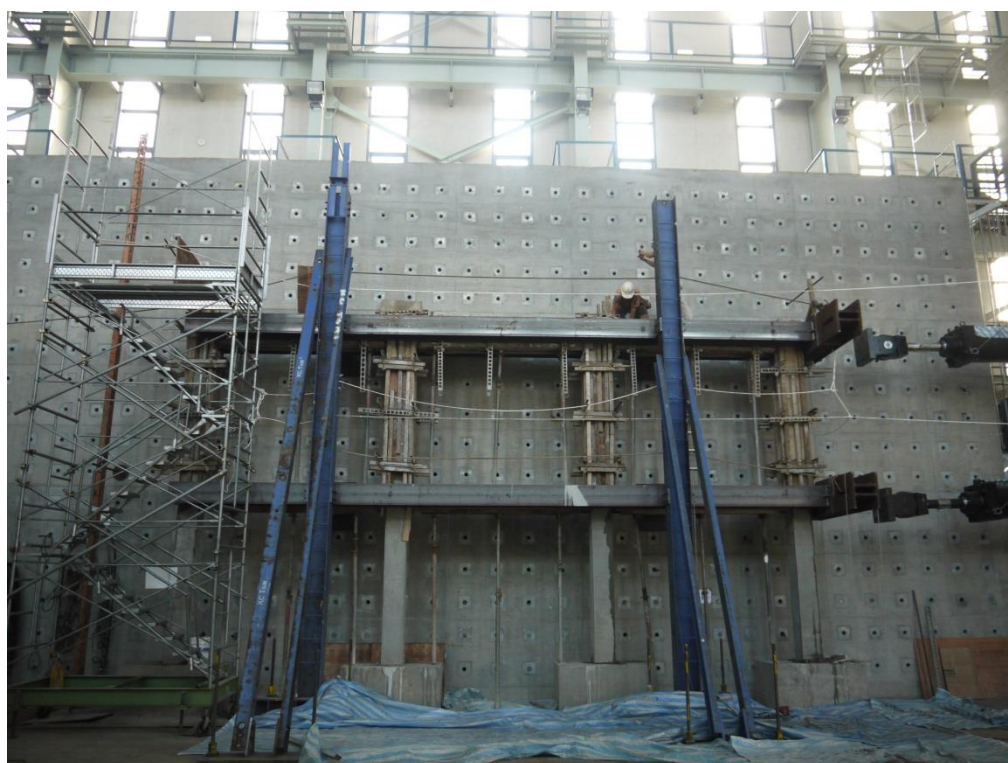
圖 C-95 構架試體製作完成(待 14 天後拆除模板)
