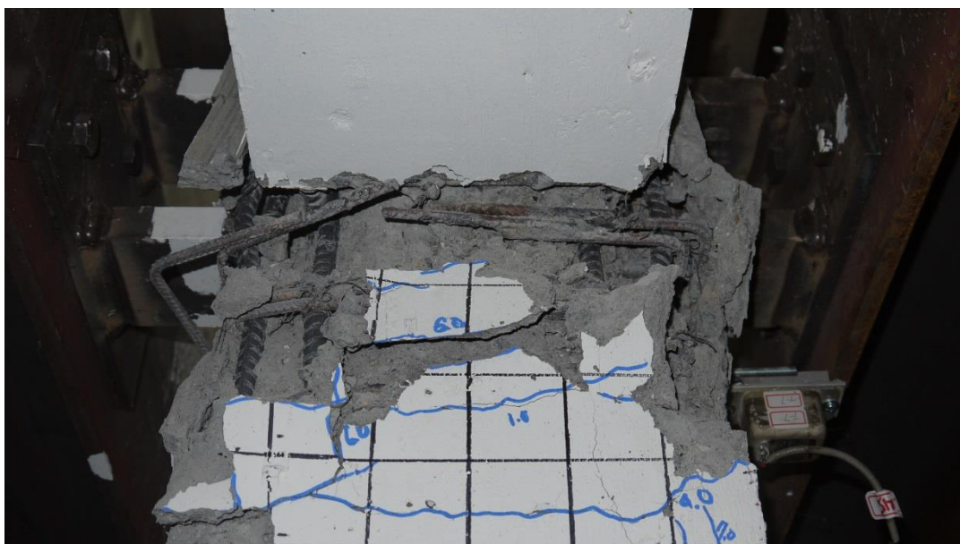
圖 4-26 柱編號 2C_{s1} 於位移比 0.25%時柱頂箍筋斷裂情形
