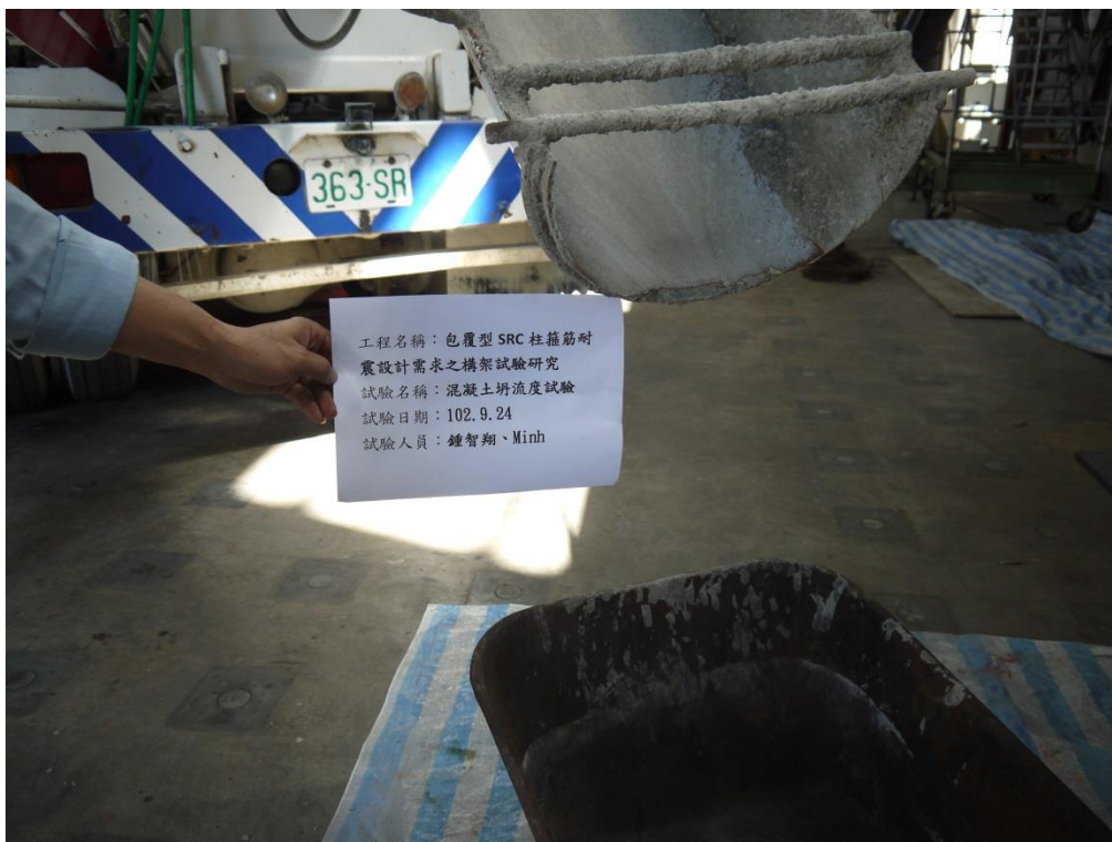
圖 C-76 自充填混凝土取樣照(一樓混凝土)
