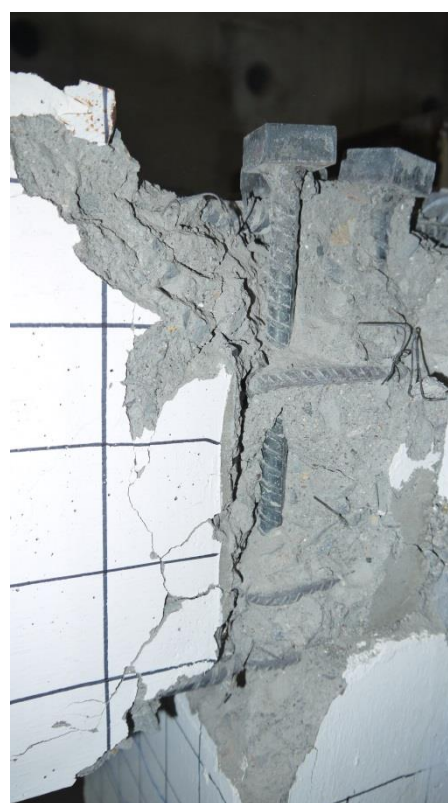
圖 F-27 構架試體頂層梁編號RB1之梁頂於實驗結束後之破壞情形 (資料來源：本研究拍攝)
