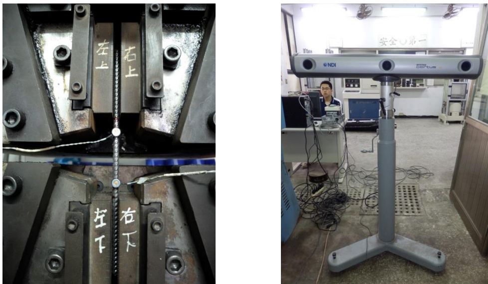
圖 3-7 拉力試驗與其量測位移系統之架設情形
