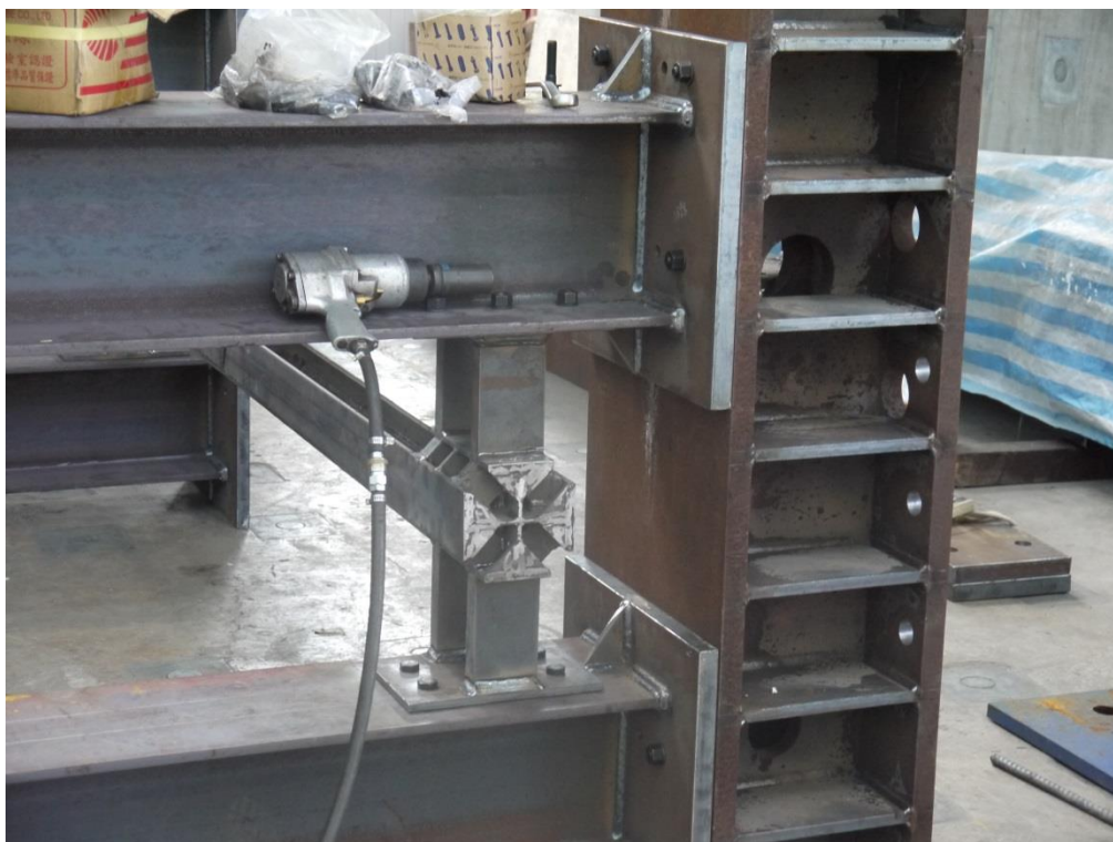
圖 C-38 試體與 200 噸 Actuator 轉接小梁栓接完成照
