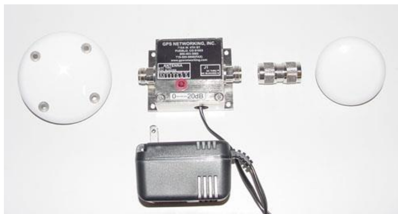
圖 2.7 雙頻雙系統載波相位觀測量室內播放工具
