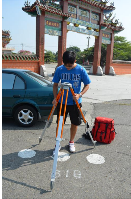
圖 6.5 UAV 航拍前架設 GPS 基站於點號 B18 之情形
