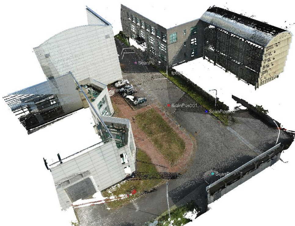
圖 2.23 地面光達掃描及拼接後成果 3D 透視圖
