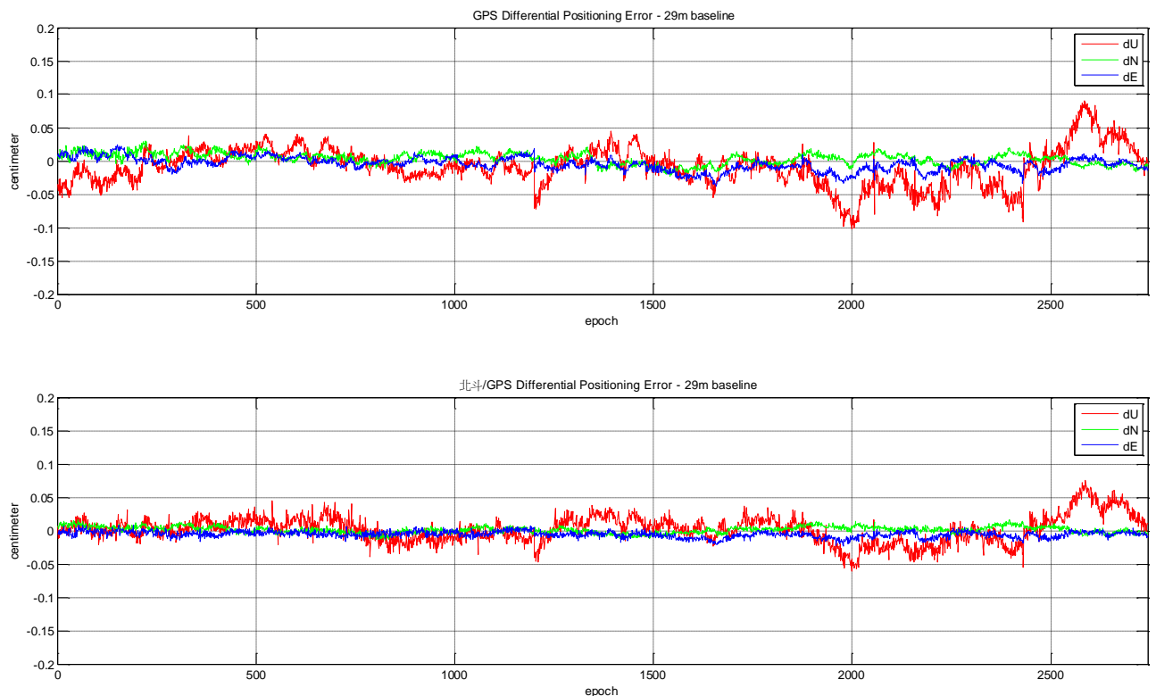
圖 4.22 使用 GPS 單系統(上)及北斗/GPS 雙系統(下)動態精密相對定位於 29 公尺基線在三個方向上與已知座標不符值之時間序列圖
