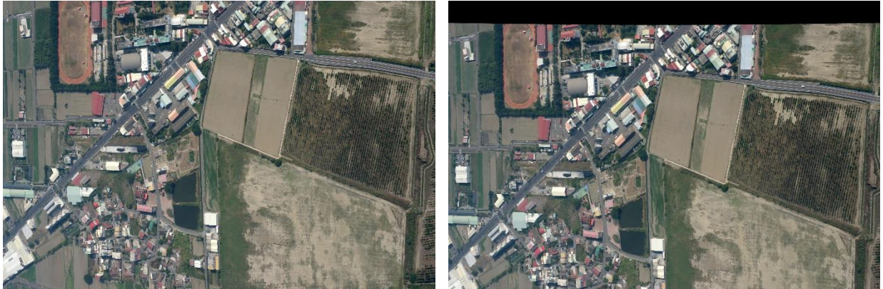
圖 6.11 Cam2 內方位修正前(左)與後(右)之比較
