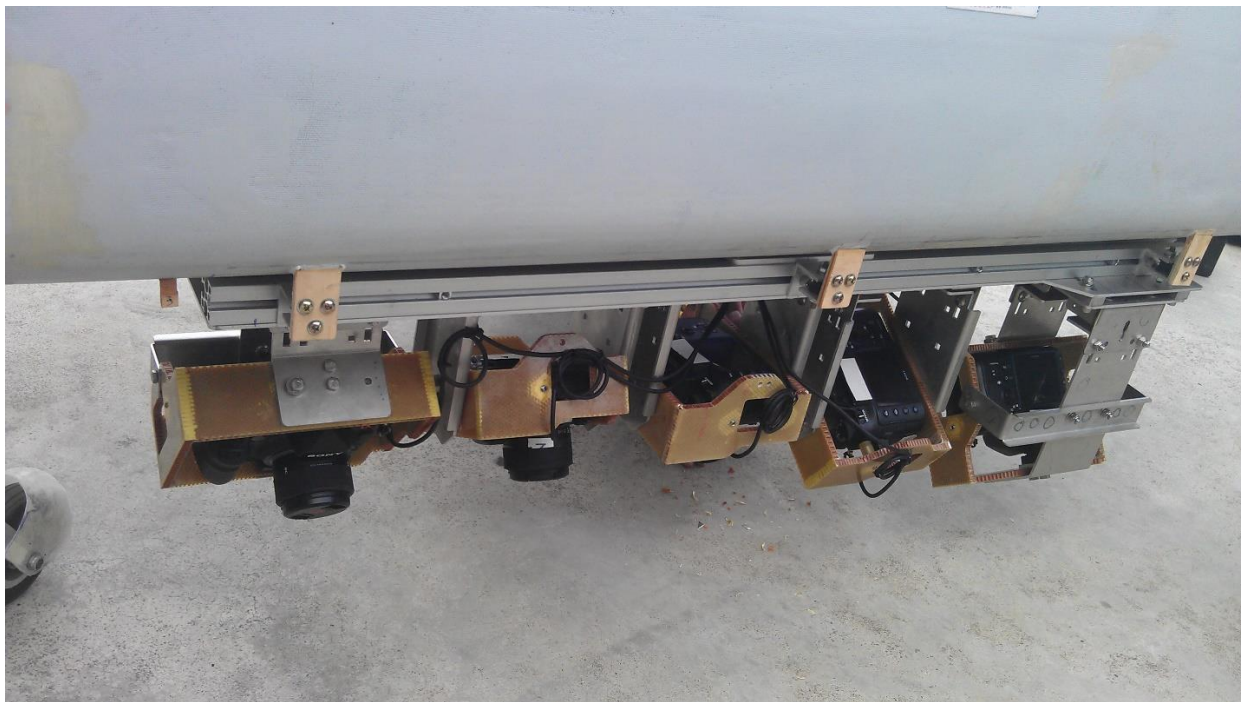
圖 6.1 五相機攝影系統 (© 成大饒見有/日成航太)
