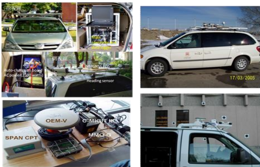
圖 2.14 專業動態測試平台（車載）
