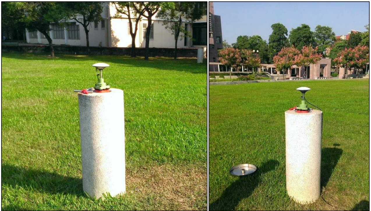
圖 4.9 架設於國立成功大學測量及空間資訊系館後方草皮上基樁的多頻多系統衛星接收儀
