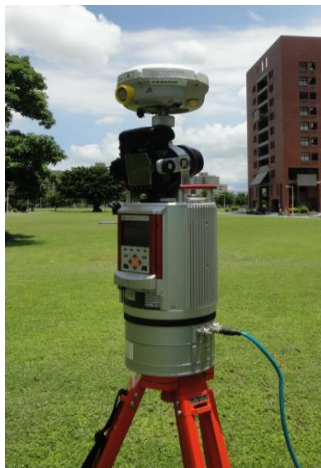
圖 2.32 GPS 天線透過轉接頭裝置在掃描儀上方
