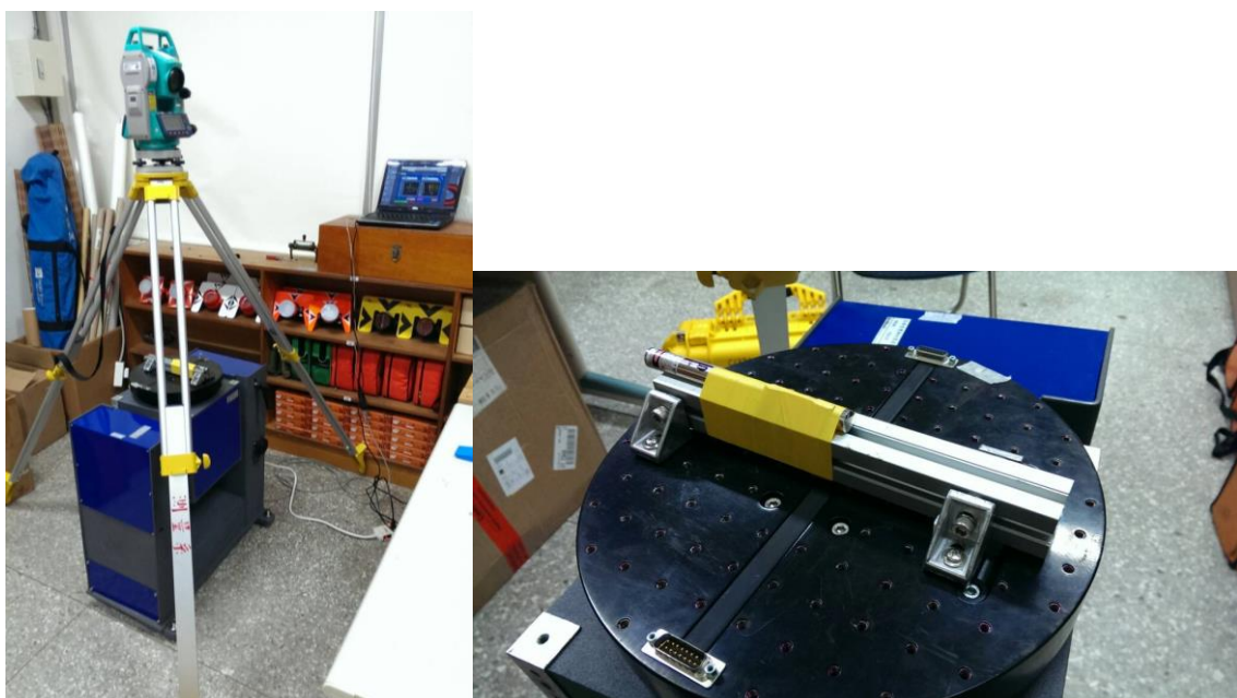
圖 2.9 轉台驗證實驗過程示意圖
