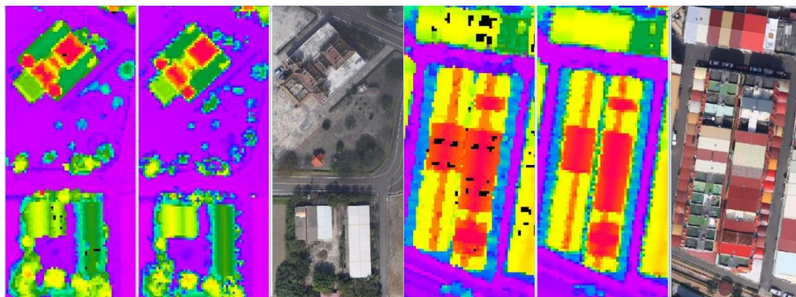
圖 7 (左)UAV 產製之 DSM、(中)空載光達產製之 DSM、(右)真實正射影像
