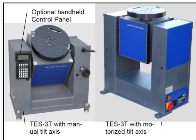
圖 2.8 採購之高精度雙軸位置速率轉台
