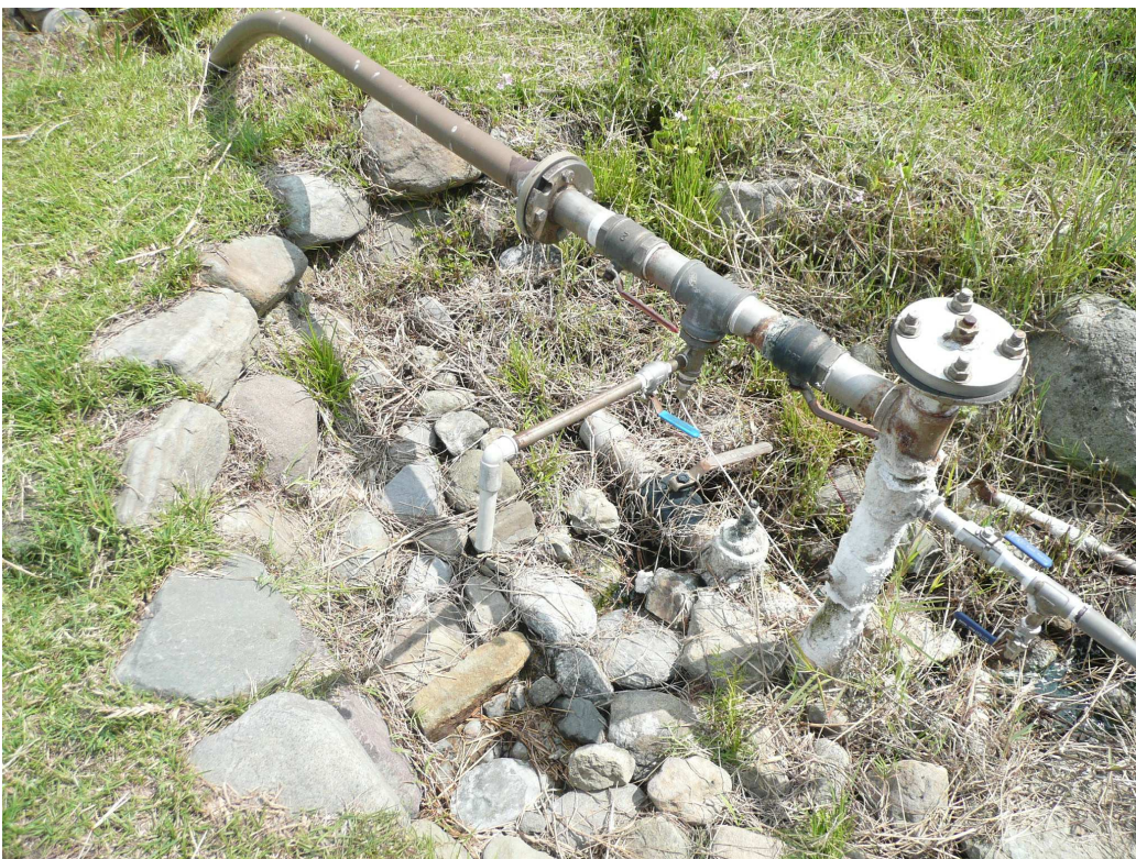
圖 7-17：安通站 500 米自流井（樣本採樣口與 PT100 溫度計放置處）。
