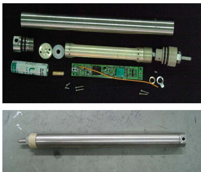
圖 4-2 小型熱探針機殼及內部零件(上圖)和外觀(下圖)。
