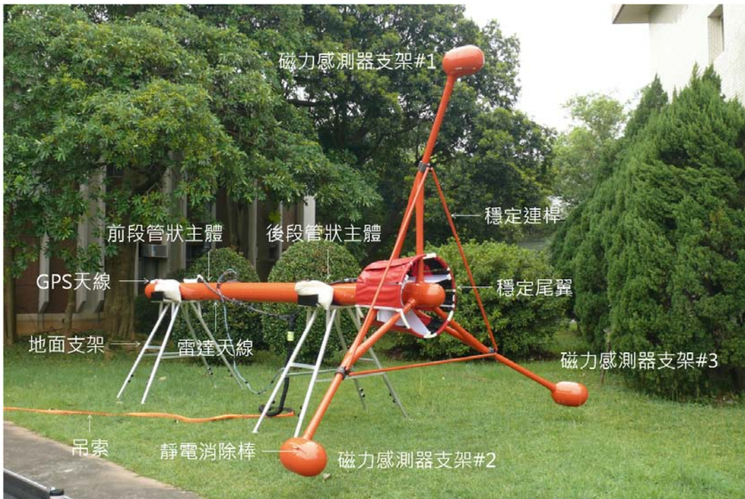
圖 4-2：三軸拖鳥組裝完成後照片及各部組件名稱
