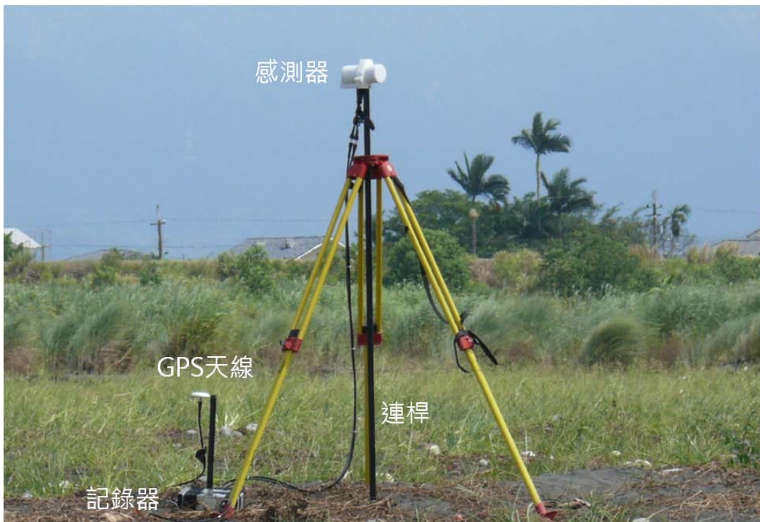
圖 4-3：移動式地面磁力儀組裝完成後照片及各部組件名稱
