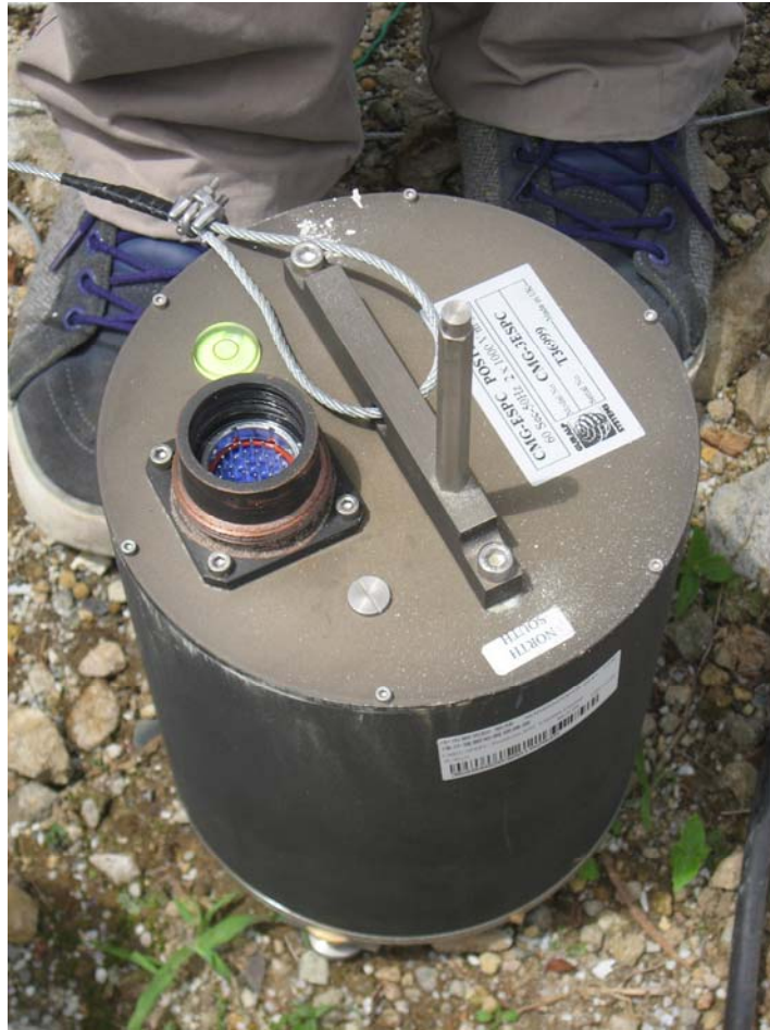
圖 45 井下地震儀之外觀。(a) 記錄器；(b) 感應器。
