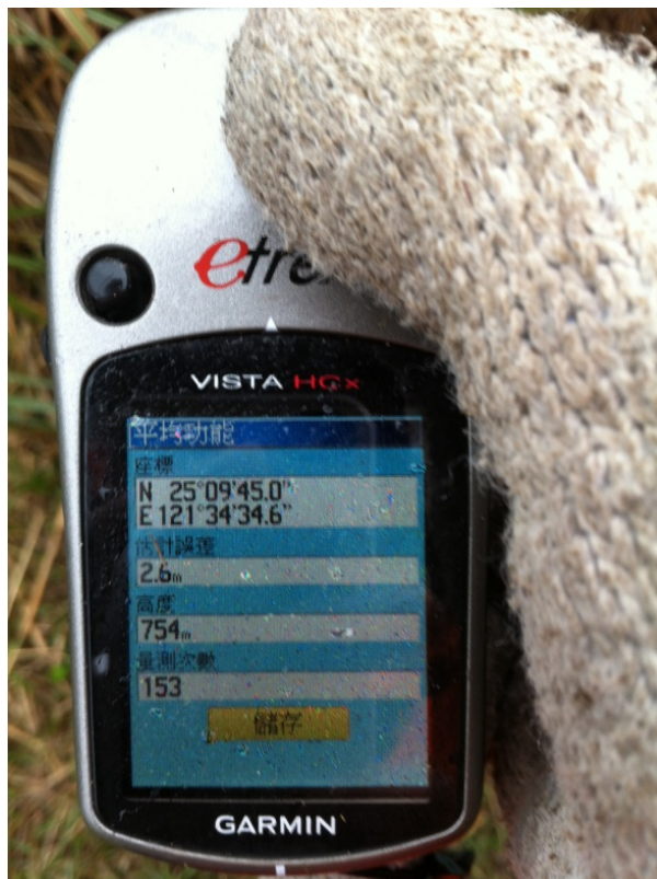
圖70 利用掌上型GPS量測每個測點位置。
