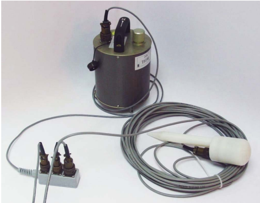
圖 12 英國 Guralp 公司所製 CMG-6TD 中長週期速度型地震儀(感應器與記錄器)。
