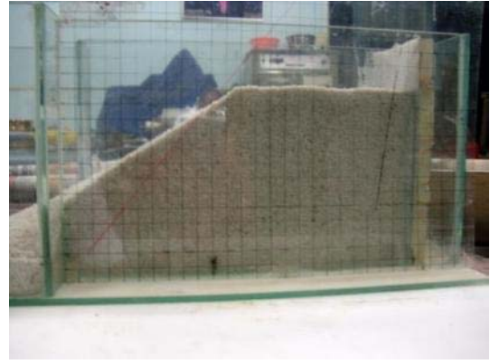
(d) 測量滑落砂面角度
