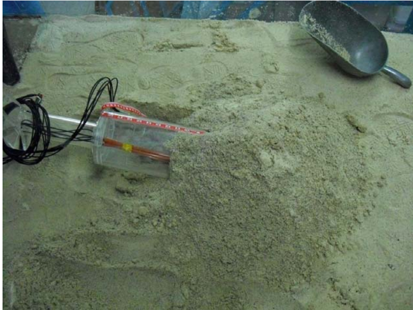
圖 3.49 壓力感測計垂直土壓訊號測試實景
