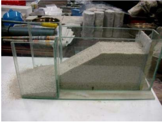
(c) 抽開擋版使砂土自然滑落
