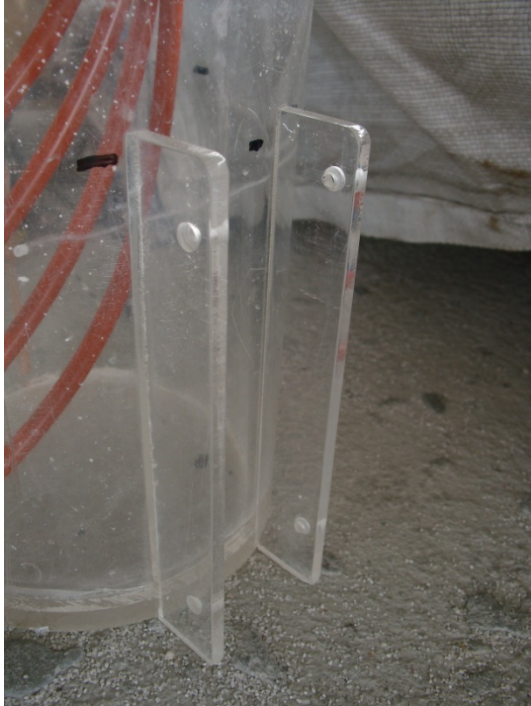
圖 3.28 沖刷振動感測計於試體之裝設
