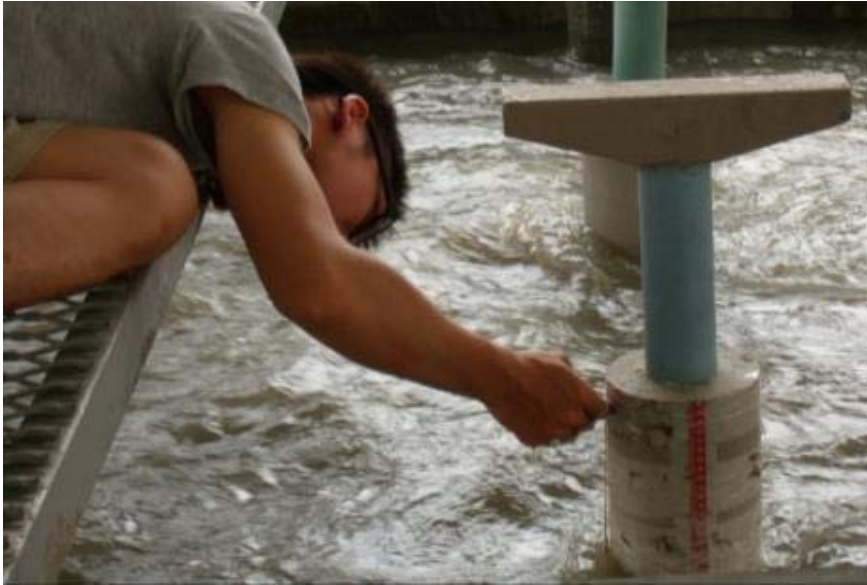
圖 5.11 以鉛錘即時量測沖刷深度實景
