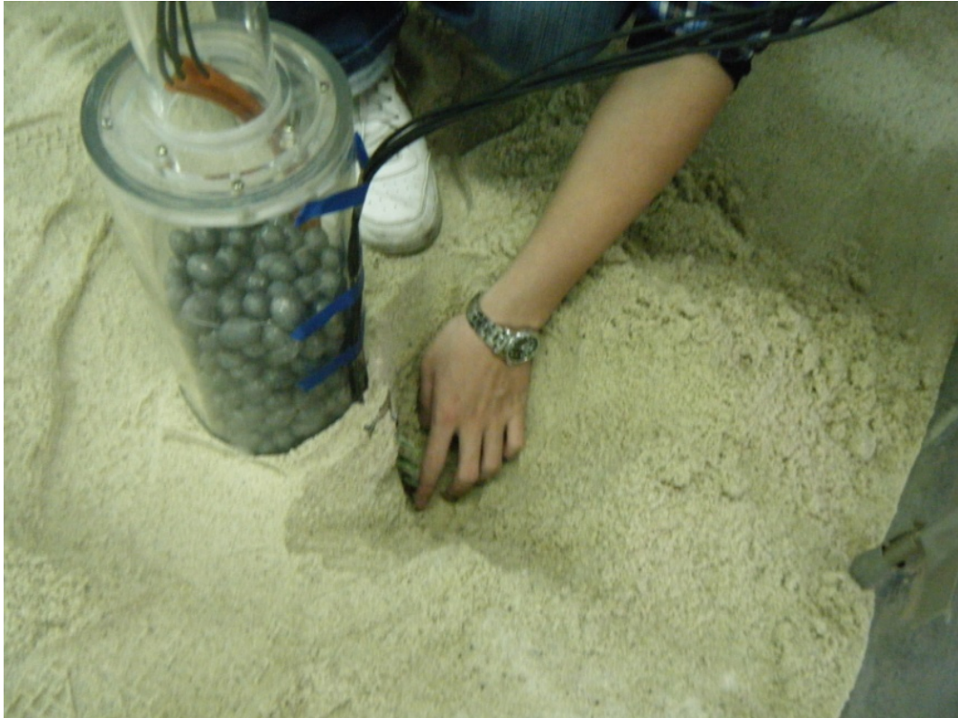
(a) 沖刷振動感測計埋設
