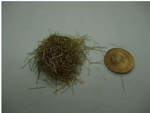
(c) 預拌材摻料鋼纖維
