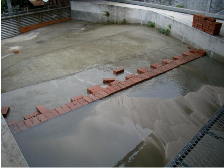
圖 5.5 砂土受阻於擋水堰前情形
