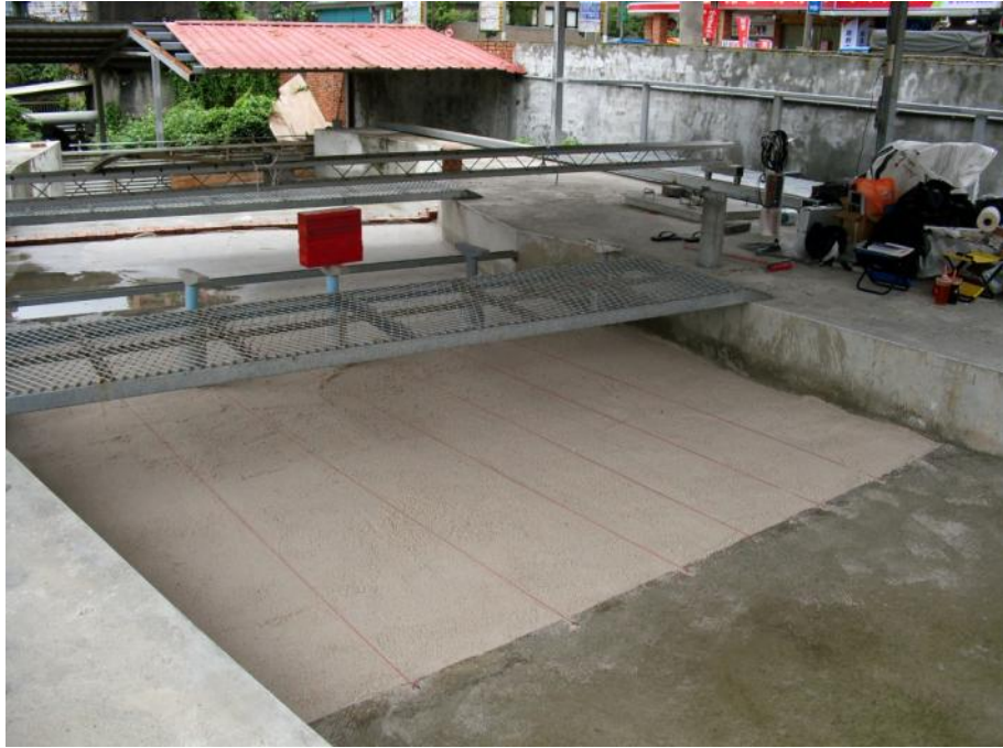
圖 5.2 單墩沖刷試驗配置
