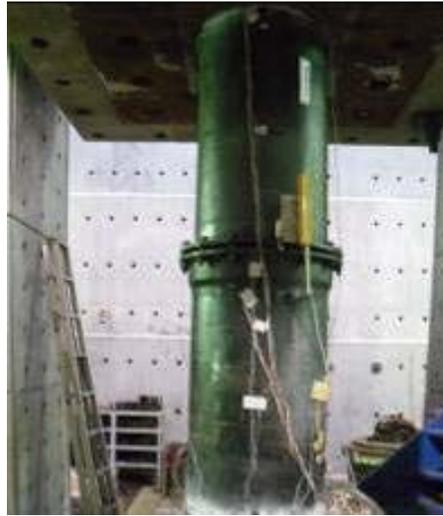
圖3.47 DN600 抗壓試驗初期
