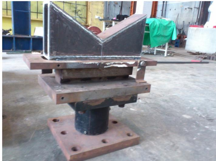
圖2.25 下部夾具-roller 設計與接合圖
