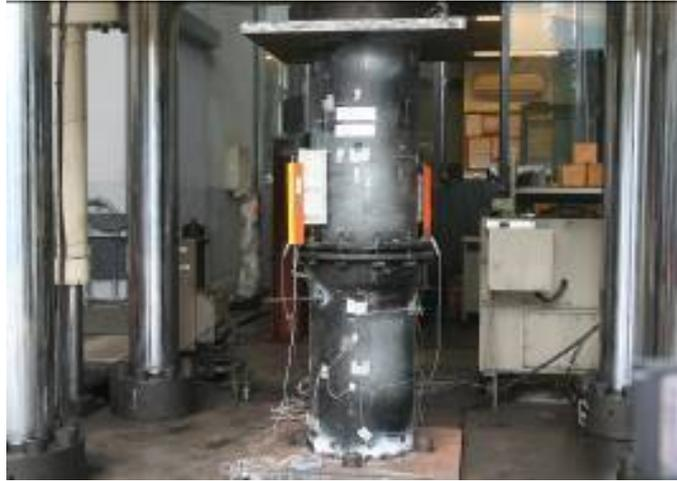
圖3.44 DN400 抗壓試驗初期
