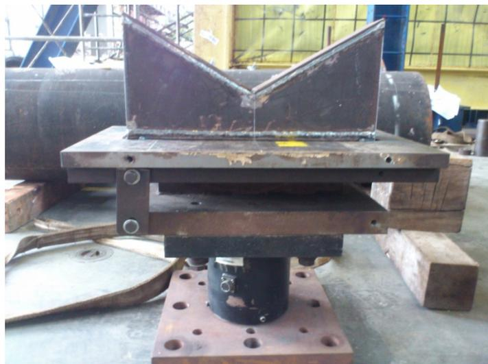
圖2.24 下部夾具-hinge 設計與接合圖
