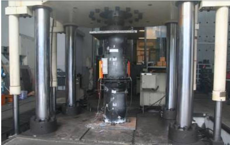
圖2.18 五百噸材料試驗機
