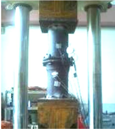
圖3.41 DN200 抗壓試驗初期
