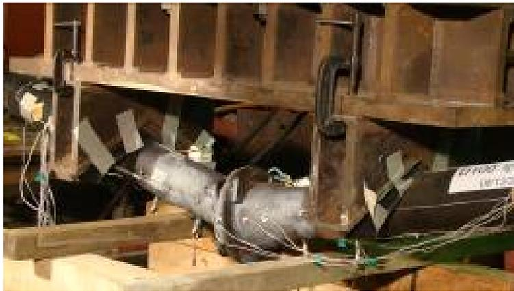
圖3.100 DN100 彎矩試驗完成
