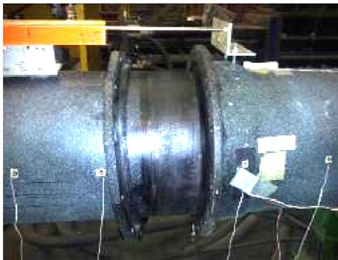
圖3.18 DN400 抗拉試驗完成
