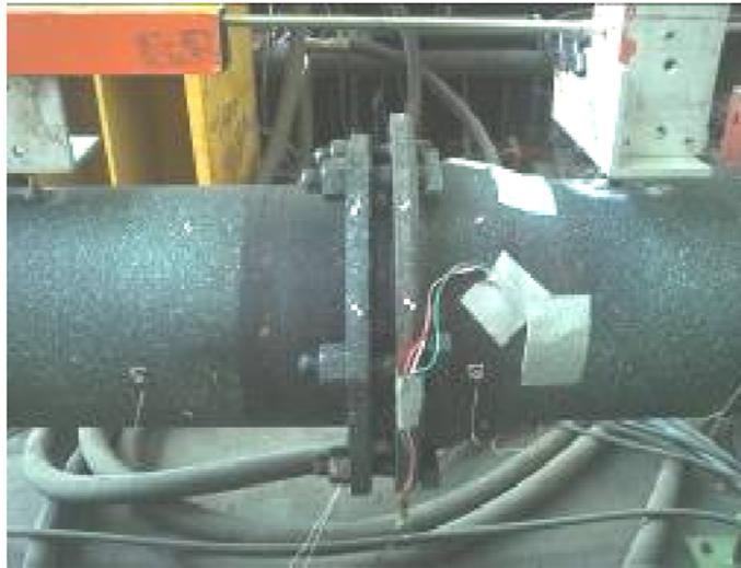
圖3.14 DN200 抗拉試驗中期
