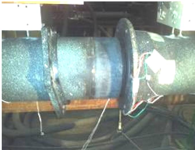
圖3.15 DN200 抗拉試驗完成
