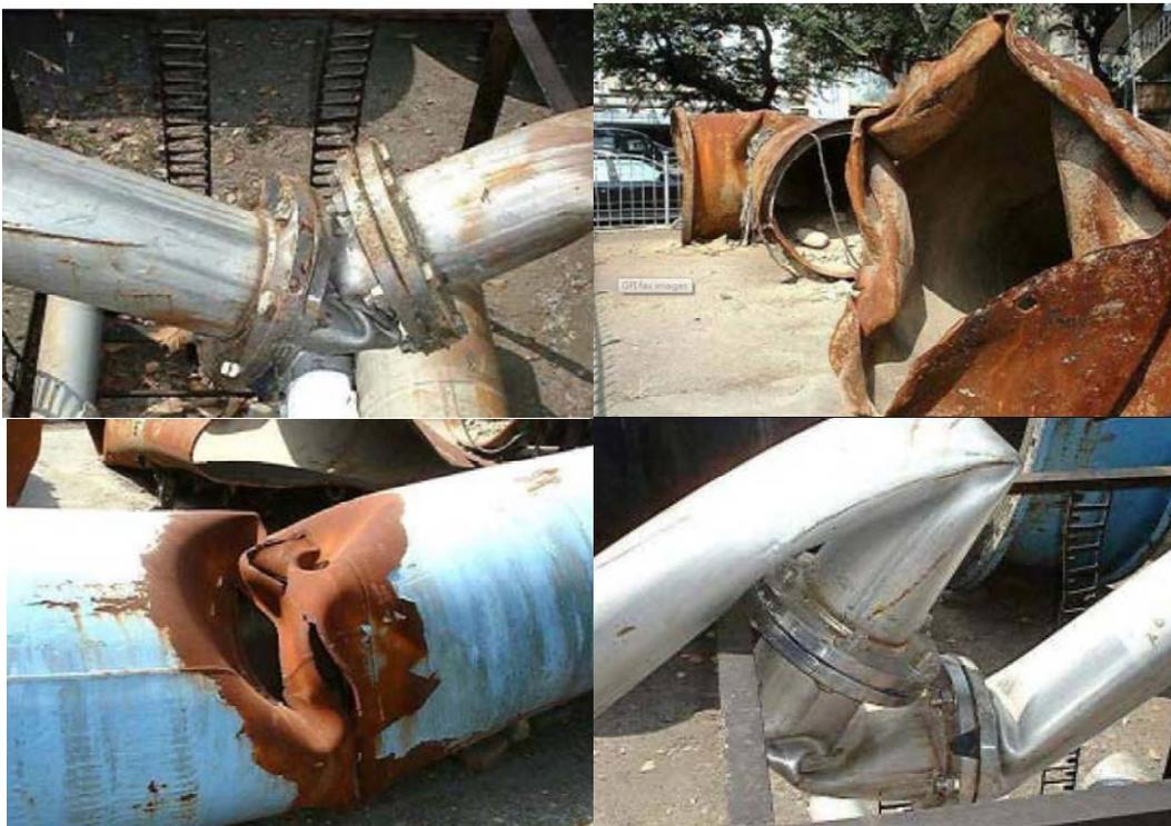
圖1.3 自來水管線局部挫屈[3]
