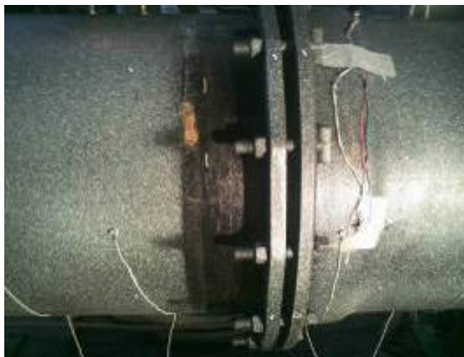
圖3.21 DN600 抗拉試驗完成
