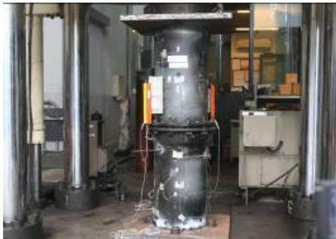
圖3.46 DN400 抗壓試驗完成
