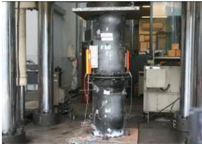
圖3.45 DN400 抗壓試驗中期
