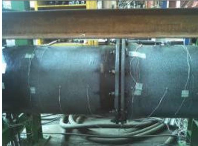
圖3.19 DN600 抗拉試驗初期
