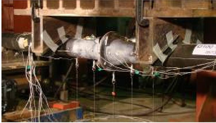
圖3.98 DN100 彎矩試驗初期
