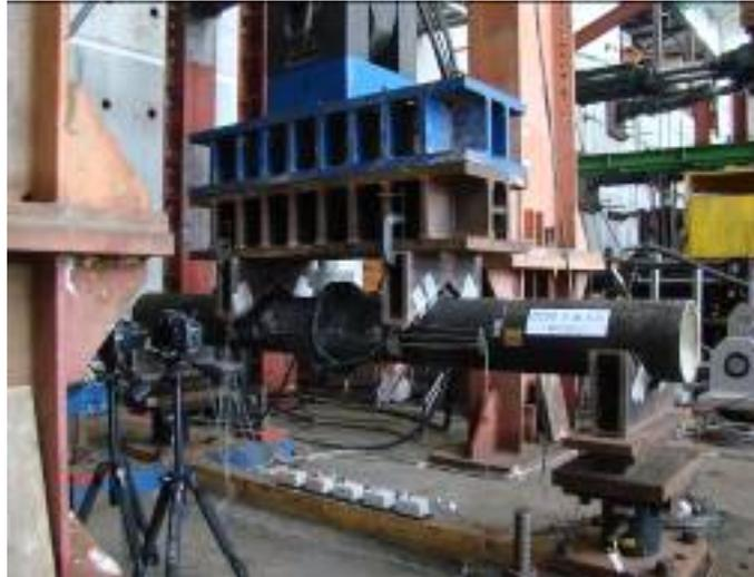
圖3.101 DN200 彎矩試驗初期
