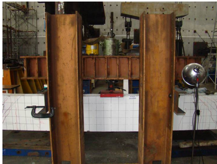
照片 4-2 拉拔試驗配置圖
