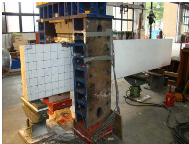
照片 4-1 CCT 節點試驗配置圖
