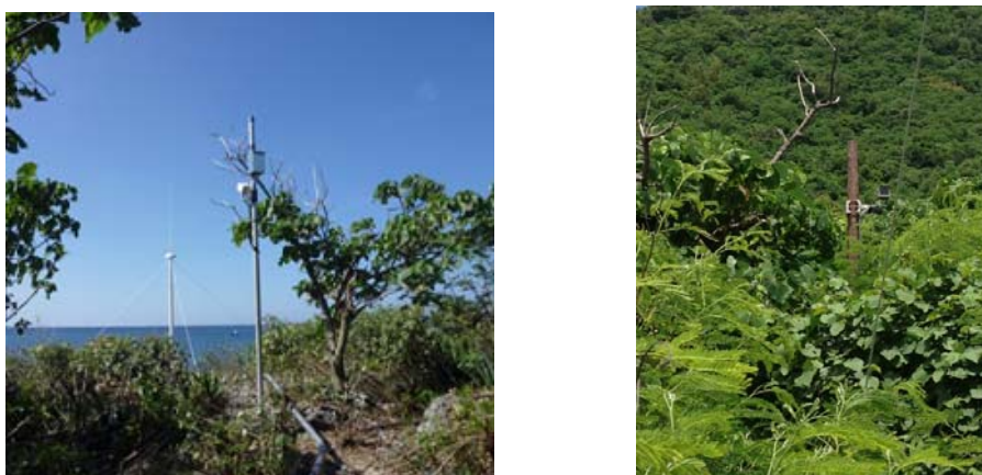
圖 1-1.3 屏東後灣站監視器支撐架更改成木製支撐架
