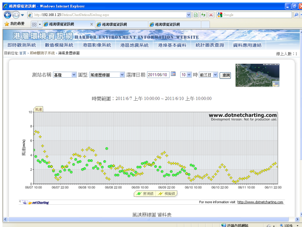
圖 2.26 海氣象歷線圖/資料表(以基隆港 風速歷線圖為例)
