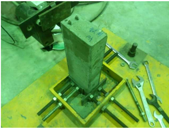
圖 3.7 以螺絲系統將 RC 柱鎖死於底板上
