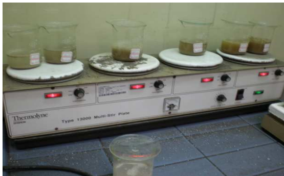
圖 4.9 混凝土粉末浸泡於蒸餾水煮沸
