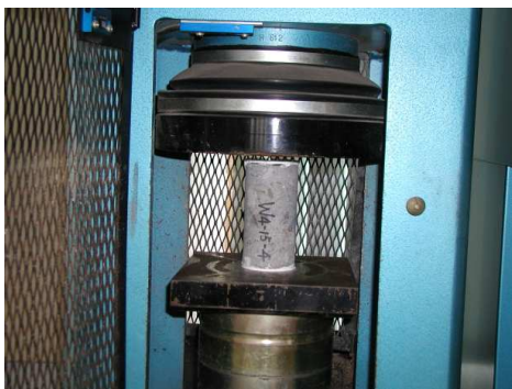
圖 4.7 試體之抗壓試驗
