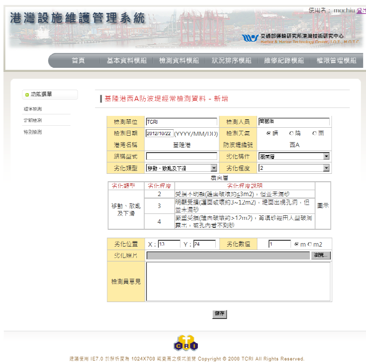
圖 2.15 防波堤檢測資料新增頁面
