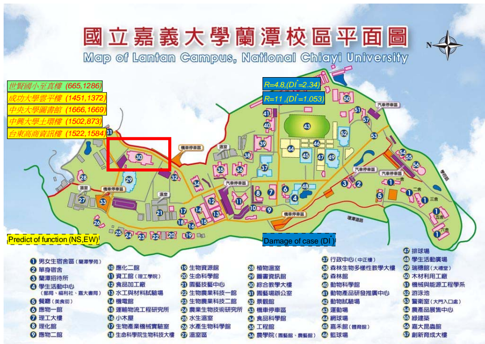
圖 25 嘉義大學蘭潭校區綜合大樓於 2500 年回歸期人工地震之 最大加速度預估與震損預估圖
