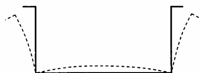
圖 C-6.2-6 U 型斷面梁之側向挫屈
