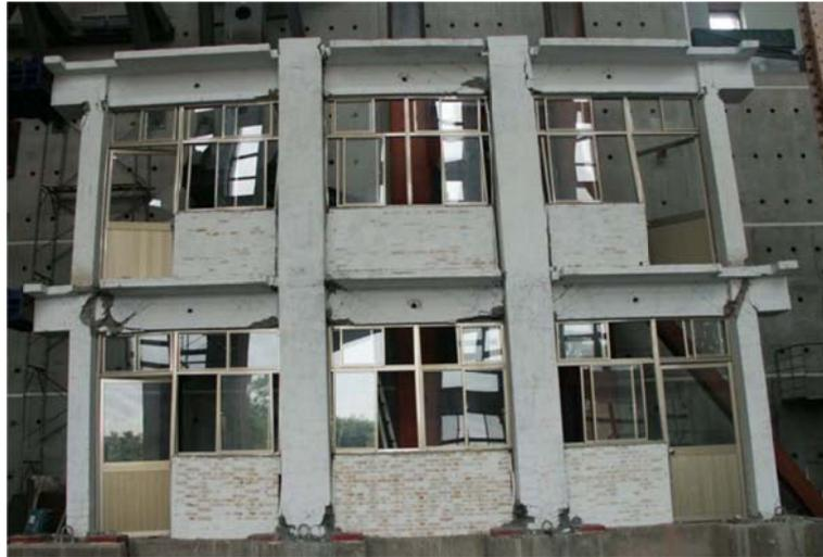
圖 4.26 SBFU-C 補強試體實驗最終破壞情況
