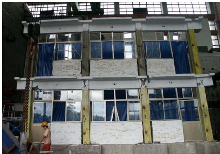
圖 4.12 SBFS 補強試體實驗最終破壞情況
