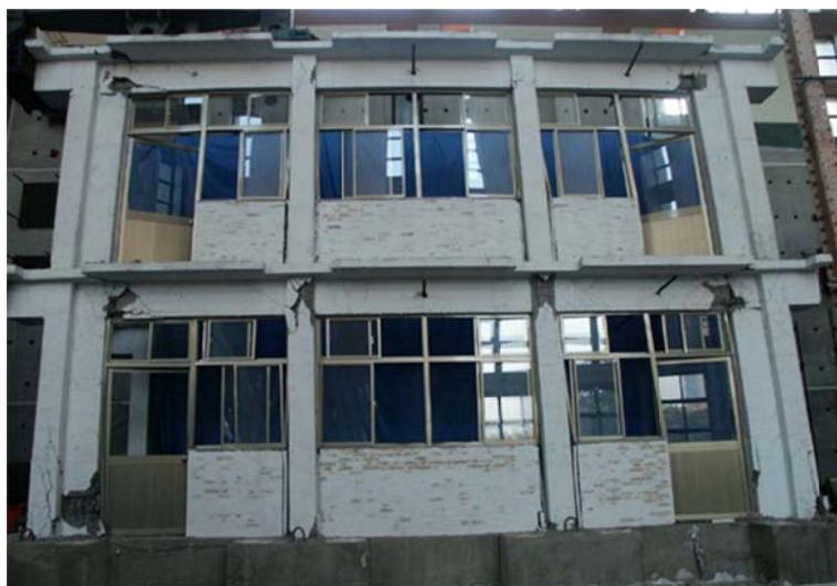
圖 4.41 SBFW 補強試體實驗最終破壞情況
