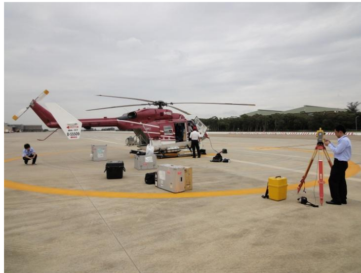
圖 3-3 經緯儀量測感測器與 GPS 天線的偏心率率定圖
