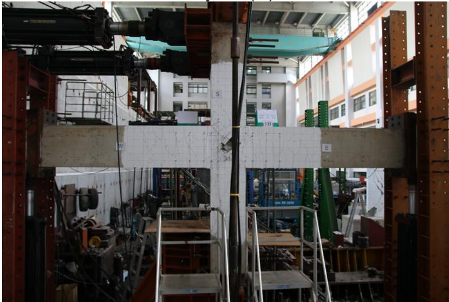
圖 4-3 試體 1B 之遲滯迴圈與層間變位 3% 照片 (資料來源：本研究製作)
