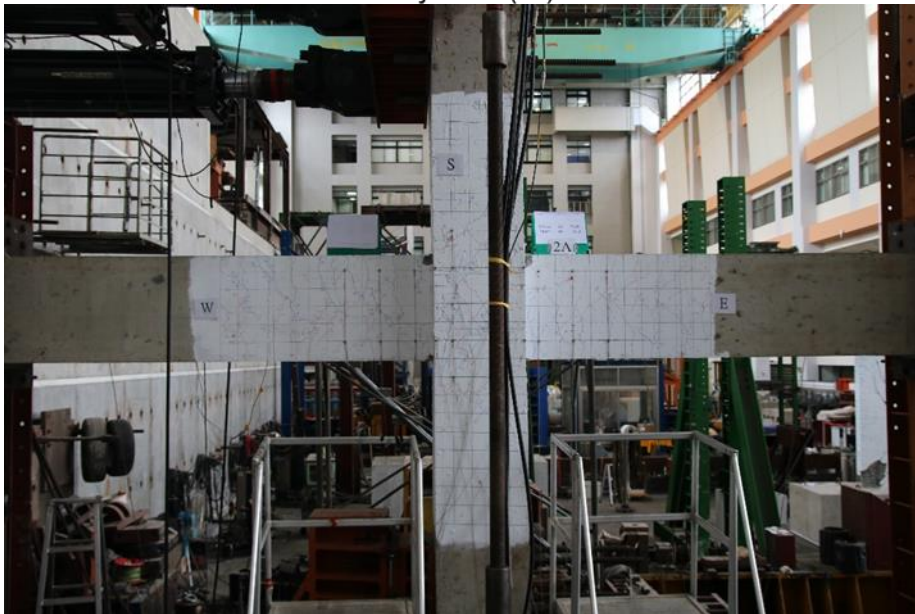
圖 4-9 試體 2A 之遲滯迴圈與層間變位 3% 照片 (資料來源：本研究製作)
