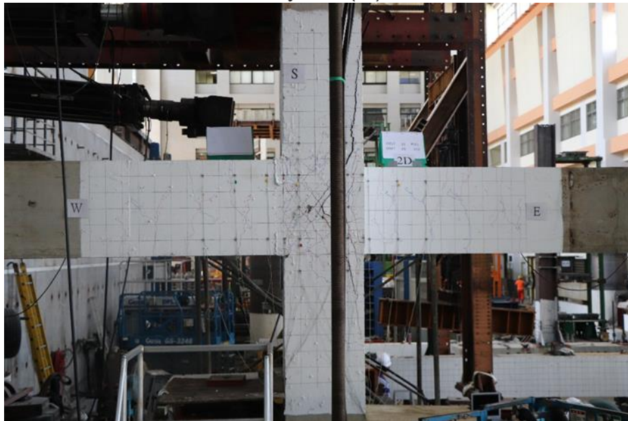
圖 4-15 試體 2D 之遲滯迴圈與層間變位 3% 照片 (資料來源：本研究製作)
