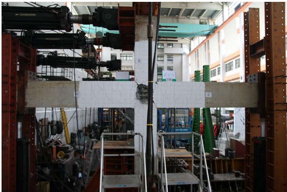
圖 4-4 試體 1B 層間變位 4%、6% 照片 (資料來源：本研究製作)
