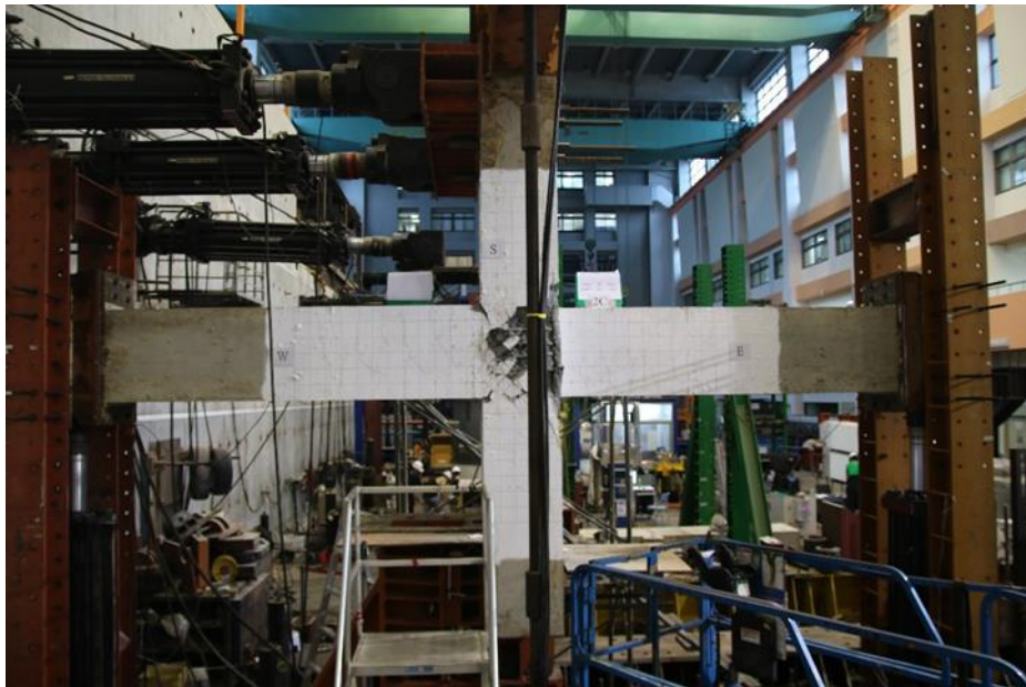
圖 4-14 試體 2C 層間變位 4%、6% 照片 (資料來源：本研究製作)
