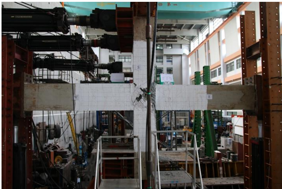
圖 4-6 試體 1C 層間變位 4%、6% 照片 (資料來源：本研究製作)
