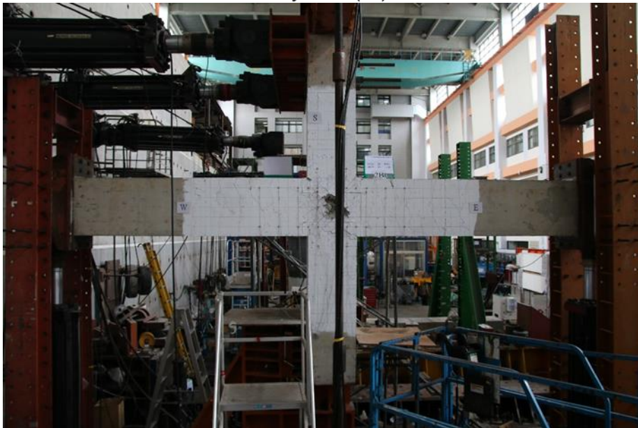
圖 4-11 試體 2B 之遲滯迴圈與層間變位 3% 照片 (資料來源：本研究製作)
