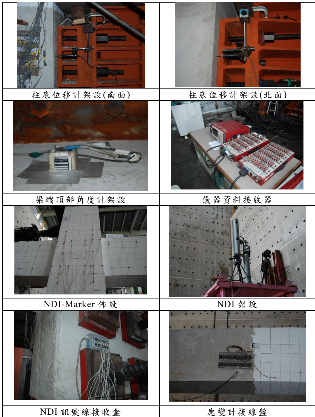
圖 3-12 試驗儀器架設 (資料來源：本研究製作)
