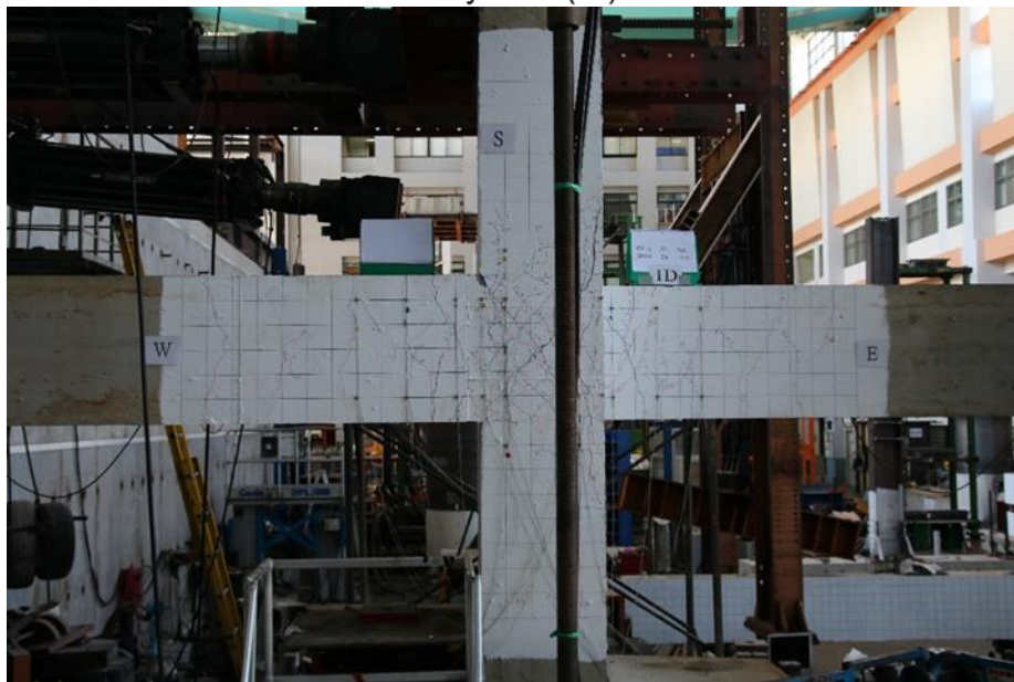
圖 4-7 試體 1D 之遲滯迴圈與層間變位 3% 照片 (資料來源：本研究製作)
