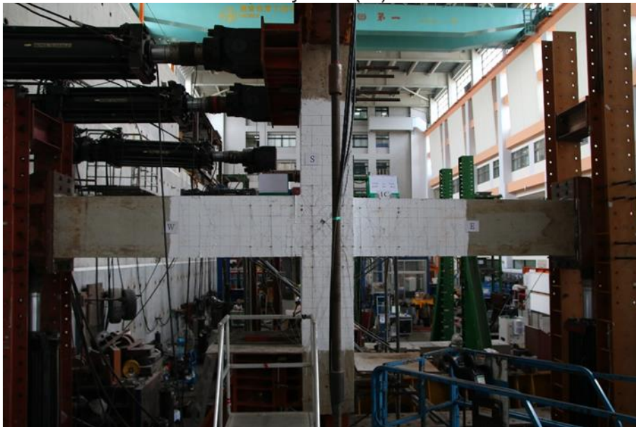
圖 4-5 試體 1C 之遲滯迴圈與層間變位 3% 照片 (資料來源：本研究製作)
