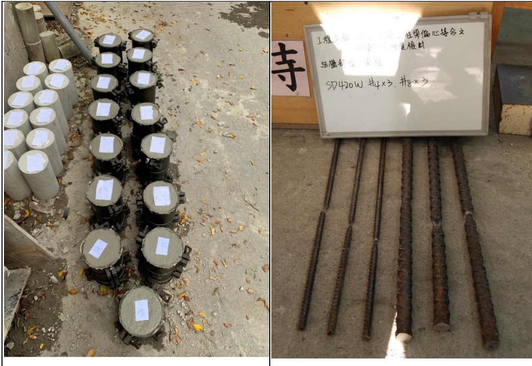
圖 3-6 混凝土抗壓強度試驗用圓柱試體和鋼筋拉伸試樣 (資料來源：本研究製作)
