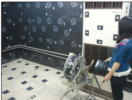
圖 2.62 空載傾斜攝影相機相對方位率定場及拍照情形
