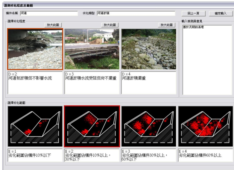
圖 2.20 構件劣化判斷介面
