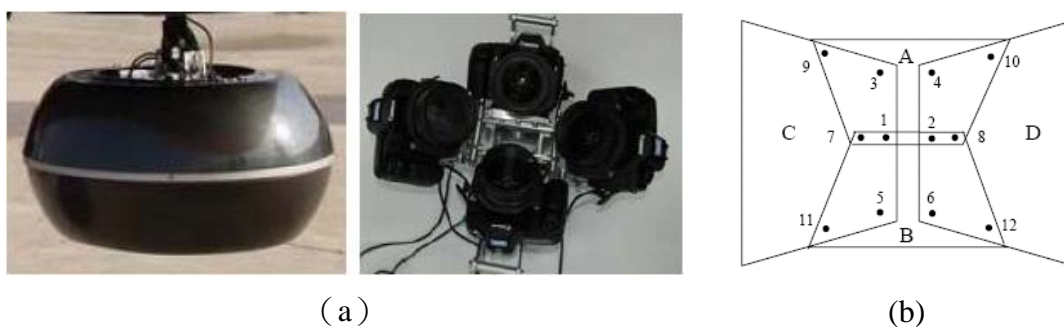
圖 3-15 (a)四顆超廣角鏡頭相機外觀；(b)本例相機之四張影像重疊情形
