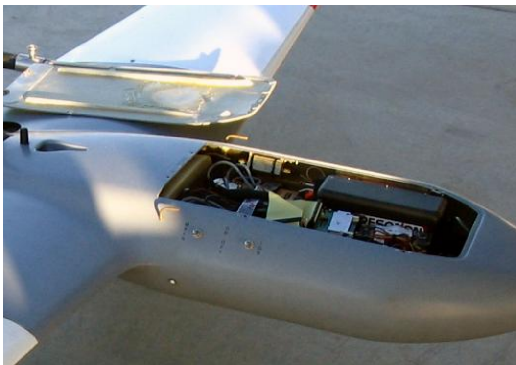
圖 3-36 空載高光譜儀裝備於 Manta UAV 上
