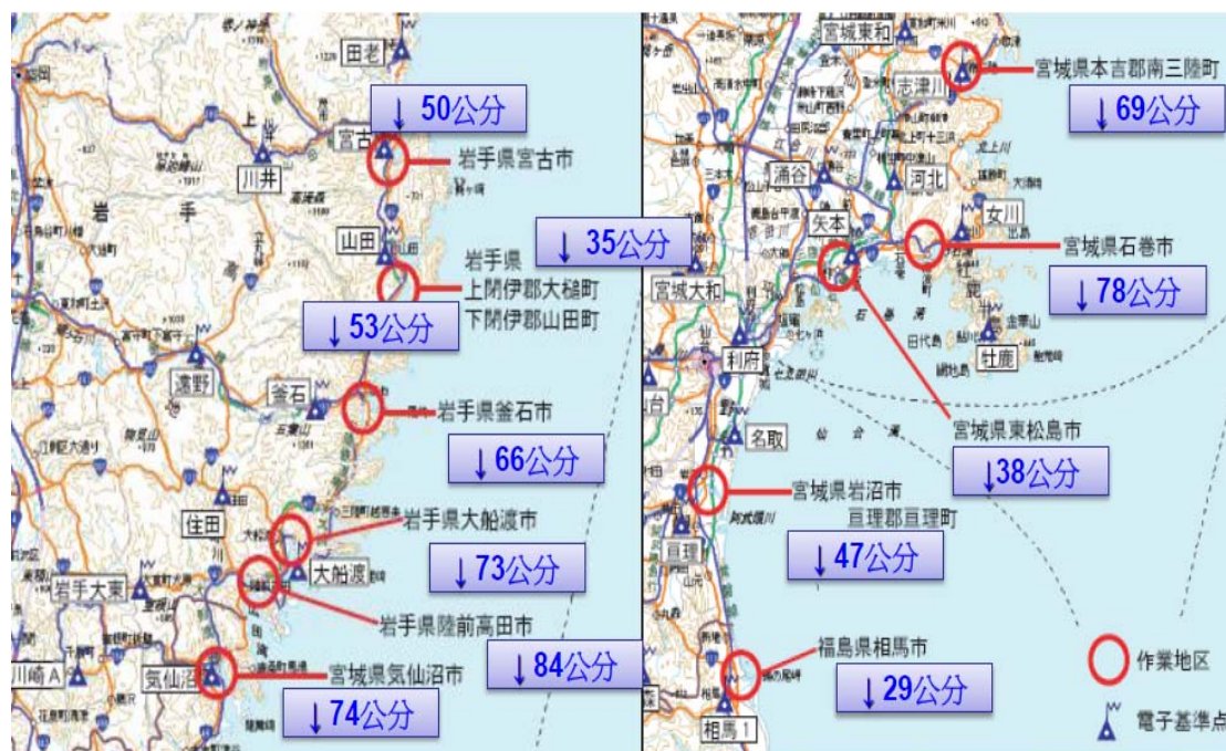
圖 2- 18：日本 311 大地震後，沿海地區下陷情形
