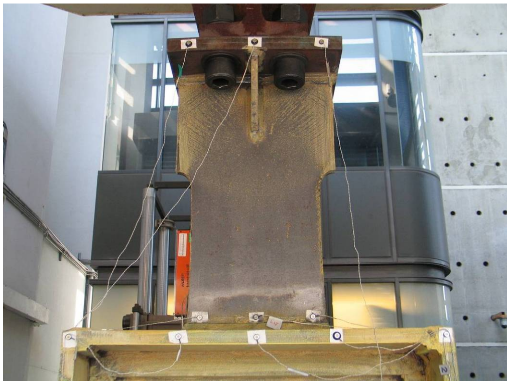
照片 4-4 試體 CC 於試驗位移為 75.8mm 時，上翼板之掉漆情況 (資料來源：本研究製作)
