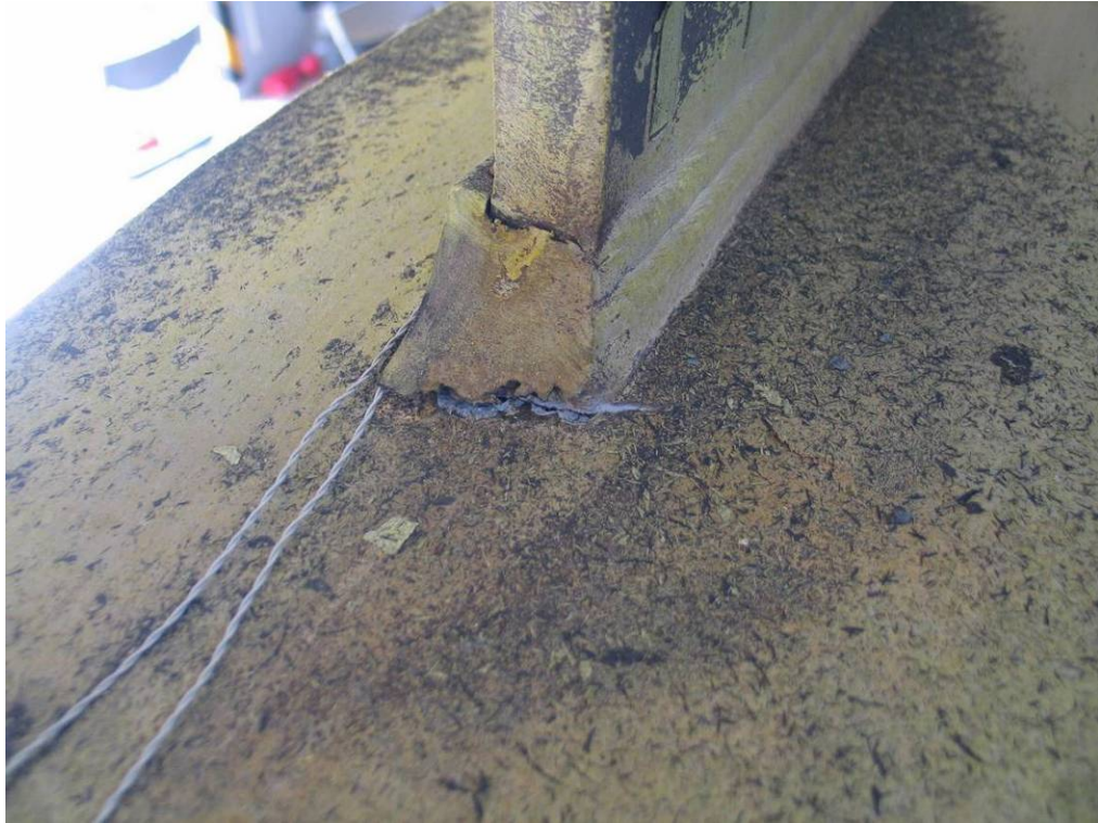
照片 4-43 試體 EE-25 於試驗位移為 85.5mm 時，試體之破壞情況(2) (資料來源：本研究製作)
