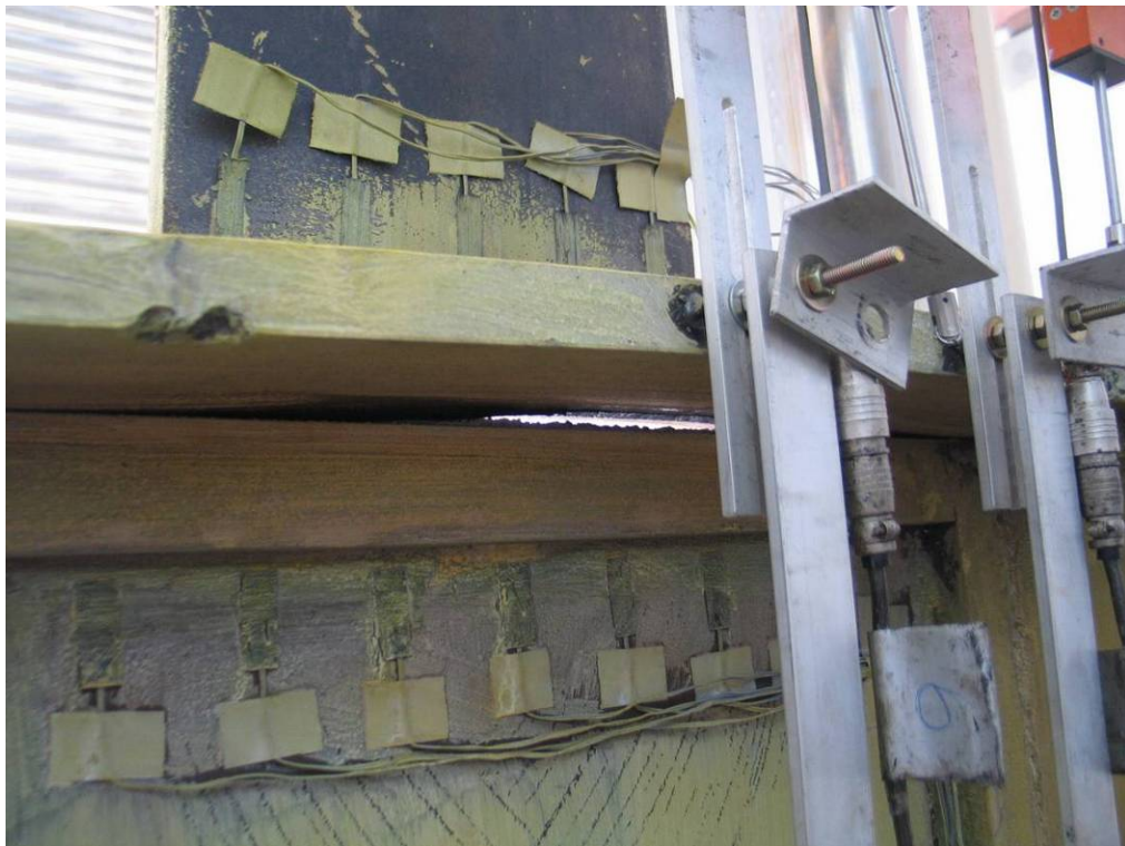
照片 4-42 試體 EE-25 於試驗位移為 85.5mm 時，試體之破壞情況(1) (資料來源：本研究製作)
