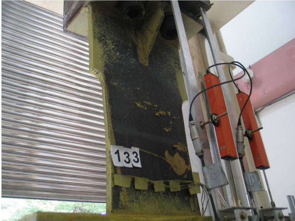
照片 4-35 試體 EE-16 於試驗位移為 133.3mm 時，上翼板之掉漆情況 (資料來源：本研究製作)
