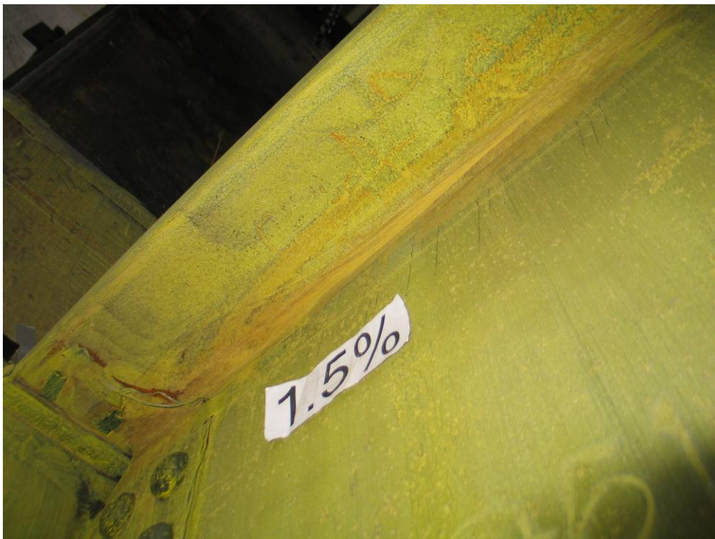
照片 5-10 試體 EE 於尖峰位移角 0.015 弧度時，梁腹板掉漆情況 (資料來源：本研究製作)
