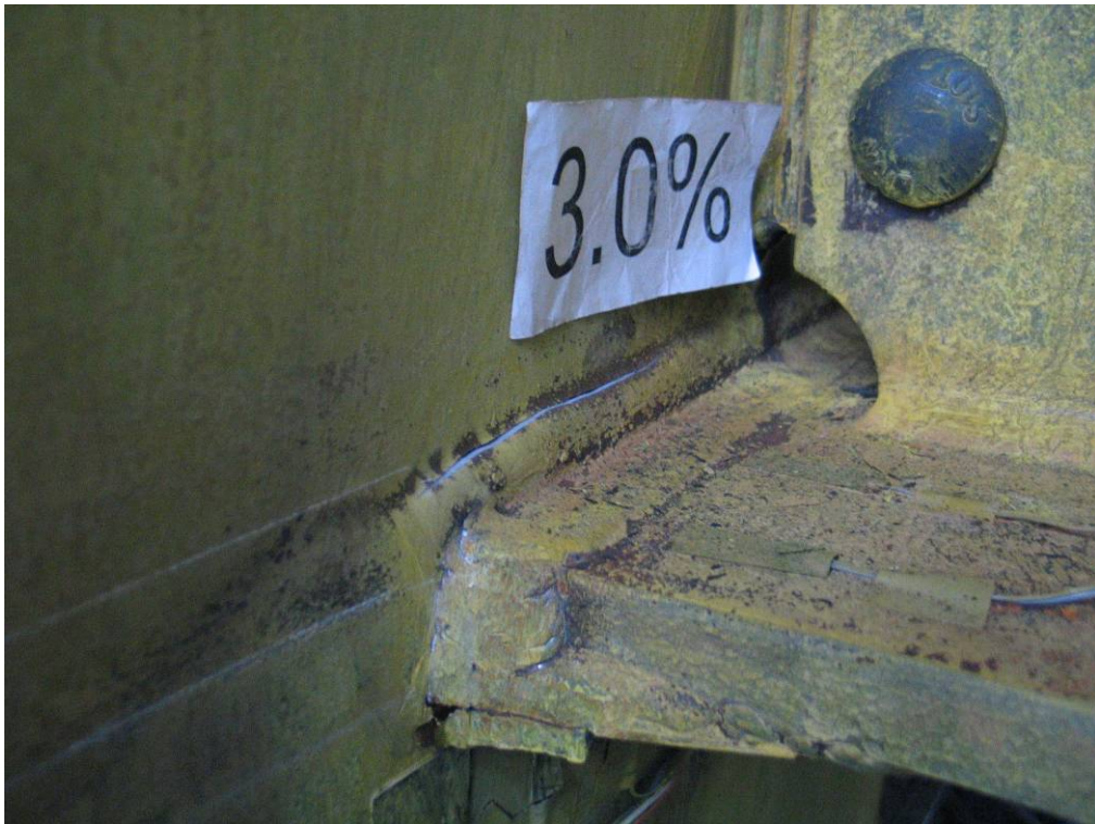
照片 5-11 試體 EE 於尖峰位移角 0.03 弧度時，對應下翼板之柱板受拉拱起情況 (資料來源：本研究製作)
