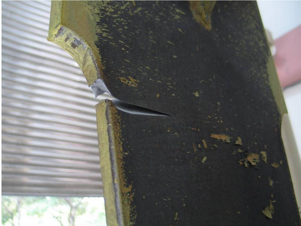
照片 4-37 試體 EE-16 於試驗結束後，上翼板之斷裂情況 (資料來源：本研究製作)
