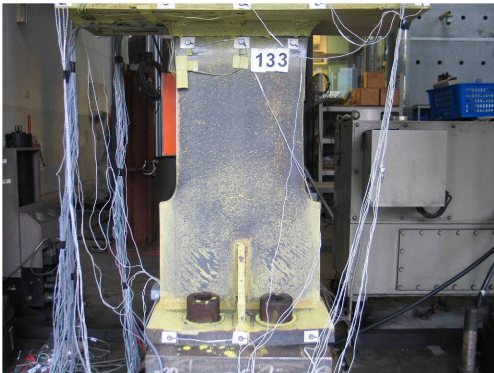
照片 4-36 試體 EE-16 於試驗位移為 133.3mm 時，下翼板之掉漆情況 (資料來源：本研究製作)
