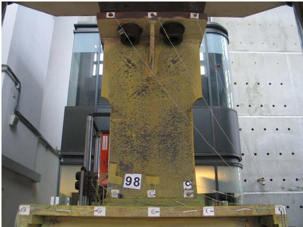
照片 4-18 試體 EE+8 於試驗位移為 97.5mm 時，上翼板之掉漆情況
