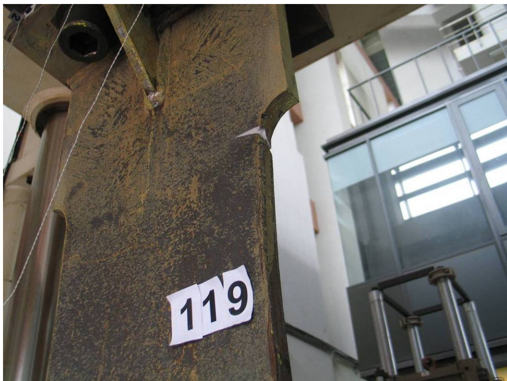
照片 4-16 試體 CE+8 於試驗結束後，上翼板之斷裂情況 (資料來源：本研究製作)
