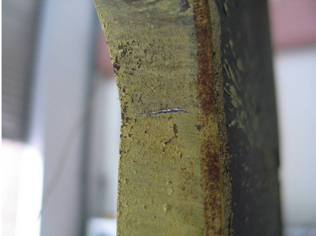
照片 4-17 試體 EE+8 於試驗位移為 97.5mm 時，試體上翼板東側切削圓弧段之開裂情況
