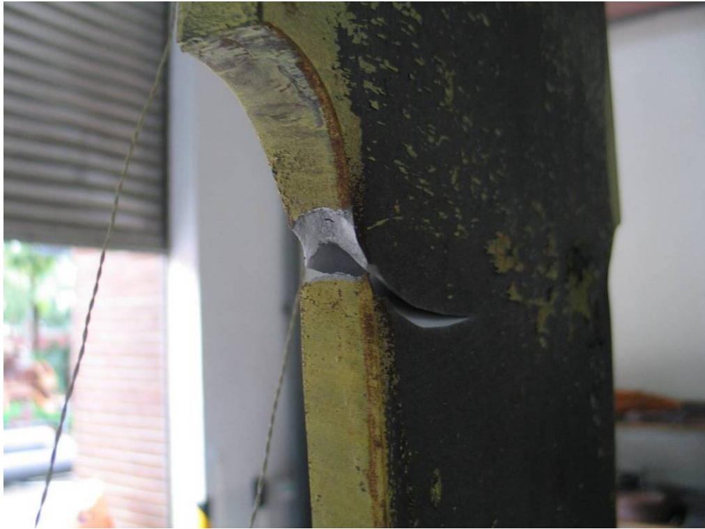
照片 4-21 試體 EE+8 於試驗結束後，上翼板之斷裂情況 (資料來源：本研究製作)
