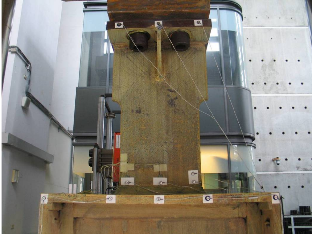
照片 4-29 試體 EE+25 於試驗位移為 32.6mm 時，上翼板之掉漆情況 (資料來源：本研究製作)
