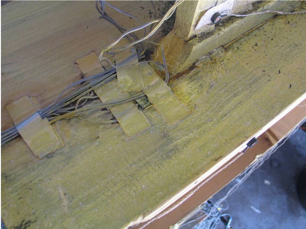
照片 4-41 試體 EE-25 於試驗位移為 62.2mm 時，柱板之掉漆情況 (資料來源：本研究製作)
