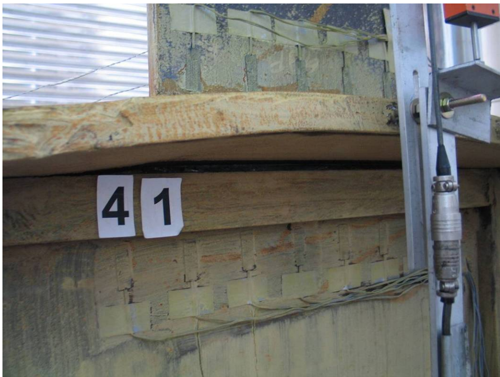
照片 4-32 試體 EE+25 於試驗位移為 40.8mm 時，試體之破壞情況 (資料來源：本研究製作)
