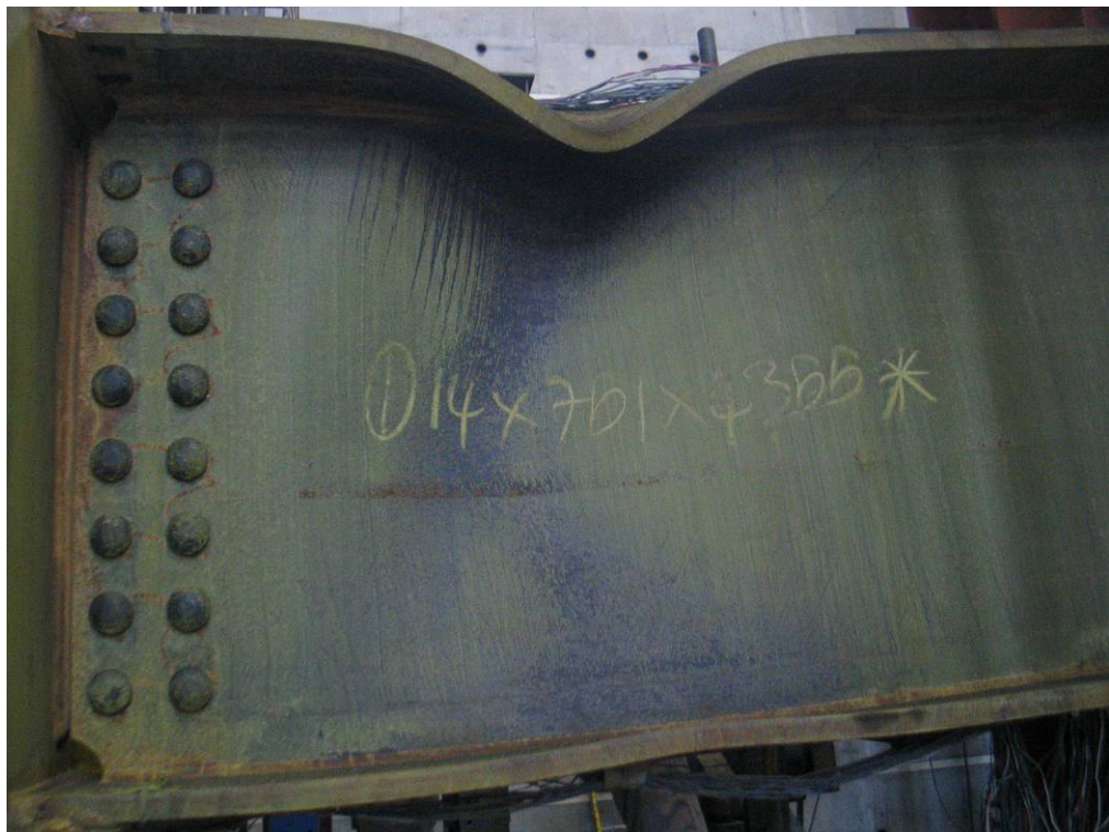
照片 5-6 試體 EC 於尖峰位移角 0.05 弧度時，梁翼板與腹板挫屈情況 (資料來源：本研究製作)
