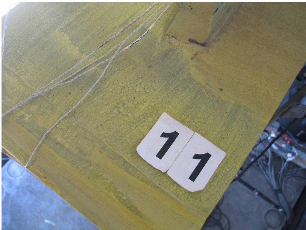
照片 4-22 試體 CE+25 於試驗位移為 10.7mm 時，柱板之掉漆情況 (資料來源：本研究製作)
