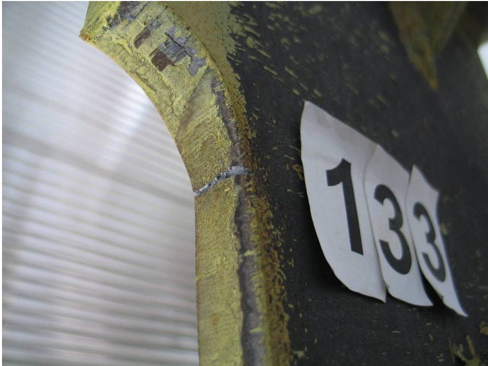
照片 4-33 試體 EE-16 於試驗位移為 133.3mm 時，上翼板切削段圓弧處開始有輕微開裂現象
