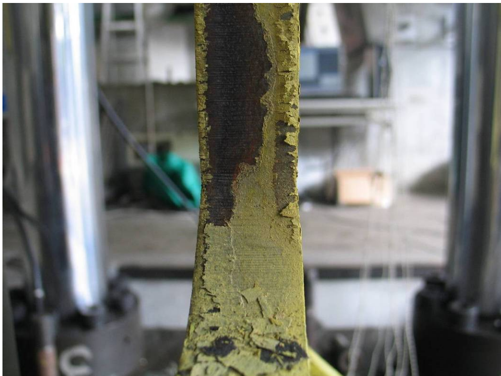
照片 4-8 試體 EC 於試驗位移為 71.9mm 時，翼板切削段圓弧處於厚度方向發生內縮情況 (資料來源：本研究製作)
