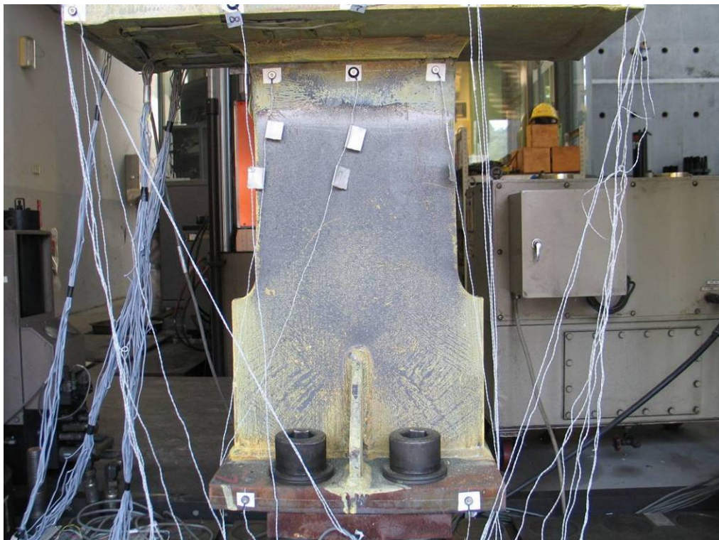
照片 4-6 試體 CC 於試驗位移為 75.8mm 時，下翼板之掉漆情況 (資料來源：本研究製作)
