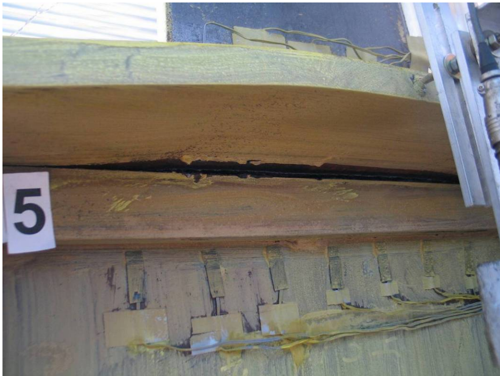
照片 4-26 試體 CE+25 於試驗位移為 63.3mm 時，試體之破壞情況 (資料來源：本研究製作)
