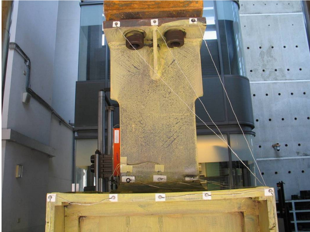
照片 4-23 試體 CE+25 於試驗位移為 55.8mm 時，上翼板之掉漆情況 (資料來源：本研究製作)
