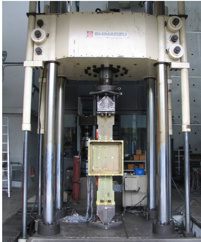
照片 4-1 ESW 元件試體試驗於 500 噸萬能試驗機之情況 (資料來源：本研究製作)
