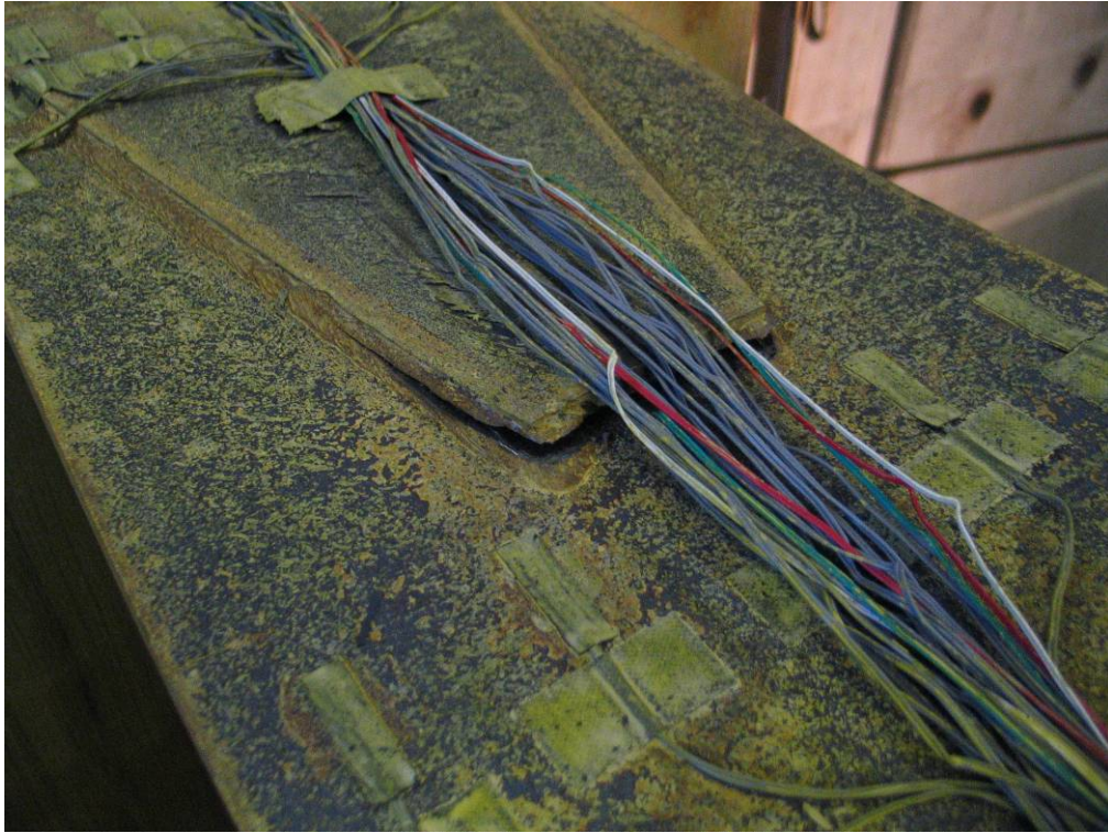
照片 5-7 試體 EC 於尖峰位移角 0.05 弧度時，蓋板銲道開裂情況 (資料來源：本研究製作)
