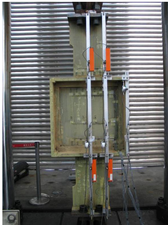
照片 4-2 ESW 元件試體之位移計安裝位置 (資料來源：本研究製作)
