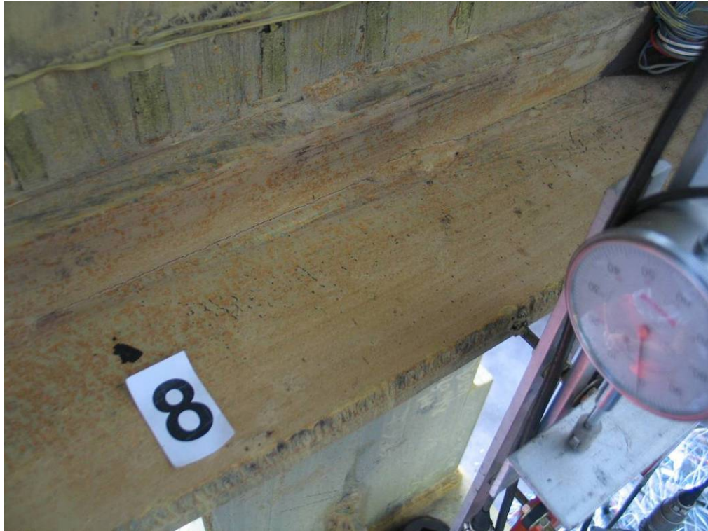
照片 4-27 試體 EE+25 於試驗位移為 8.4mm 時，柱板之掉漆情況 (資料來源：本研究製作)
