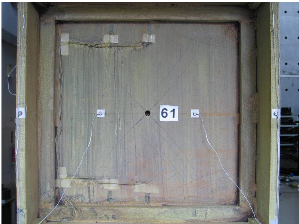
照片 4-14 試體 CE+8 於試驗位移為 60.8mm 時，柱內隔板之掉漆情況 (資料來源：本研究製作)
