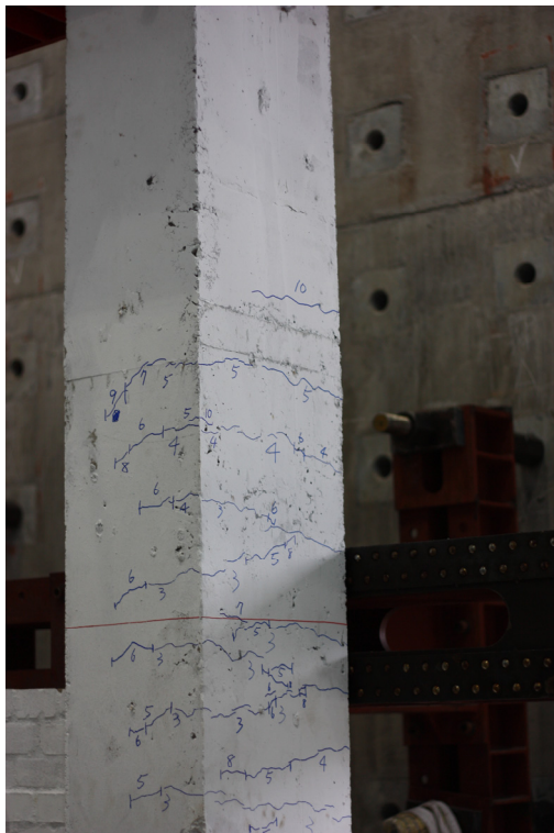
圖 5-4 試體 S1 於位移達 38.125mm 時柱之受力集中於牆頂高度附近 (資料來源：本研究製作)
