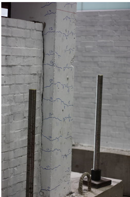
圖 5-5 試體 S1 於位移達 45.75mm 時構架內側柱身開始生成拉力裂縫 (資料來源：本研究製作)
