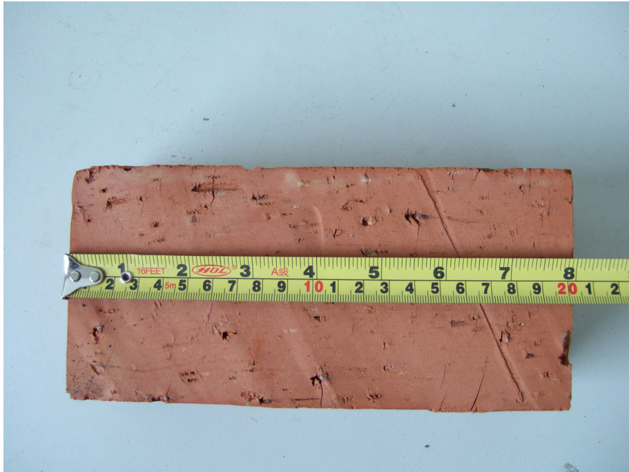
圖 3-7 本研究所使用之紅磚尺寸示意圖
