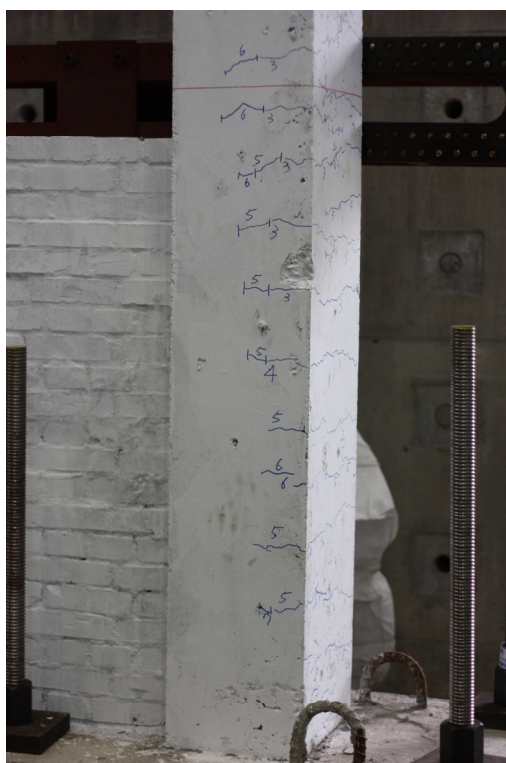
圖 5-2 試體 S1 於小位移時僅有撓曲裂縫產生 (資料來源：本研究製作)
