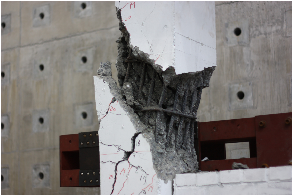
圖 5-8 試體 S1 於位移達 91.5mm 時塑鉸區之混凝土崩壞 (資料來源：本研究製作)
