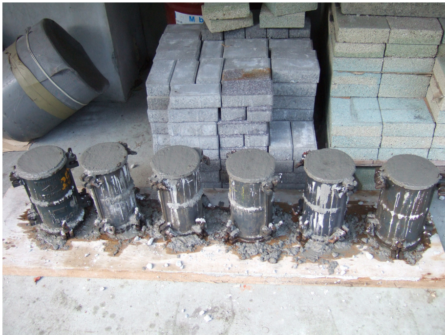
圖 3-20 混凝土標準圓柱試體製作
