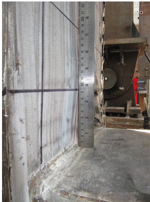
圖 3-8 R40-40 試體在側移角 1.5%時局部挫屈
