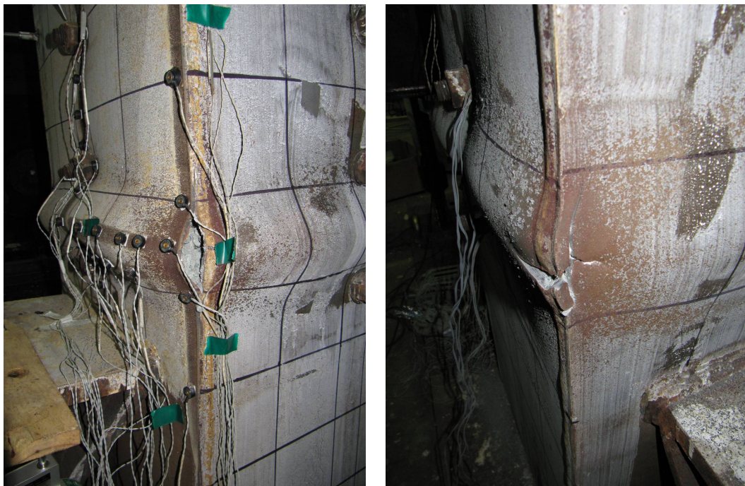
(a) 撓曲壓應力側縱向開裂 (b) 撓曲拉應力側橫、縱向開裂 圖 3-13 T48-40-M 試體在側移角 6% 時受壓縱裂、受拉橫裂
