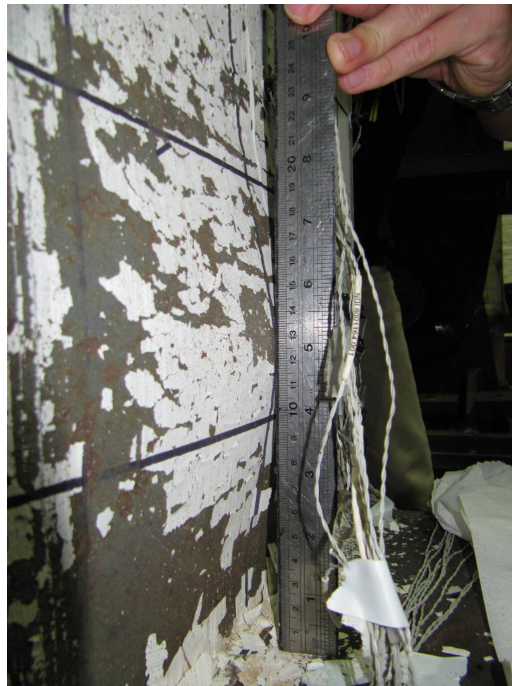
圖 3-6 R40-20 試體在側移角 3%時局部挫屈
