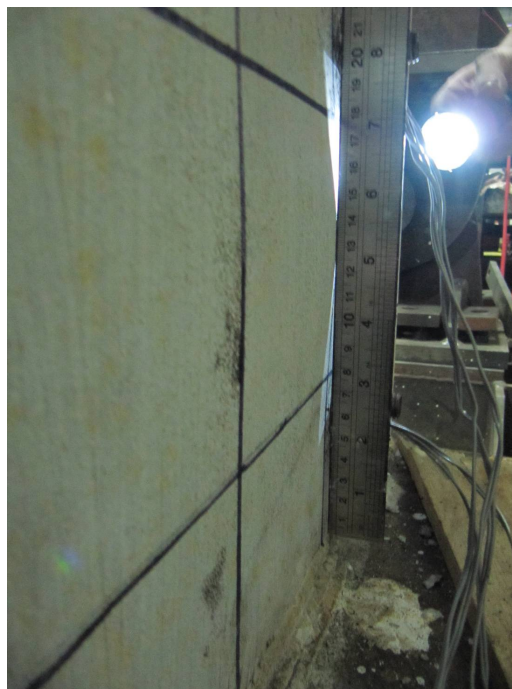
圖 3-15 T48-40-L 試體在側移角 1.5%時局部挫屈
