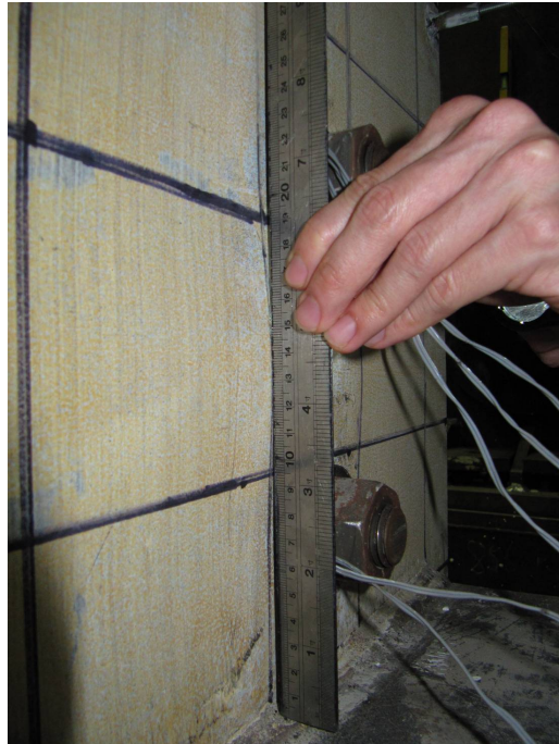
圖 3-18 T40-40-H 試體在側移角 2%時局部挫屈
