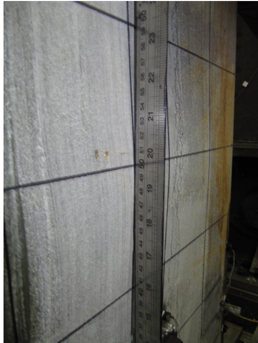
圖 3-12 T48-40-M 試體在側移角 1% 時局部挫屈
